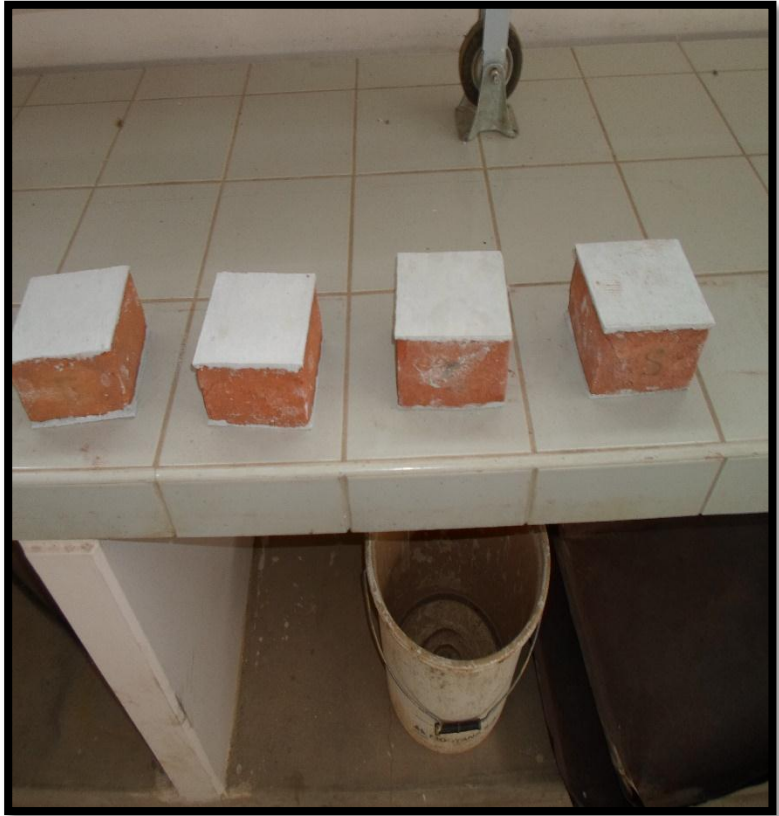
Foto N°16. Se observa en la imagen las unidades de albañilería
