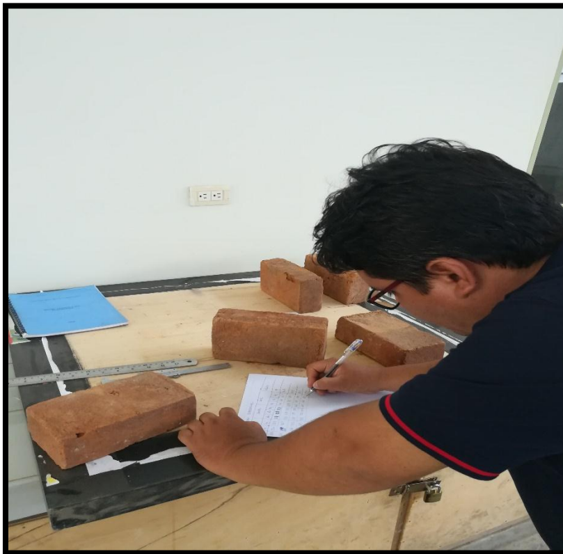
Foto N°04. Se aprecia la obtención de las medidas de las unidades de Albañilería.
