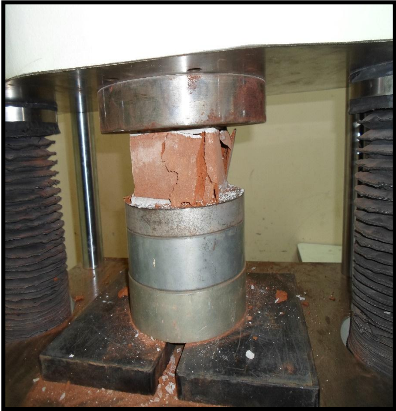
Foto N°20. Se aprecia a la unidad de albañilería en el instante en que falla debido a la carga ultima en el ensayo de resistencia.
