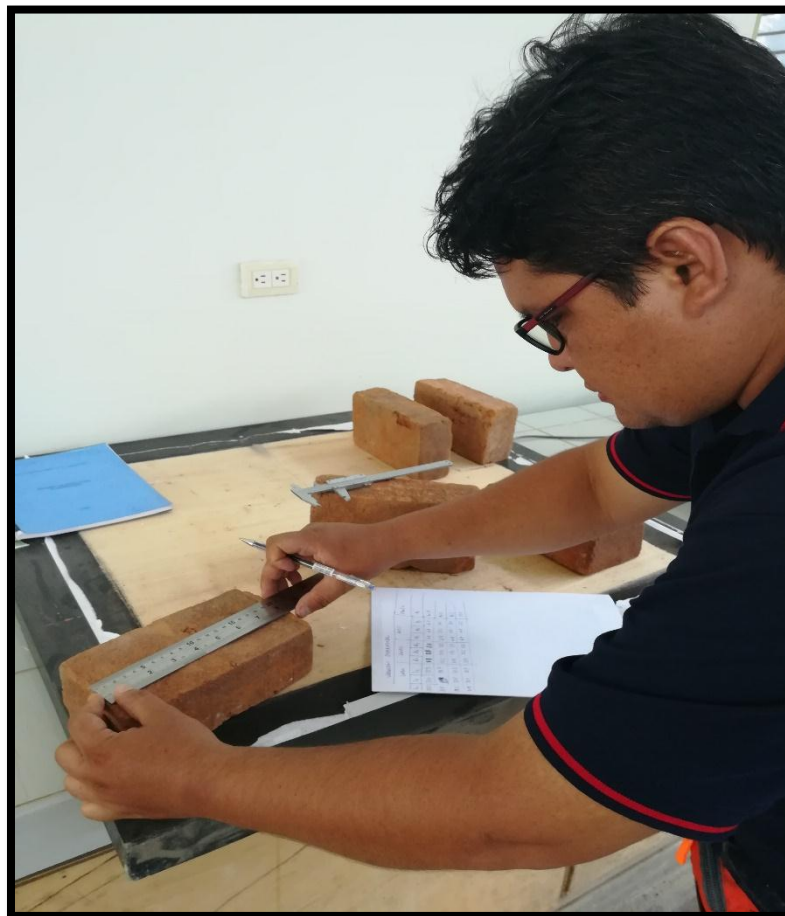
Foto N°02. Se muestra en la imagen la medición de las unidades de albañilería.
