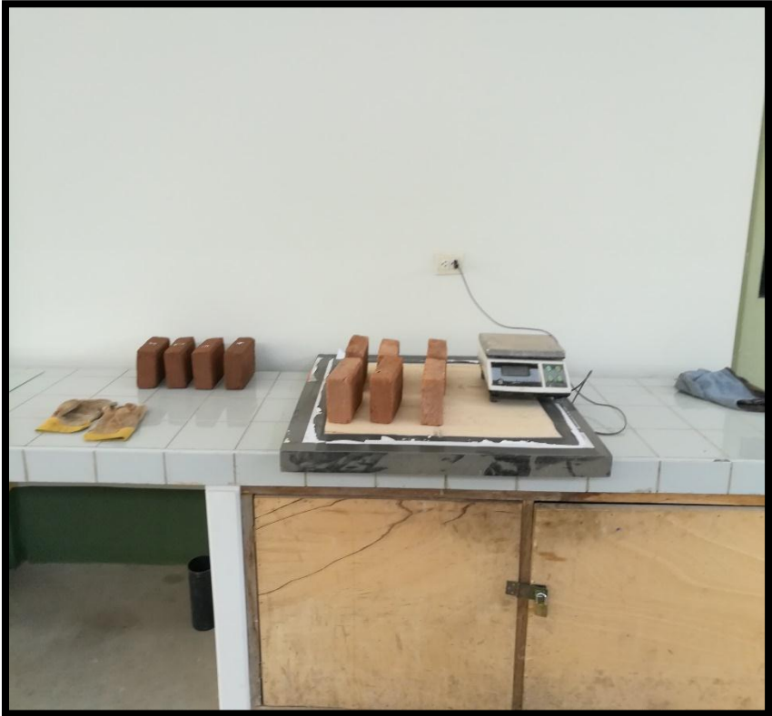
Foto N°09. Se aprecia las unidades de albañilería y la balanza digital.
