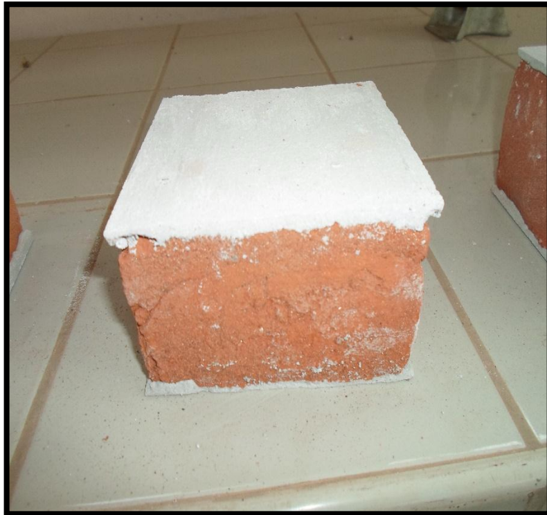
Foto N°17. Vista de la unidad de albañilería con el caping para el ensayo de resistencia a la compresión.
