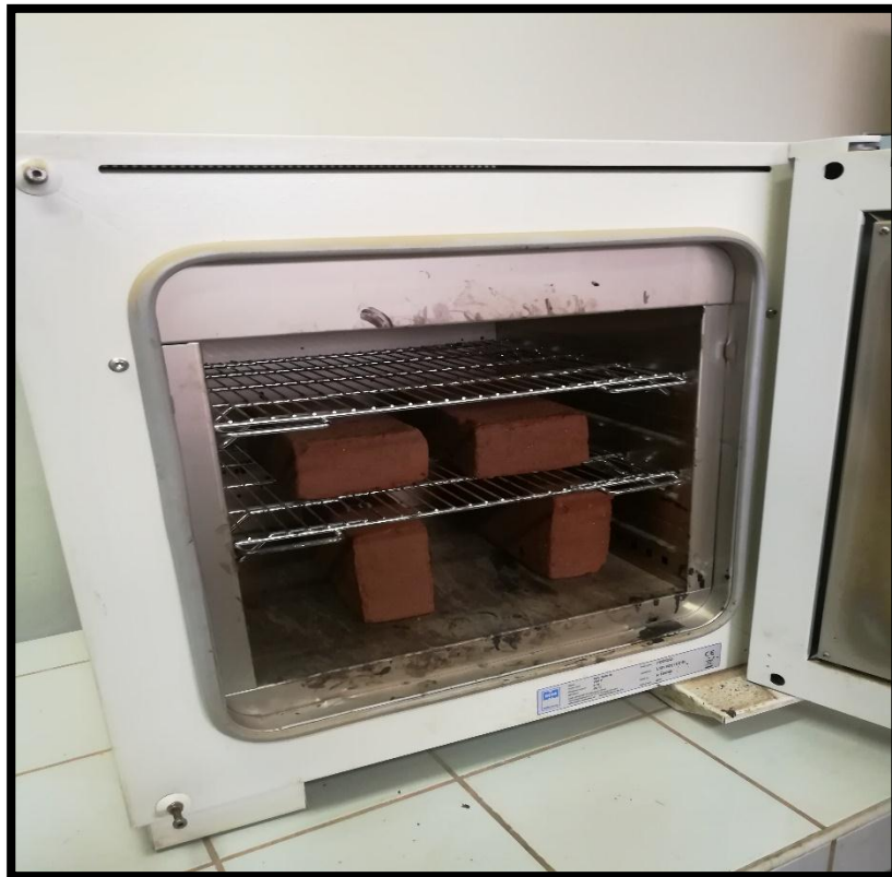
Foto N°11. Se muestra en la imagen la colocación de las unidades de Albañilería en el horno de secado.
