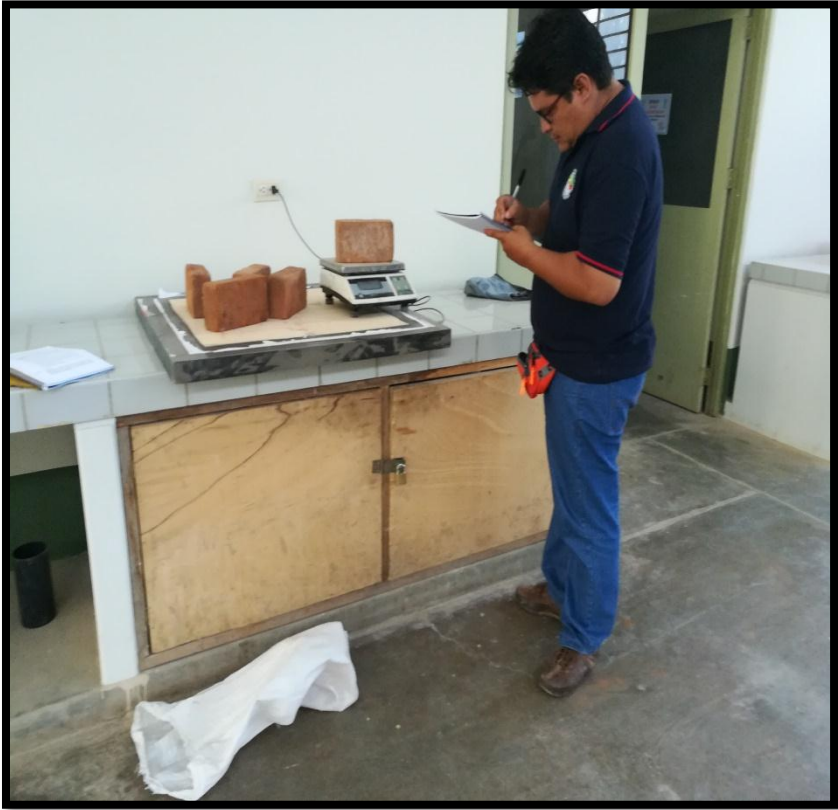
Foto N°10. Toma de datos de los pesos de las unidades de albañilería.
