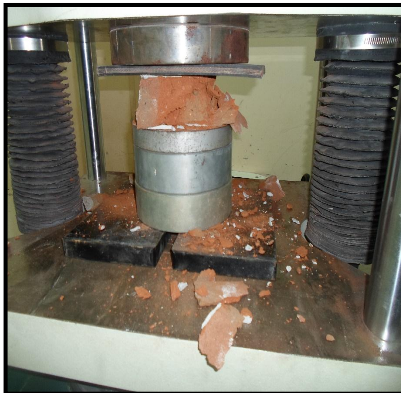
Foto N°22. Vista de otra unidad de albañilería fracturada debido a la Carga ultima a la cual fue sometida para el ensayo de Resistencia a la compresión.
