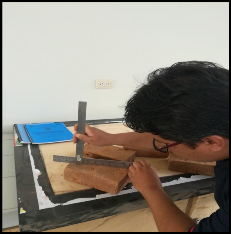
Foto N°15. Vista auxiliar del ensayo de alabeo en las unidades de Albañilería.
