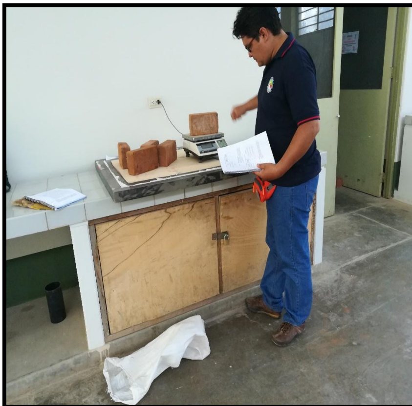
Foto N°08. Se muestra la medición de los pesos de las unidades de Albañilería.
