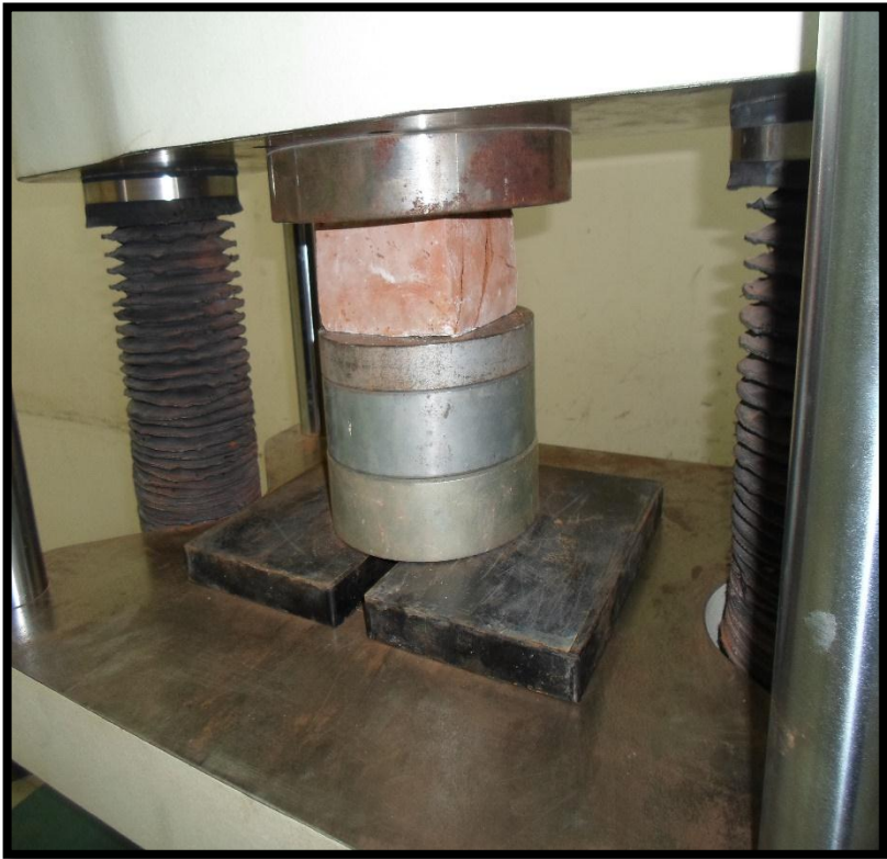
Foto N°19. Vista de la unidad de albañilería siendo sometida a carga.
