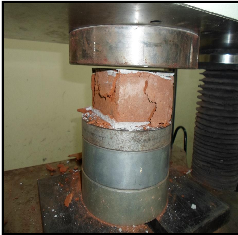
Foto N°21. Imagen de una unidad de albañilería fracturada debido a la carga a la cual fue sometida.
