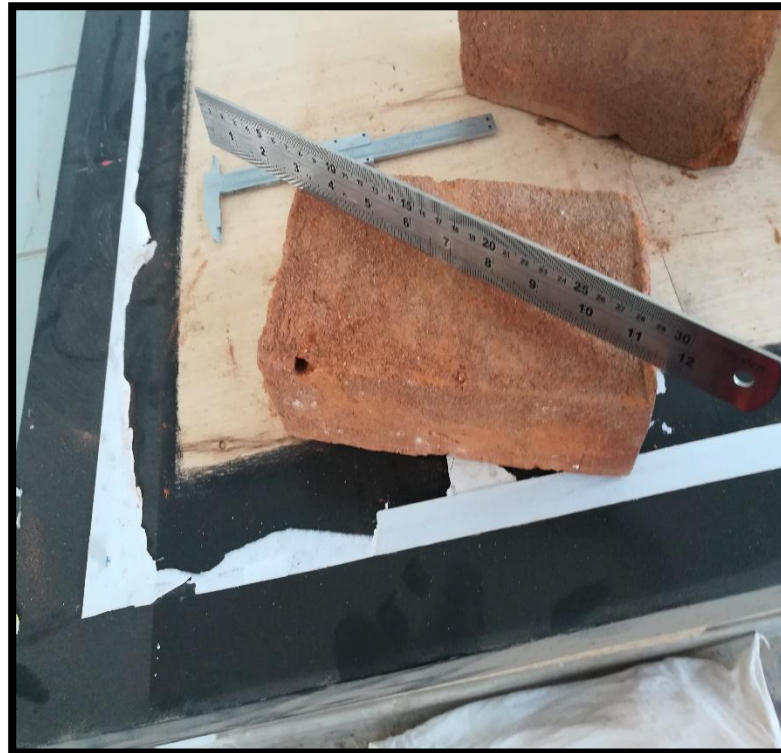
Foto N°13. Imagen del ensayo de alabeo en las unidades de Albañilería.
