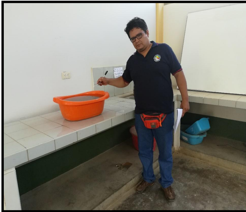
Foto N°07. La imagen muestra la verificación de las unidades de albañilería Sumergidas en agua.
