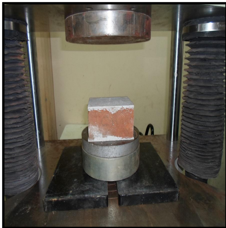
Foto N°18. Imagen de la unidad de albañilería antes de ser sometida a carga.
