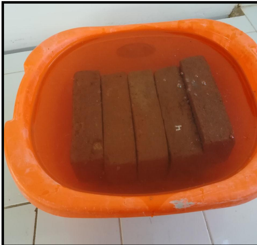
Foto N°06. Se muestran las unidades de albañilería sumergidas en agua.
