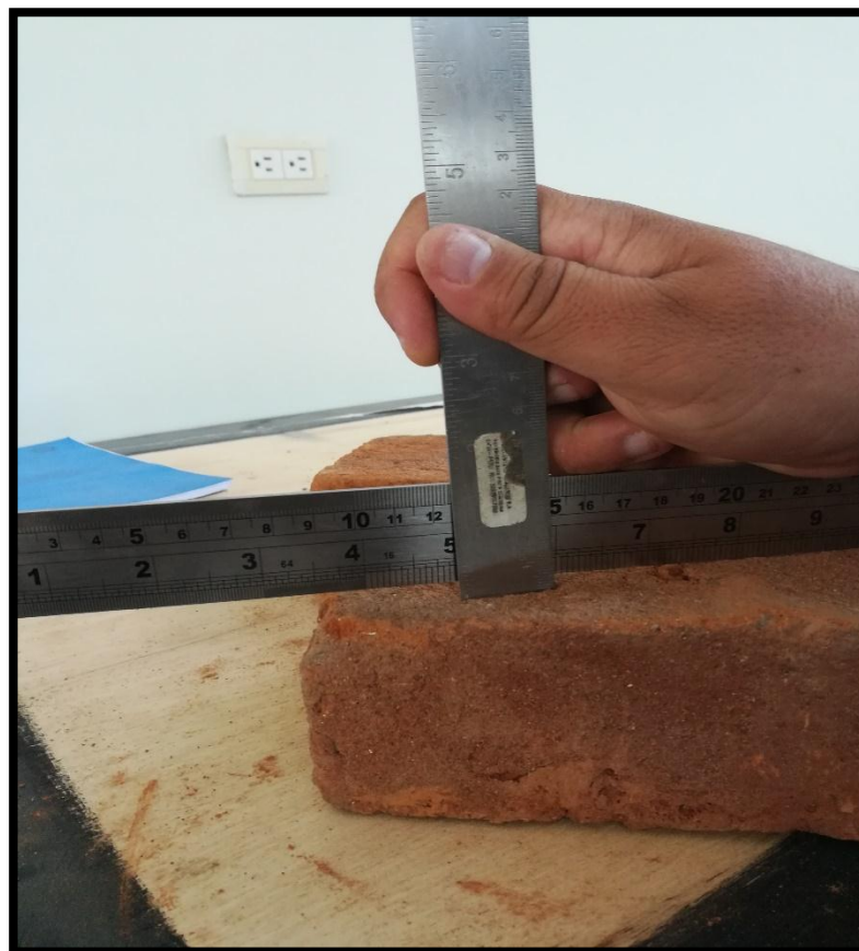
Foto N°14. Imagen de la toma de medidas para el ensayo de alabeo.
