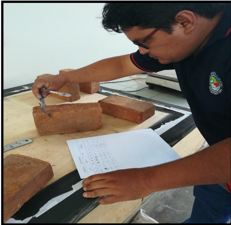
Foto N°03. Se aprecia la medición de las longitudes de la unidad de albañilería.
