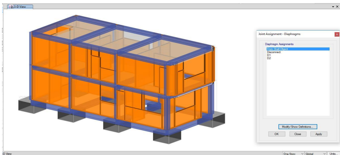
Figura N° 11: Vista de la introducción de los diafragmas rígidos estructura en el programa ETABS 2016
