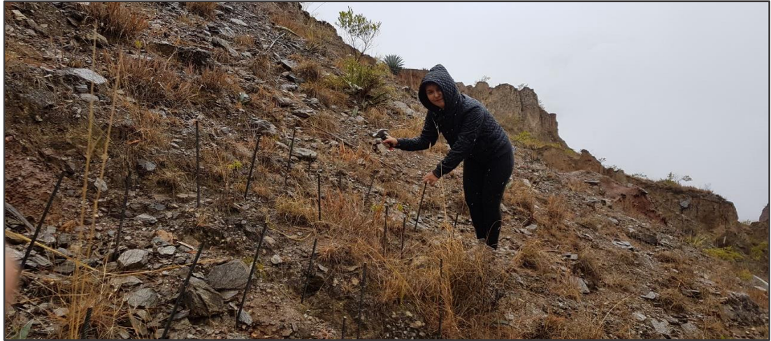
Ilustración 24. Medición de las microparcels y colocación de las varillas de erosión.
