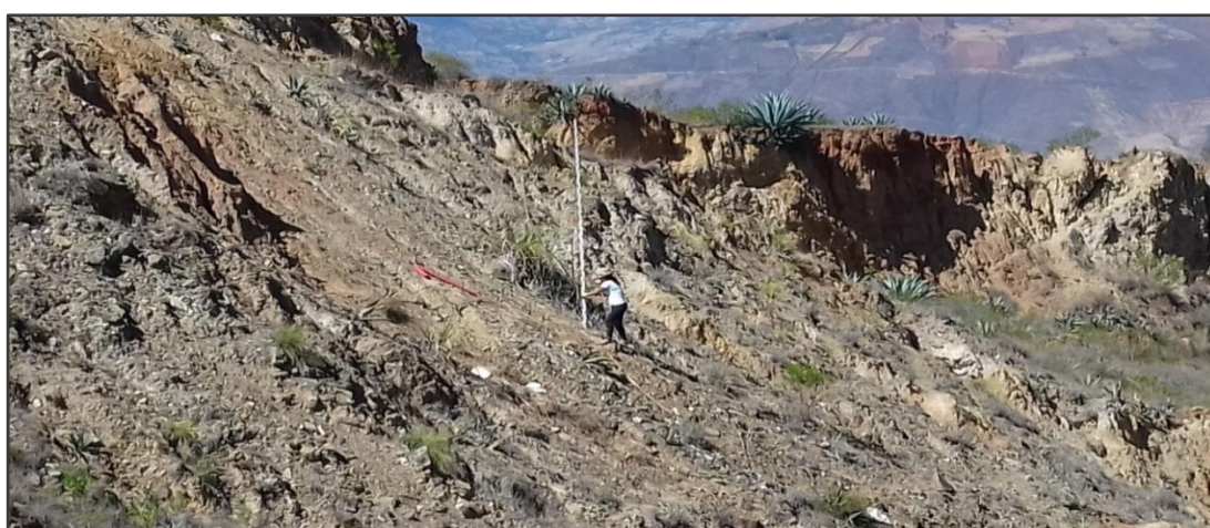
Ilustración 20. Determinación de la pendiente con el uso del nivel topografico.
