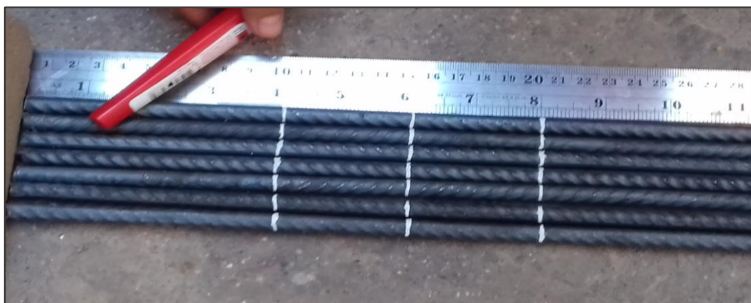
Ilustración 18. Demarcación de las varillas de hierro de 50 cm de longitud.
