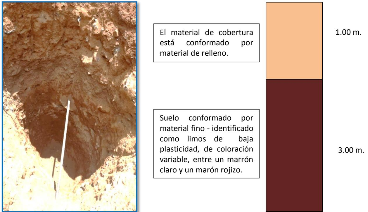
FIGURA 17: PERFIL ESTATIGRÁFICO DE C-01
