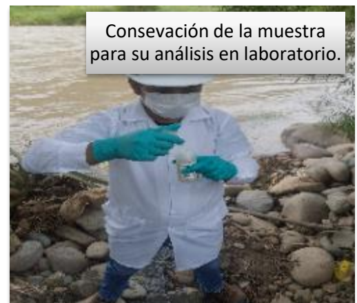
Toma de muestra en el efluente de la laguna facultativa, para su análisis en laboratorio.
