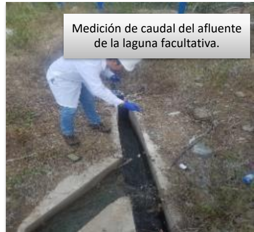
Medición de caudal del afluente de la laguna facultativa.
