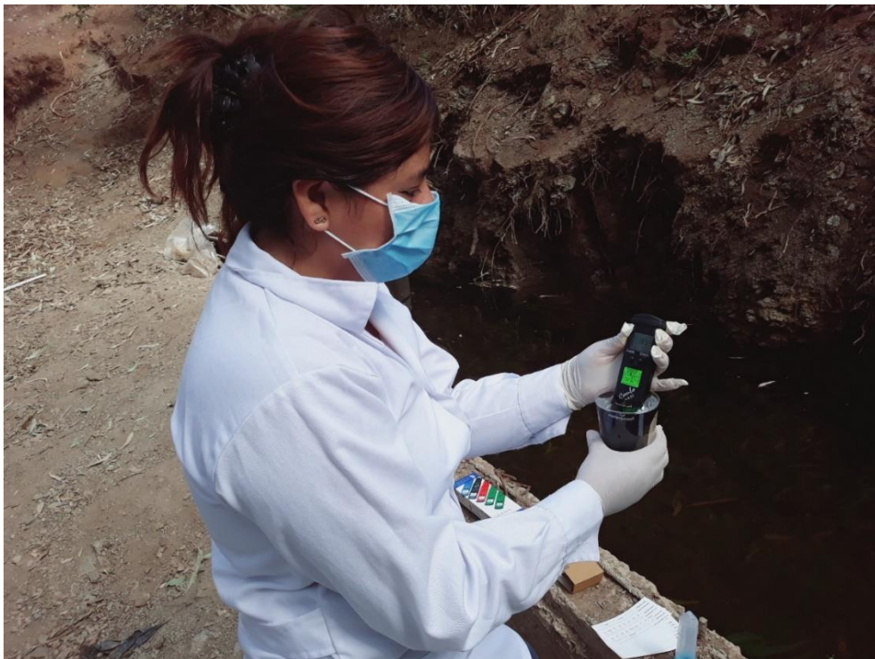
Gráfico 21: Determinación de los parámetros en campo (pH, T, Conductividad, solidos totales disueltos) del manantial de Pacán
