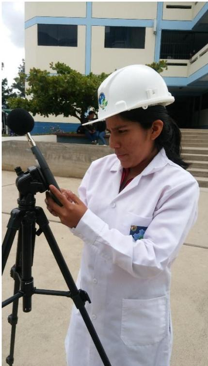
**Fotografía 5:** Preparando el sonómetro para el monitoreo.
