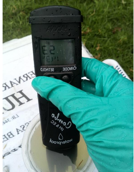
Fotografía 17. Medición de los parámetros de campo (pH, temperatura, sólidos totales disueltos y conductividad).
