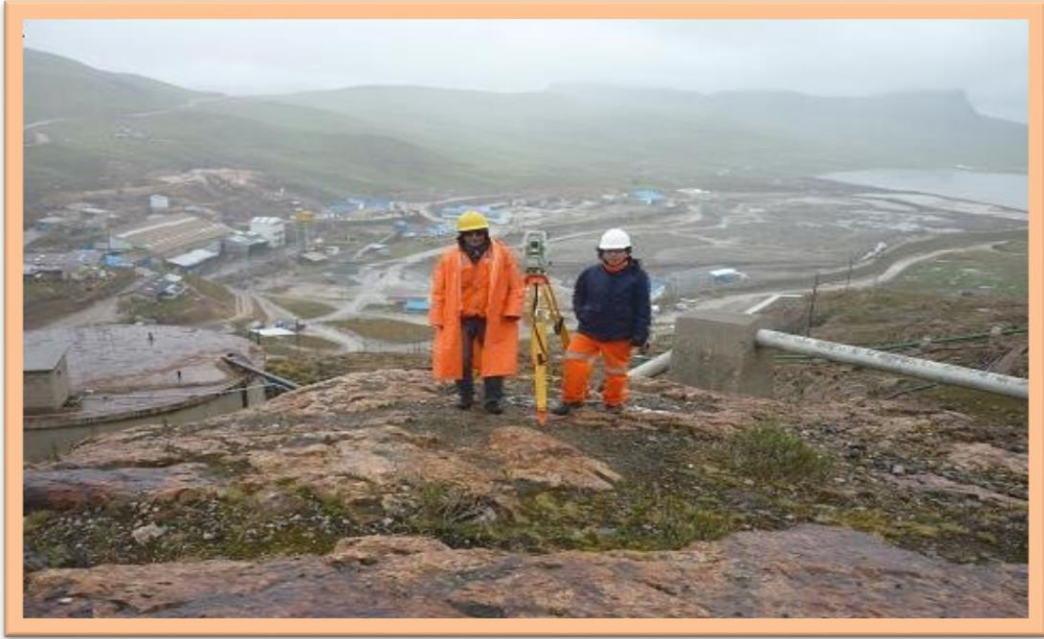
IMAGEN 22. Año 2013, Levantamiento topográfico para proyecto: mejoramiento del sistema de agua para la planta concentradora. de la compañía Minera Harón - Huayllay Pasco
