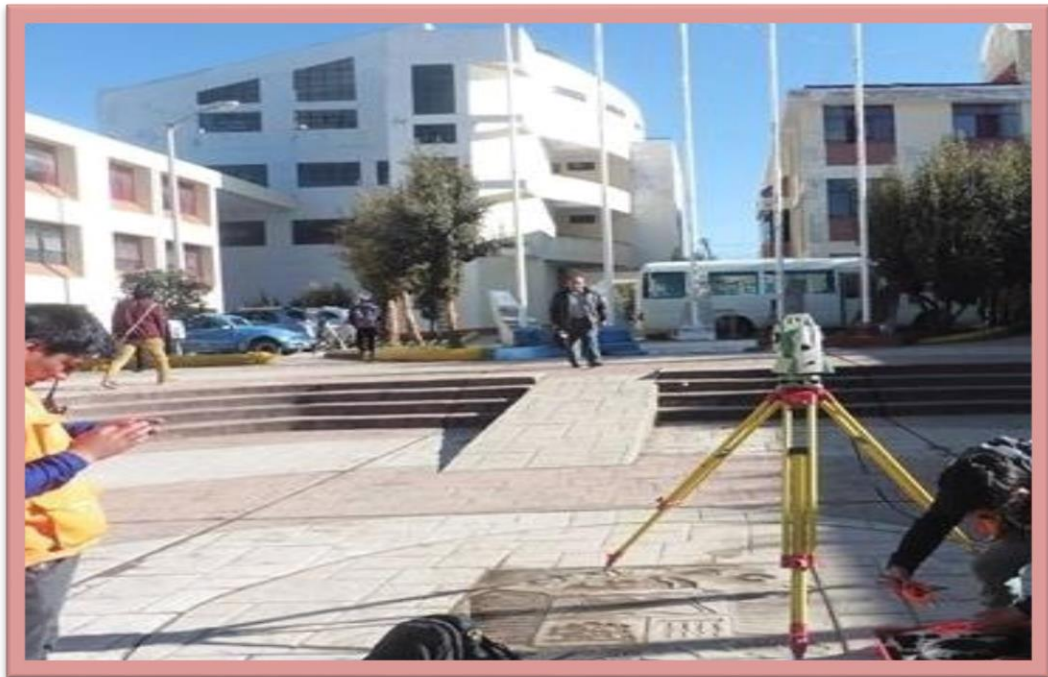
IMAGEN 28. Año 2016, Levantamiento topográfico para proyecto: mejoramiento del sistema de electrificación de La Universidad Nacional Daniel Alcides Carrión-Pasco
