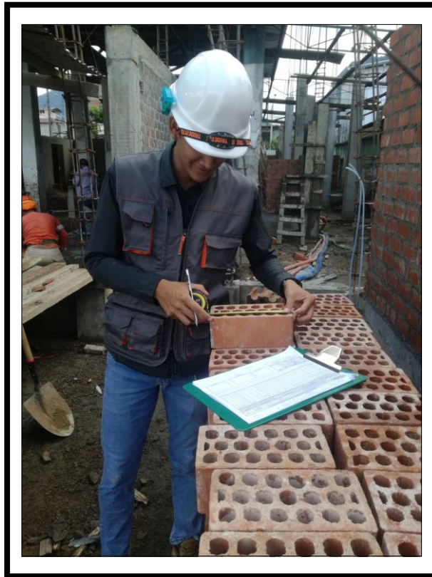
FOTOGRAFIA N° 11: Se puede observar en la fotografía tomando las dimensiones de la unidad de albañilería King Kong 18H.
