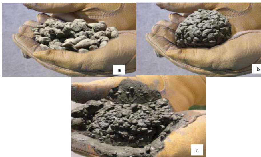
Gráfico 3: Muestras de concreto permeable con diferentes cantidades de agua: (a) con poca agua, (b) adecuada cantidad de agua, (c) con demasiada agua.
