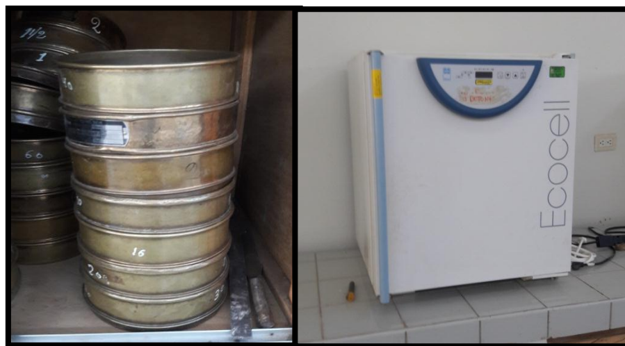
Gráfico 8: Tamices para realizar el análisis granulométrico y horno.
