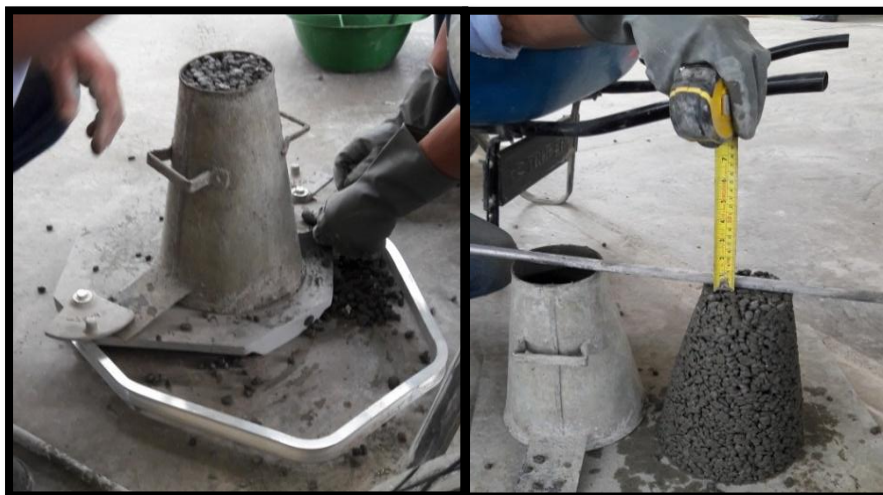
ANEXO 6: Ensayo de consistencia del concreto permeable.
