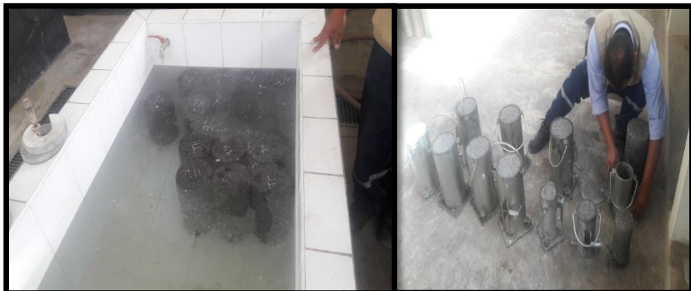
ANEXO 9: Desmoldado y curado de las probetas.
