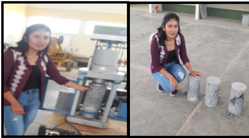
ANEXO 12: Ensayo de resistencia a la compresión
