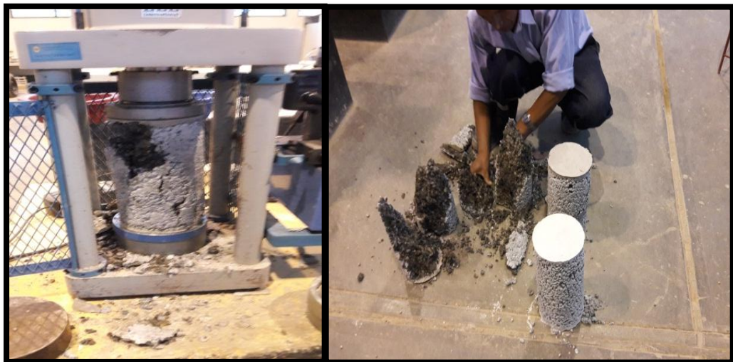
Anexo 14: Probetas ensayadas a la resistencia de compresión.
