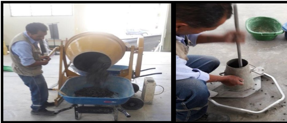
ANEXO 5: Vertido de mezcla en la carretilla.
