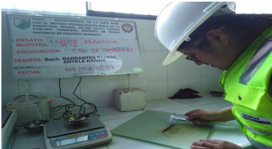
Figura 35. Límite Plástico de la Muestra 02
