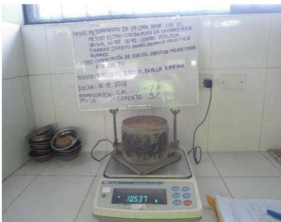
SE PESA LA MUESTRA QUE ESTA EN EL MOLDE
