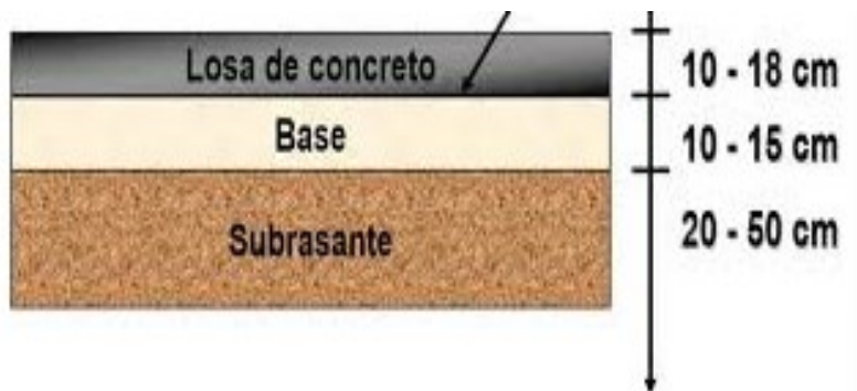
Figura 2. Estructura de Pavimento Rígido
