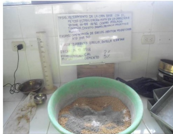
SE MEZCLA CAL Y CEMENTO CON LAS PROPORCIONES DE LAS MUESTRAS
