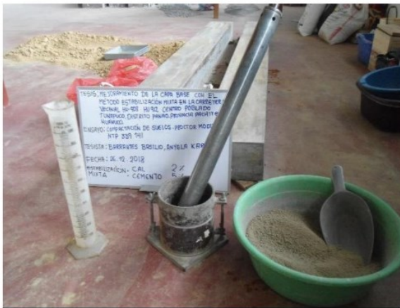
SE ADICIONA AGUA EN LA MEZCLA HASTA OBTENER UNA CONSISTENCIA
