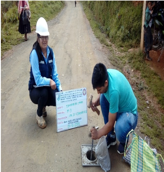
Figura 74 Se hace un orificio de 10cm.
