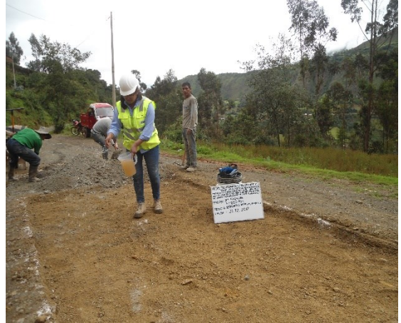
Figura 13. Comprobación que el 60% de la mezcla pasa la malla N°4
