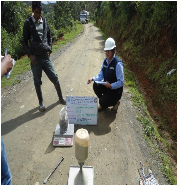
Figura 72 Se coloca el envase y se deja llenar el orificio
