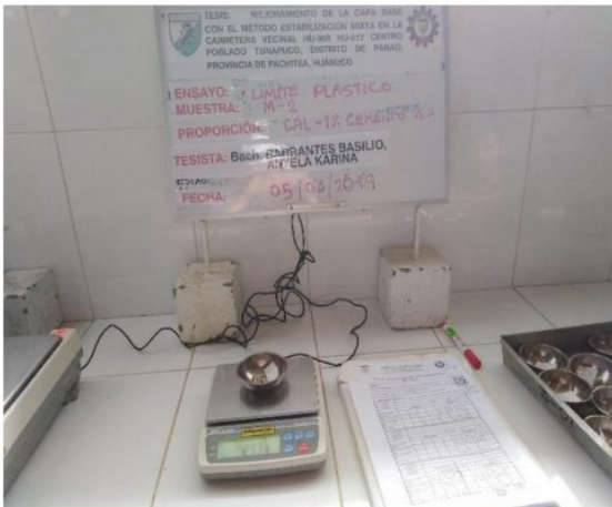
UNA VEZ SECO Y FRIO SE VUELVE A PESAR LAS MUESTRAS
