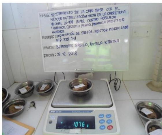
SE VUELVE A PESAR LA MUESTRA SECA
