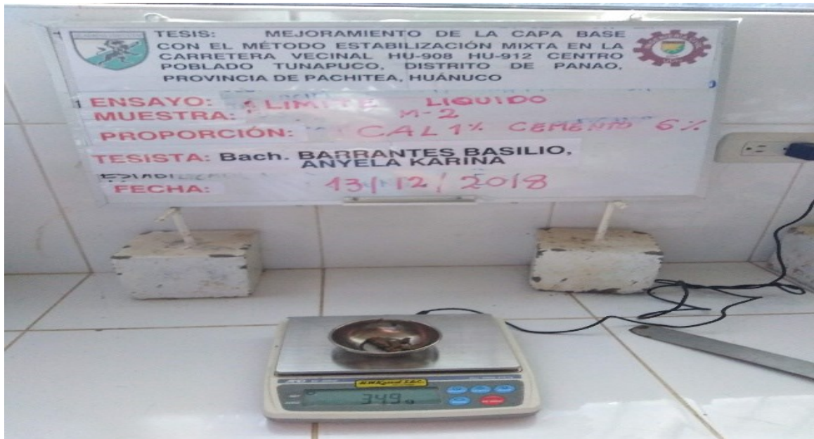
Figura 34. Límite Líquido de la Muestra 02
