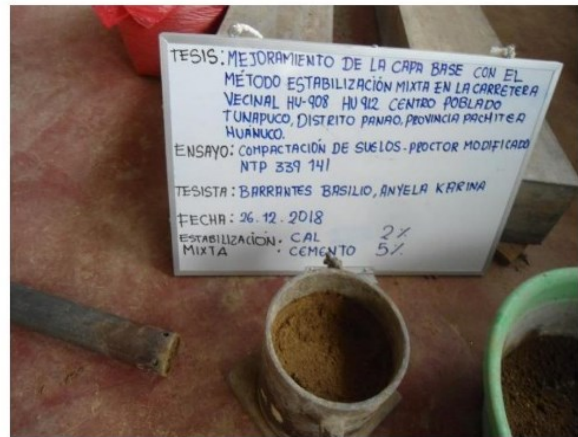
SE HECHA LA MEZCLA AL MOLDE Y COMPACTAMOS CON EL PISON
