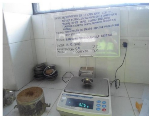
SE SACA UNA MUESTRA DE LA PARTE SUPERIOR DEL MOLDE
