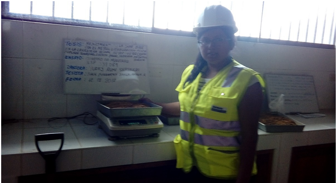
Figura 33. Peso de la Muestra Húmeda Inicial
