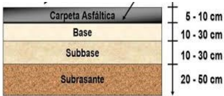
Figura 1. Estructura de Pavimento Flexible
