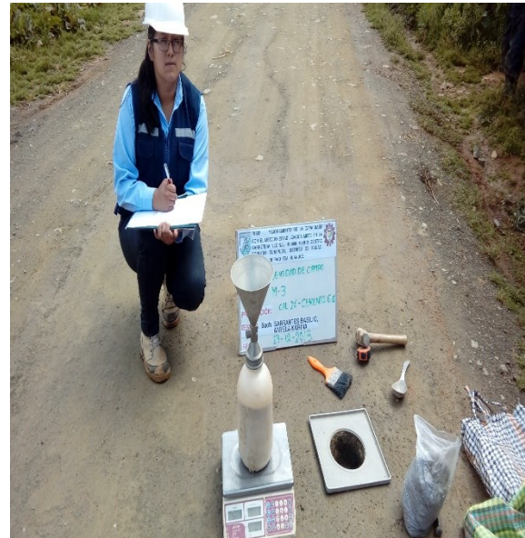
Figura 75 Se pesa el envase con la arena antes de ser echada al orificio.
