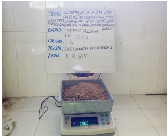
PESO DE LA MUESTRA HUMEDA
