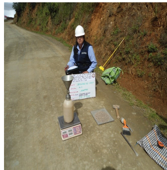
Figura 69 Se vuelve a pesar la arena sobrante en el envase
