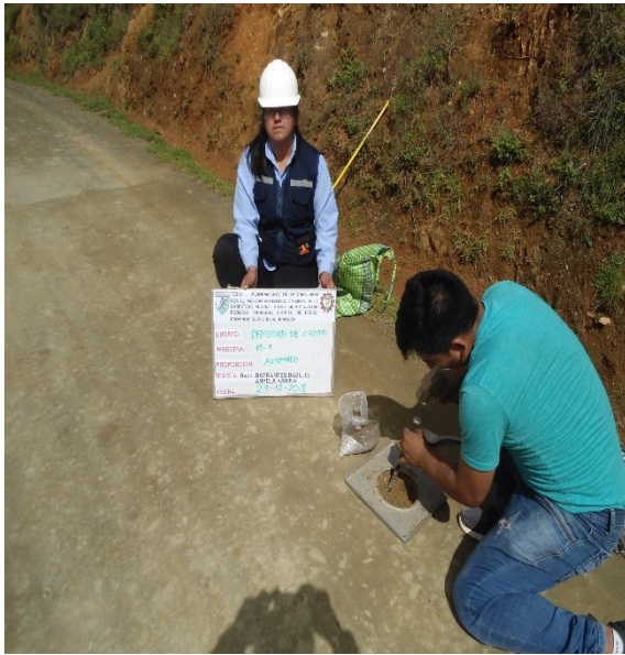
Figura 66 Se hace un orificio de 10cm
