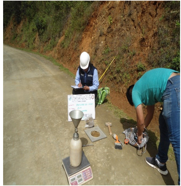
Figura 67 Peso de la arena antes de ser llevada al orificio
