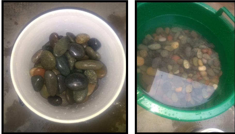
Figura 35: Lavado de las piedras y gravas – experimentación
