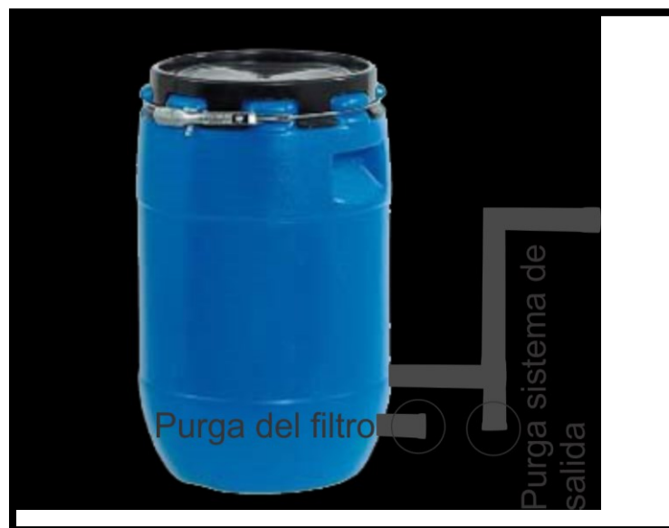
Figura 15: Sistemas de purga para todo el filtro purificador con material seleccionado (elaboración propia)
