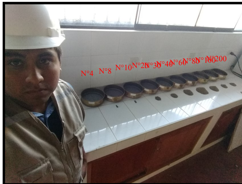
Figura 22: Mallas ordenadas en forma decreciente desde la N°4 hasta la N°200 se aprecia que en la mala N°60 retuvo la mayor cantidad de material (Muestra 3)
