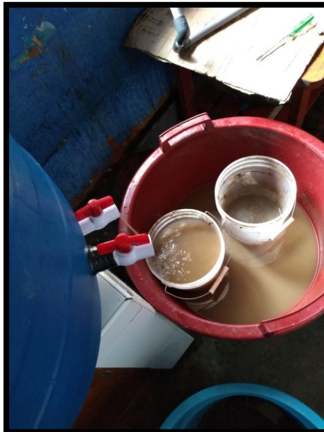
Figura 51: Purgamos el sistema antes de conectarlo al tanque de almacenamiento – experimentación
