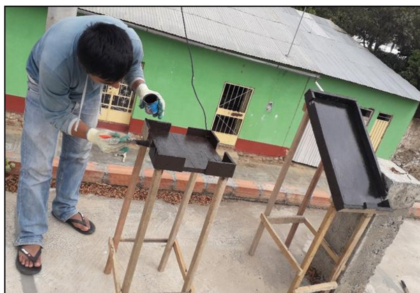
IMAGEN N°6. Construcción de concentrador solar
