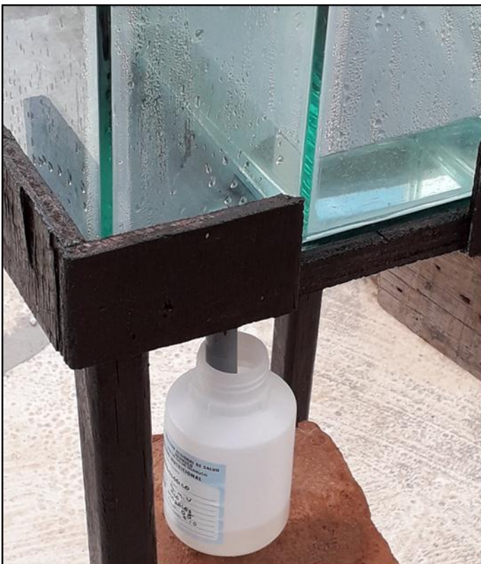
IMAGEN N°13. Recolección del agua condensada del destilador solar
