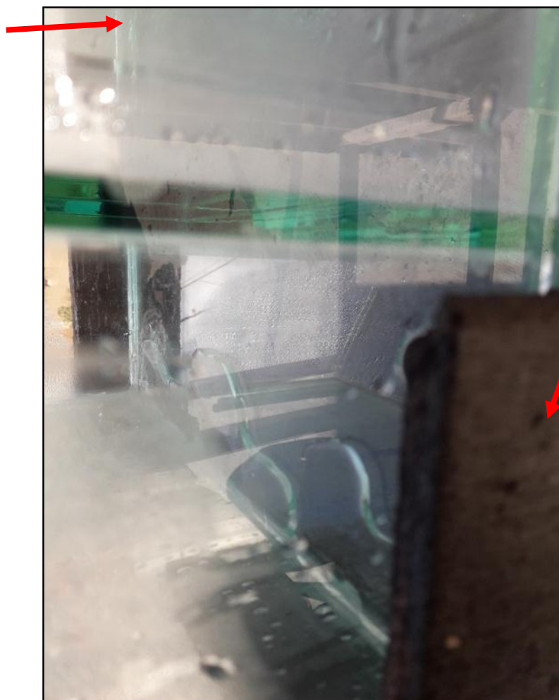
IMAGEN N°12. condensación del agua dentro del destilador solar
