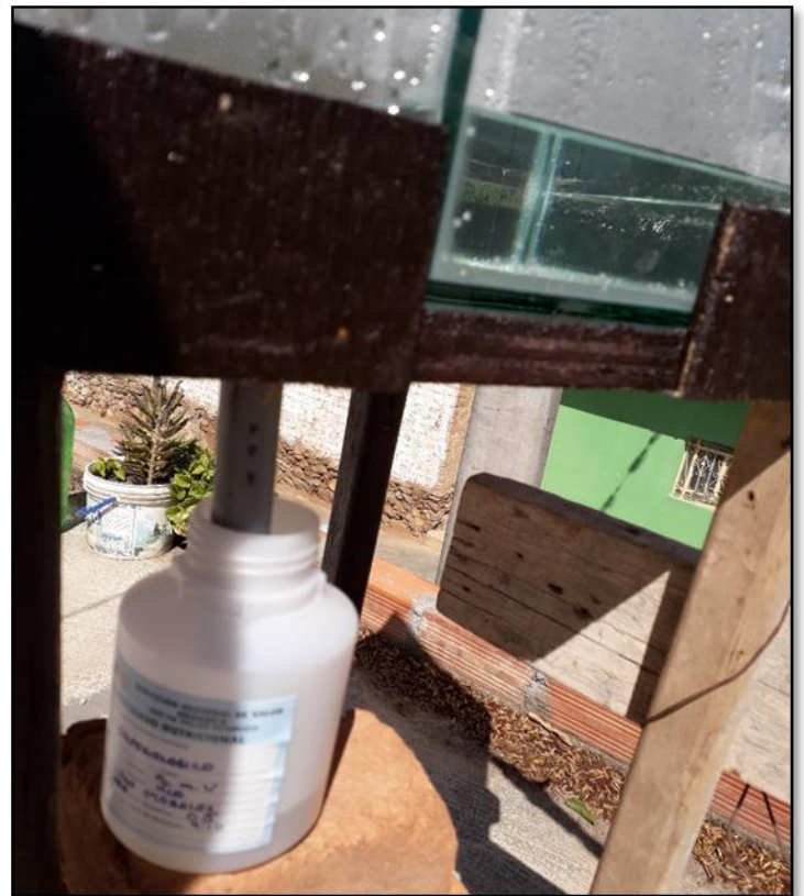
IMAGEN N°14. Recolección del agua condensada del destilador solar
