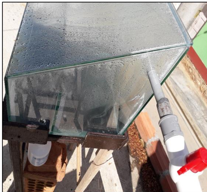
IMAGEN N°12. condensación del agua dentro del destilador solar
