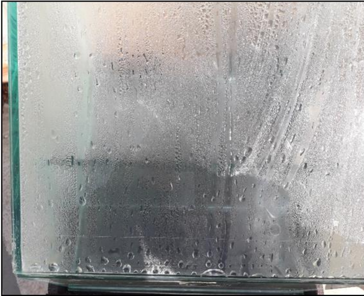
IMAGEN N°14. Recolección del agua condensada del destilador solar
