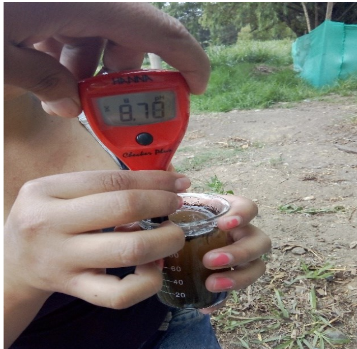
FOTOGRAFIA 4: Medición del PH de cada cama de compost
