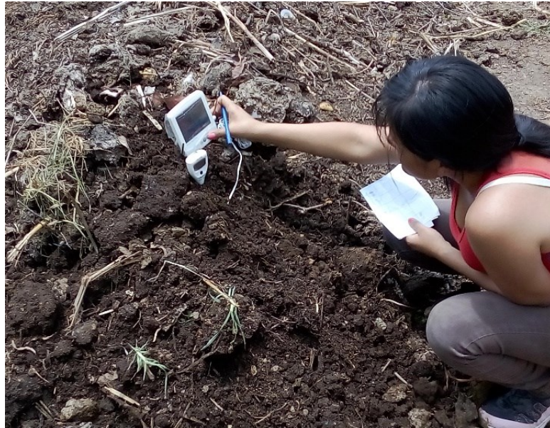
FOTOGRAFIA 5: Medición de la humedad máxima y mínima interna de cada cama
