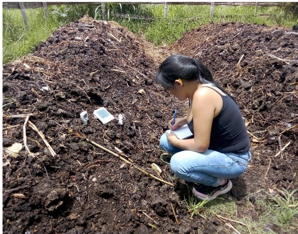
FOTOGRAFIA 6: Medición de la conductividad eléctrica de cada cama de compost
