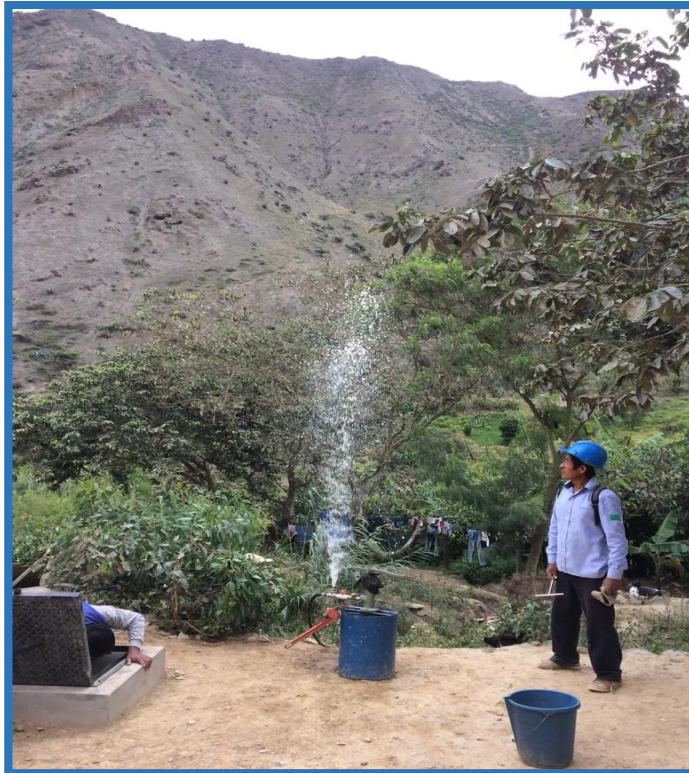
Prueba Hidráulica con la presencia del JAS apreciamos la presión del agua.
