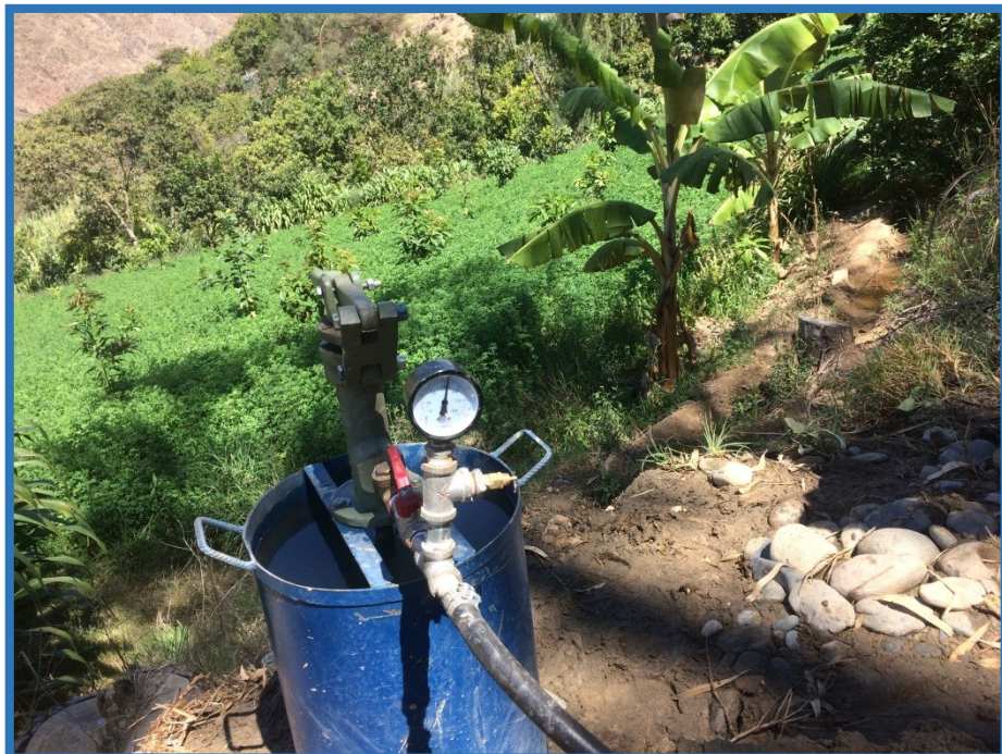
Observamos que pasa los 150 PSI en el manómetro.
