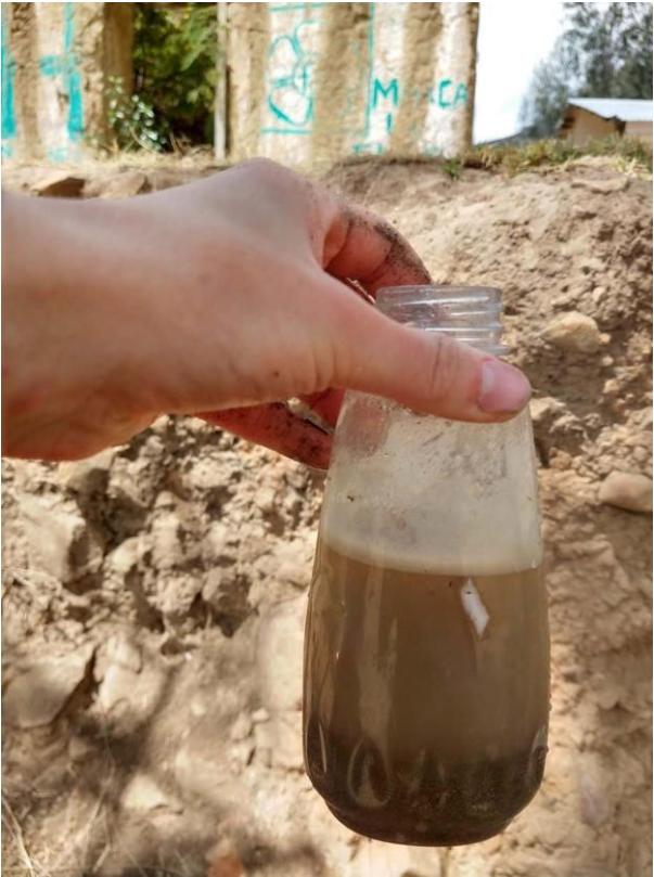
Figura 14. Correcto lavado de la arena
