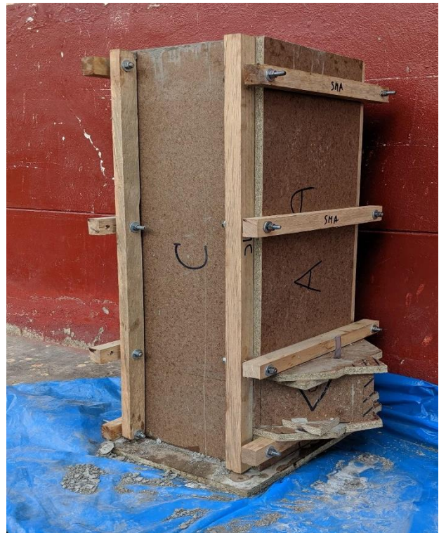
Figura 8. Molde del filtro con el cemento y hormigón
