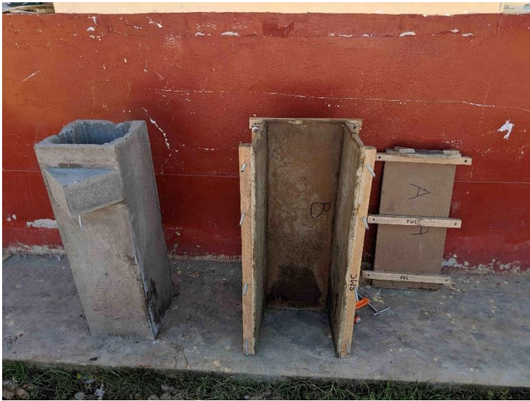
Figura 9. Filtro sacado del molde
