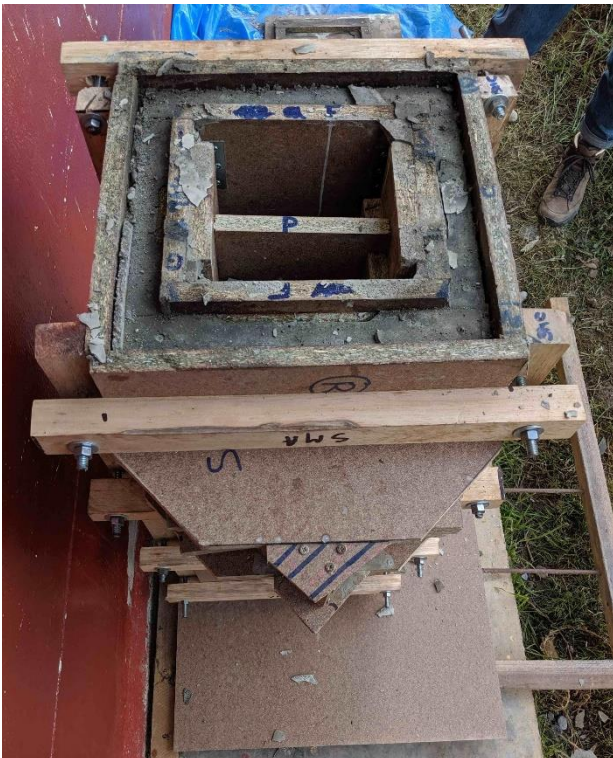
Figura 8. Molde del filtro con el cemento y hormigón
