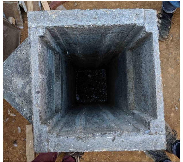
Figura 9. Filtro sacado del molde
