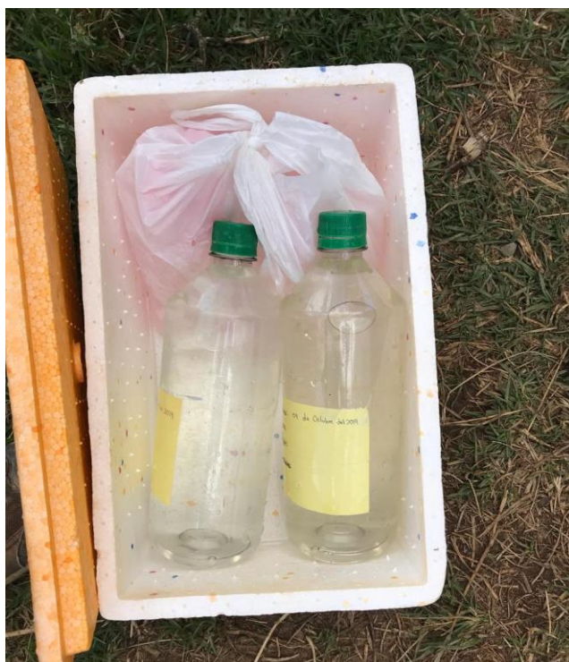
Figura 21. Muestras de agua y correctamente rotuladas
