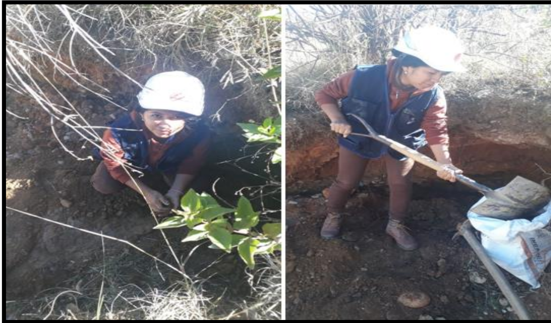
Gráfico 2: Pruebas de campo de la bolita y cinta según la norma E.080.
