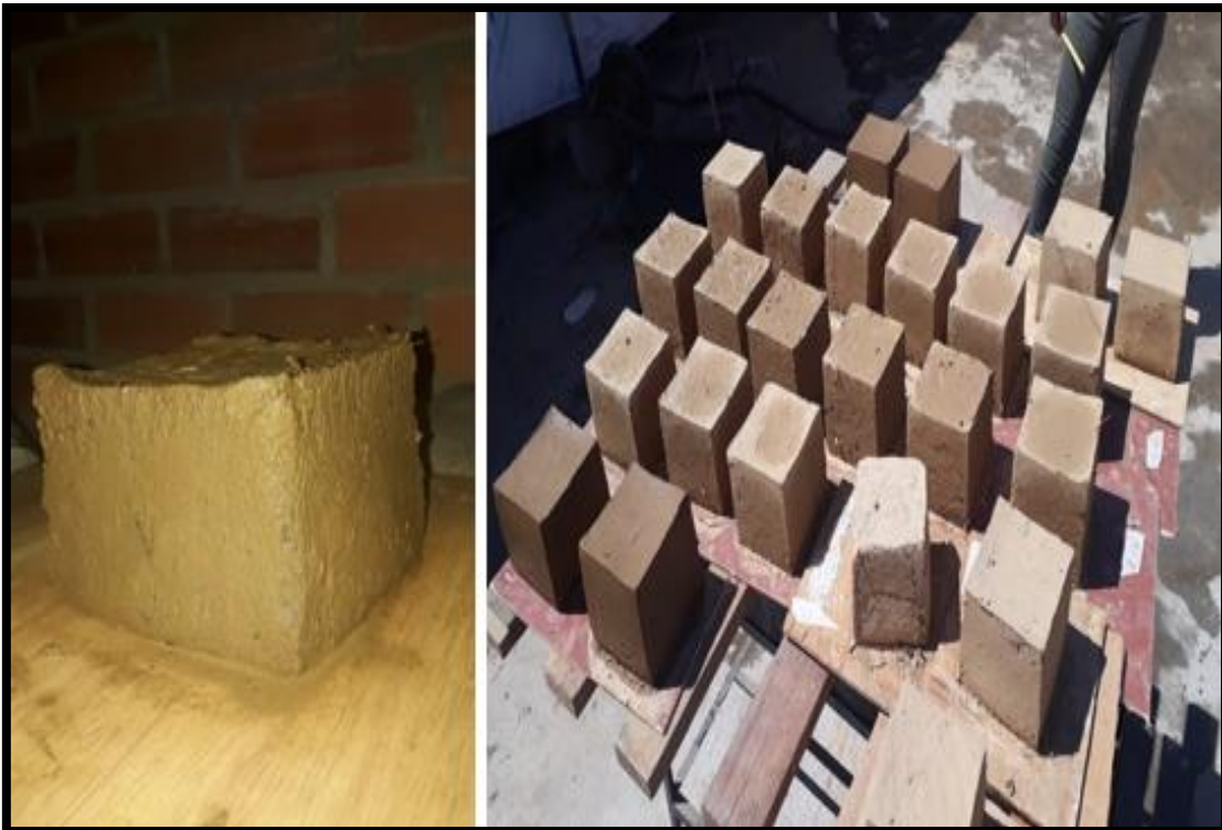
Gráfico 8: Secado de los adobes por un periodo de 7 días para su posterior prueba de resistencia.
