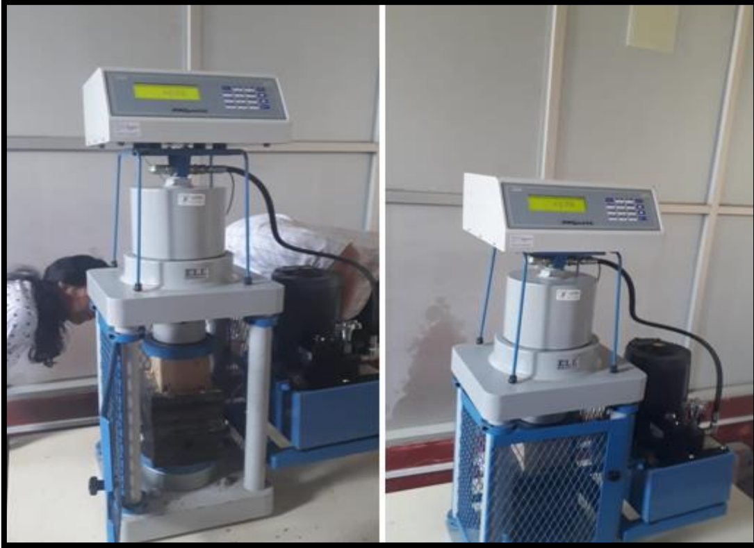
Gráfico 9: Pruebas de resistencia a la compresión de los adobes convencionales y adobes hechos con polietileno de baja densidad.
