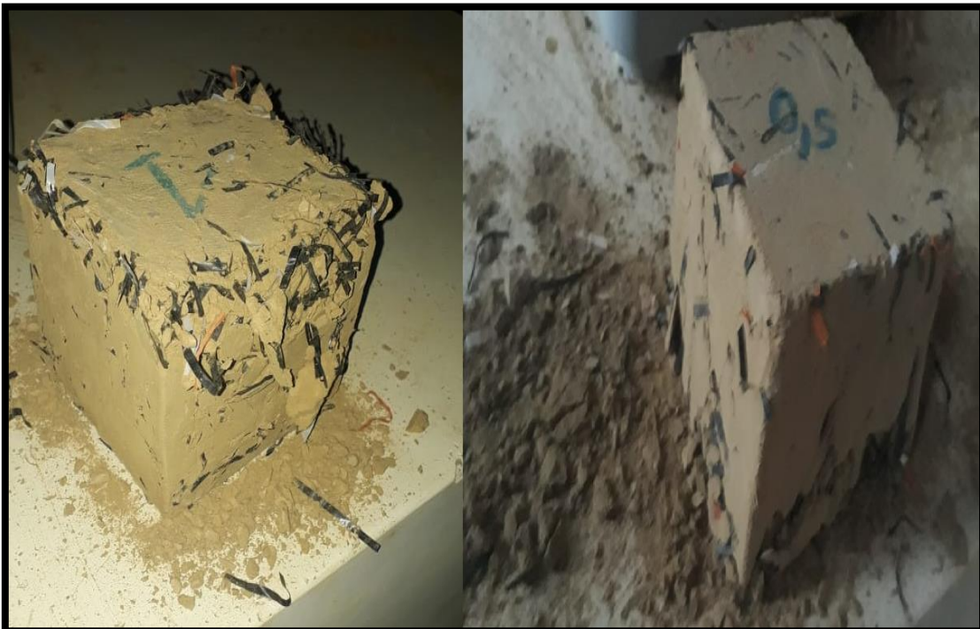
Gráfico 10: Fallas del adobe luego de la prueba de resistencia de compresión
