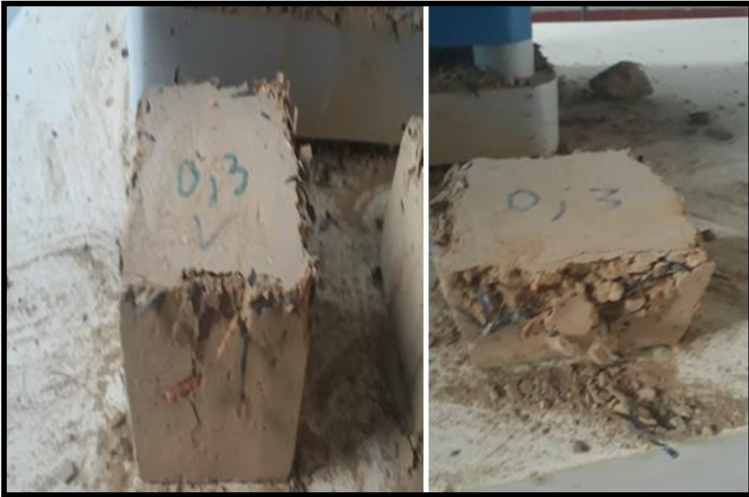
Gráfico 11: Fallas del adobe luego de la prueba de resistencia de compresión
