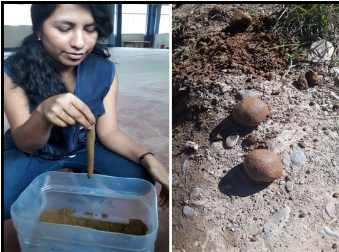
Gráfico 2: Pruebas de campo de la bolita y cinta según la norma E.080.
