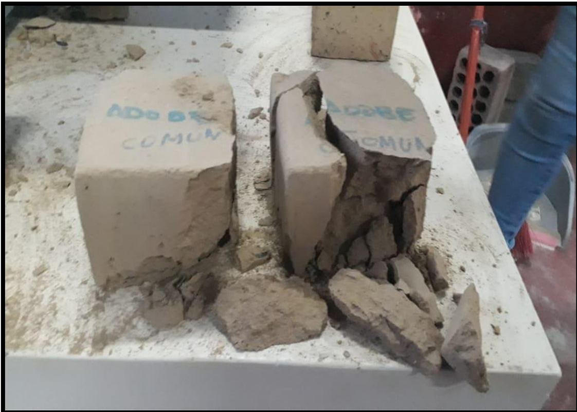
Gráfico 12: Fallas del adobe luego de la prueba de resistencia de compresión
