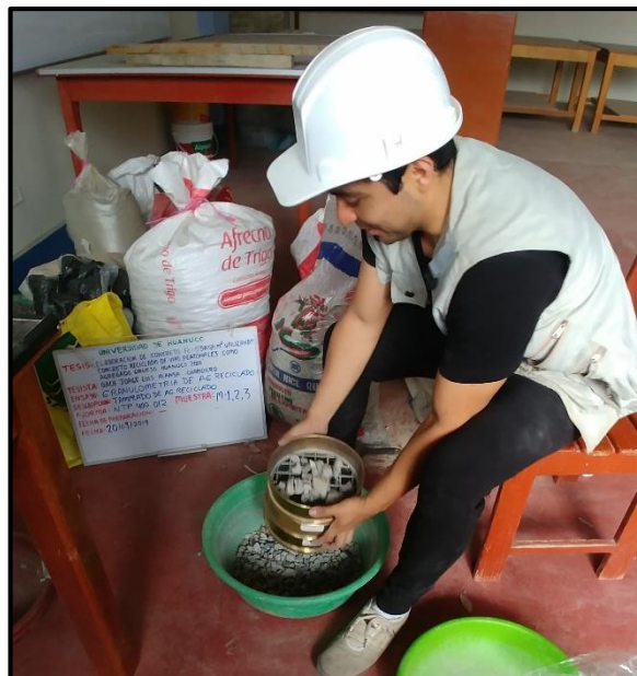
Foto 8. Tamizado de los materiales finos y gruesos para granulometría
