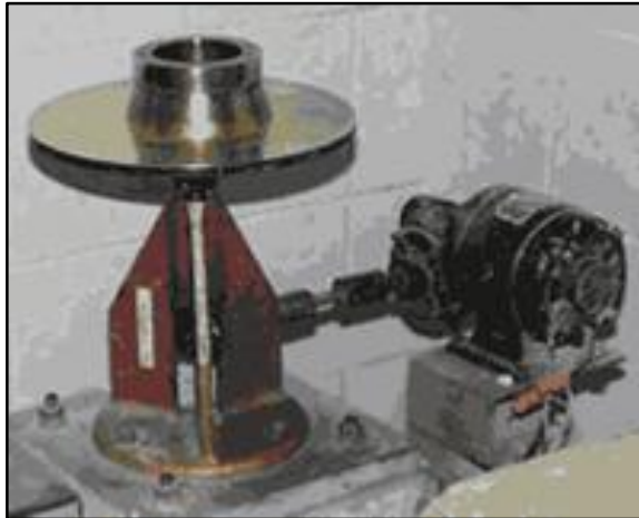
Figura 8. Mesa de Sacudida para realizar ensayos de fluidez. Fuente: apuntesingenierocivil
