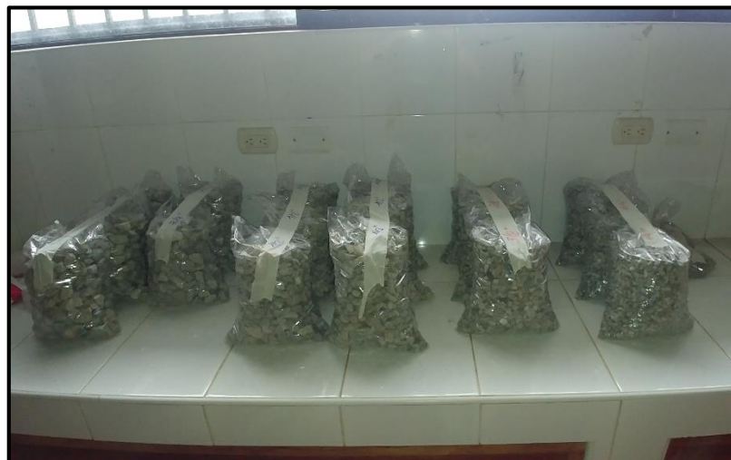
Foto 9. Distribución del agregado reciclado triturado luego del ensayo de granulometría
