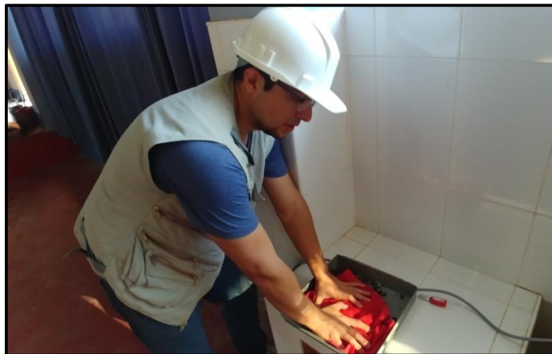
Foto 15. Secado superficial del material grueso para el ensayo de densidad relativa de gruesos
