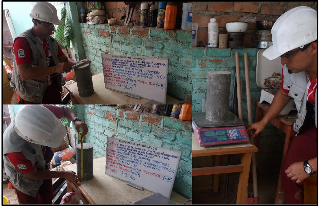
Foto 30. Dimensionamiento y pesado de probetas previas a ser ensayadas en máquina compresora
