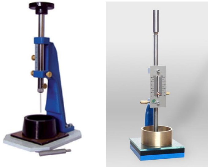
Figura 14. Aparato de Vicat con aguja de 16 mm (izquierda) y aguja de 645mm (derecha). Fuente: “Aparato de Vicat Manual” de pinzuar.com
