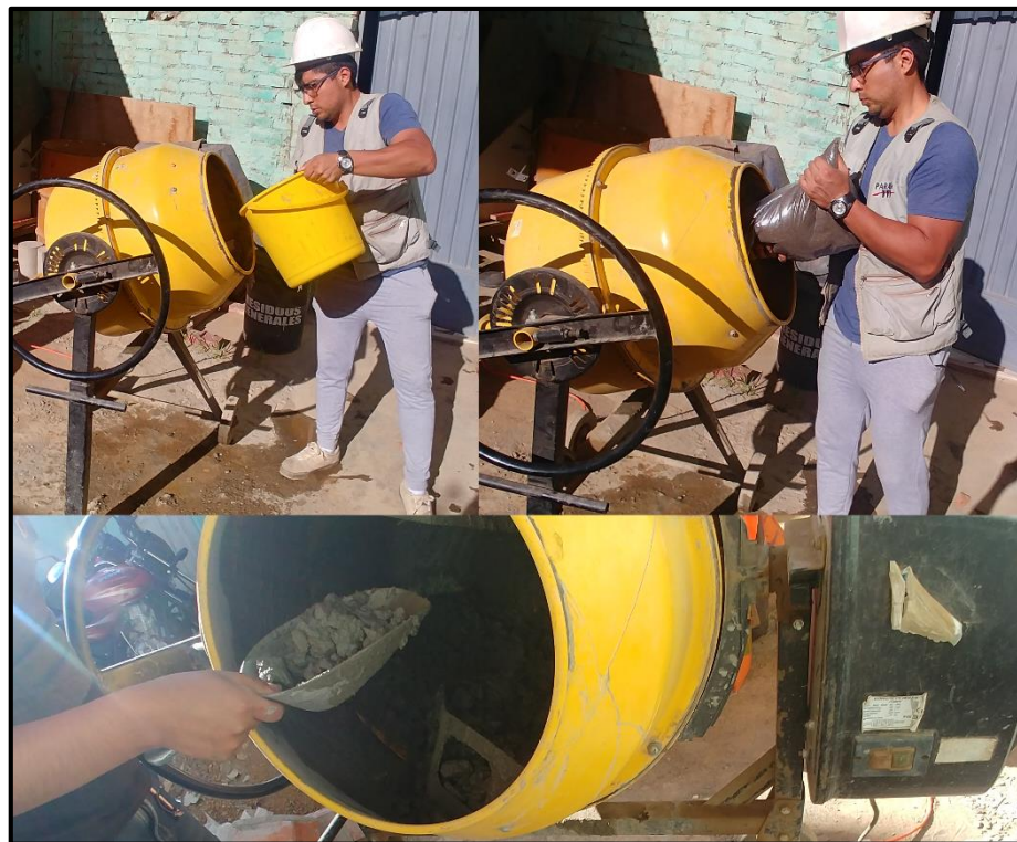
Foto 23. Mezclado en trompito de los materiales en laboratorio
