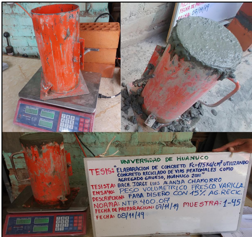
Foto 25. Ensayo para la determinación del peso volumétrico del concreto en estado fresco
