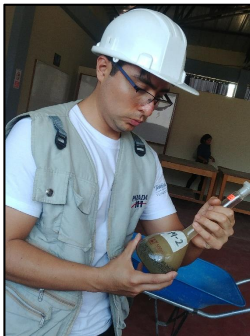
Foto 12. Saturación de la arena gruesa superficialmente seca para ensayo de densidad relativa de finos
