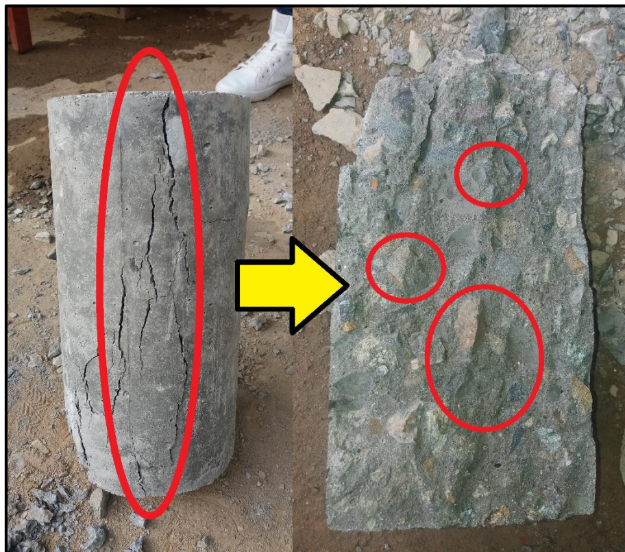
Foto 33. Ilustración de la falla en una probeta (izquierda) y distribución de partículas dentro de ésta al abrirla por su mitad (derecha)
