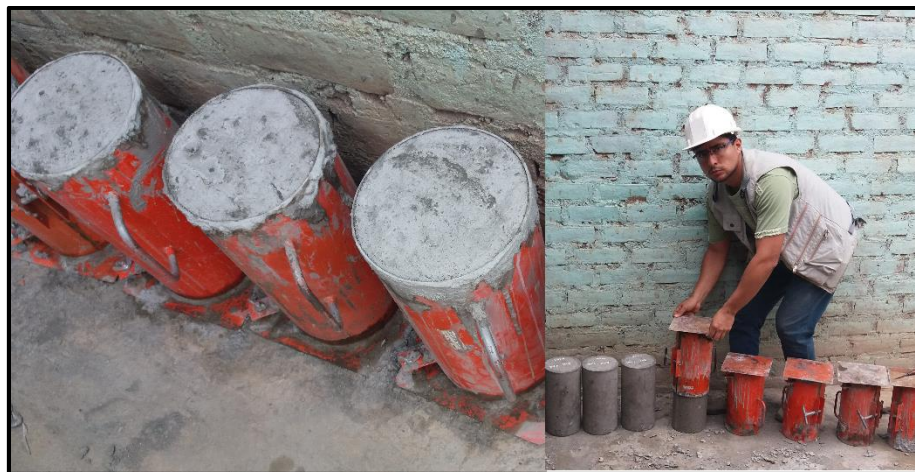
Foto 27. Desencofrado o desmoldeo de las probetas tras 24 hr
