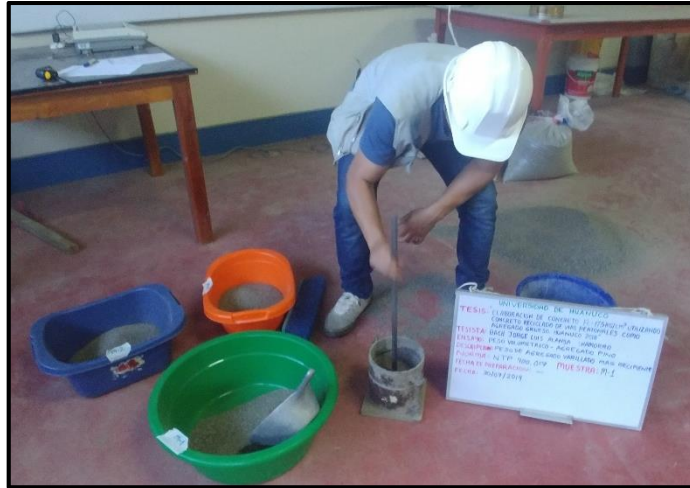
Foto 10. Ensayo de peso volumétrico: Varillado de material
