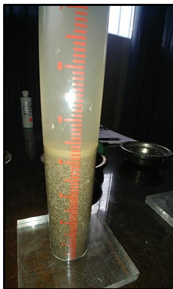
Foto 21. Lectura de alturas asentadas de finos, limos arcillas y coloides
