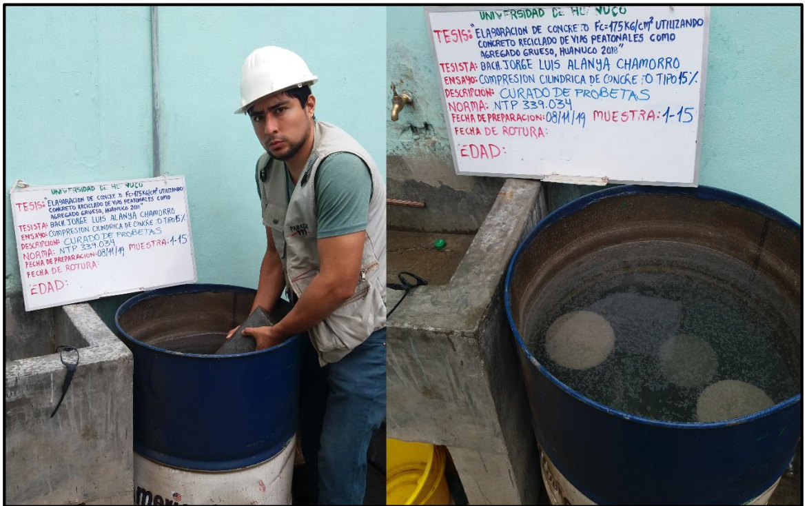
Foto 29. Proceso de curado de los especímenes cilíndricos de concreto
