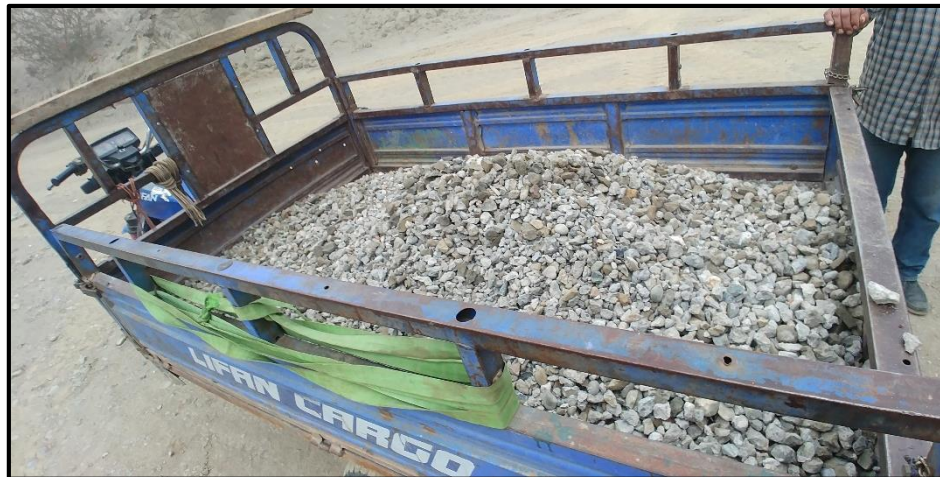
Foto 5. Concreto reciclado triturado listo para ser transportado a laboratorio
