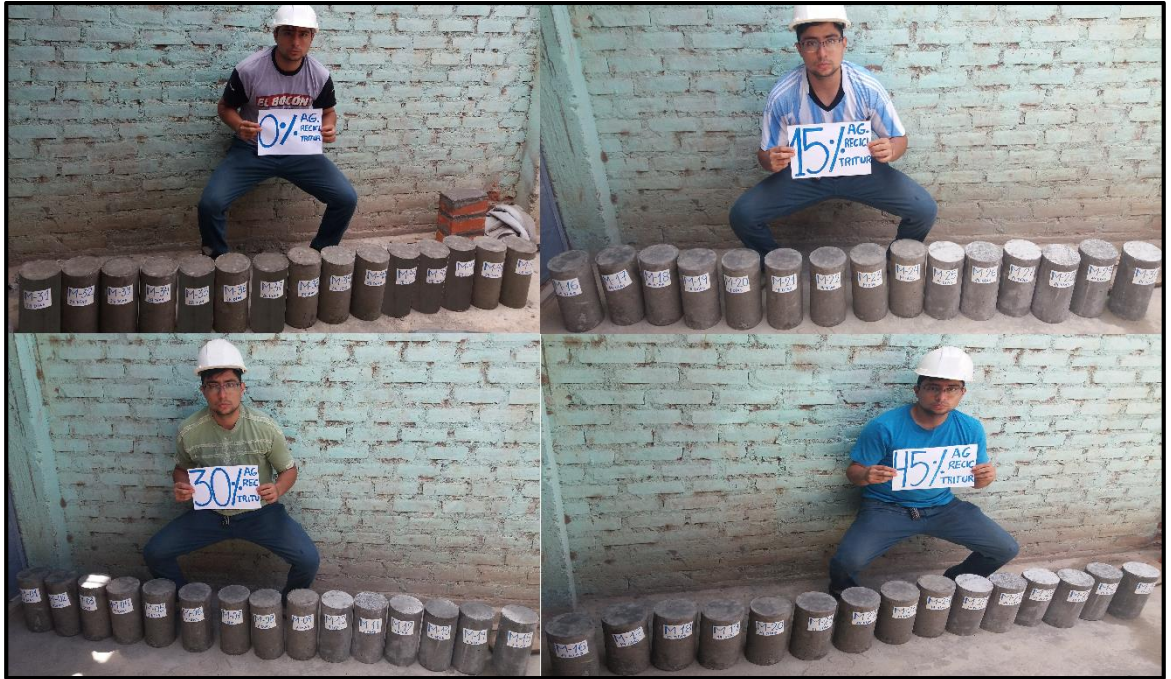
Foto 28. Probetas desencofradas de los tipos 0%, 15%, 30% y 45%
