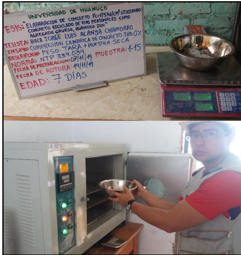
Foto 32. Pesado y secado de muestras representativas de las probetas rotas ya ensayadas, para determinación de densidades húmedas y secas
