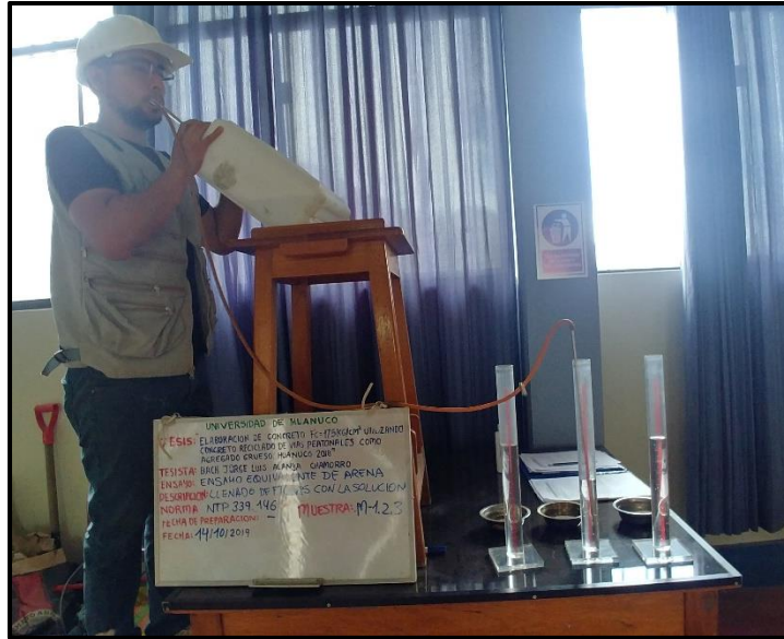
Foto 19. Sistema elaborado para el ensayo de equivalente de arena
