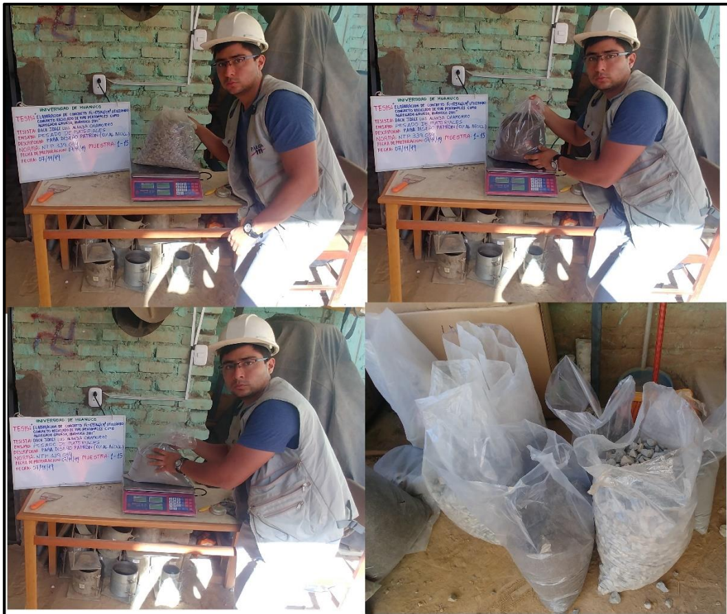
Foto 22. Pesado de los materiales para la elaboración de las mezclas de concreto
