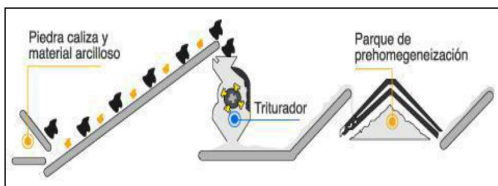
Figura 2. Proceso de homogenización y molienda del material.
