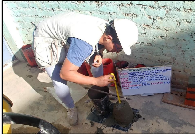
Foto 24. Determinación del asentamiento de la mezcla fresca (slump)
