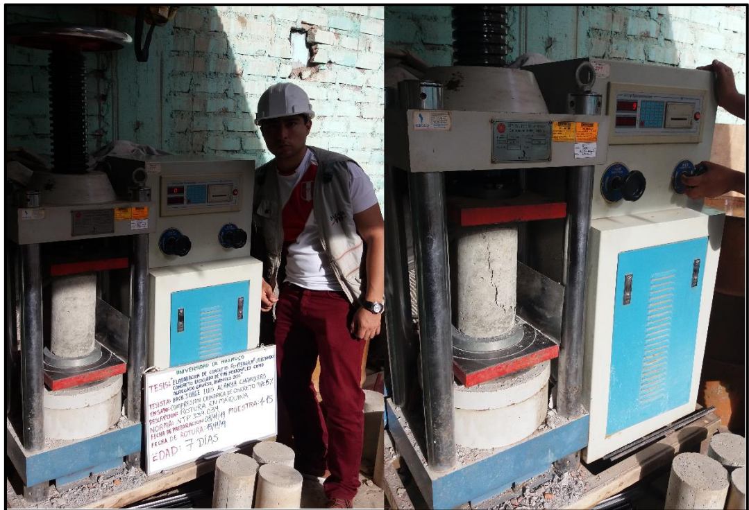
Foto 31. Colocación del testigo de concreto en máquina compresora antes (izquierda) y después de ser ensayada (derecha)
