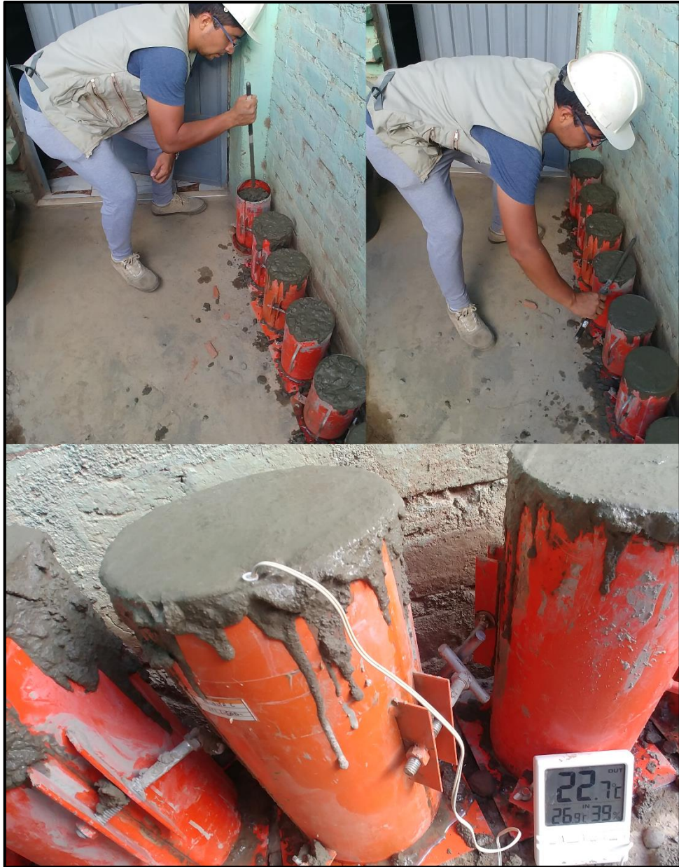
Foto 26. Varillado manual en 3 capas, enrasado y toma de temperatura del concreto en estado fresco
