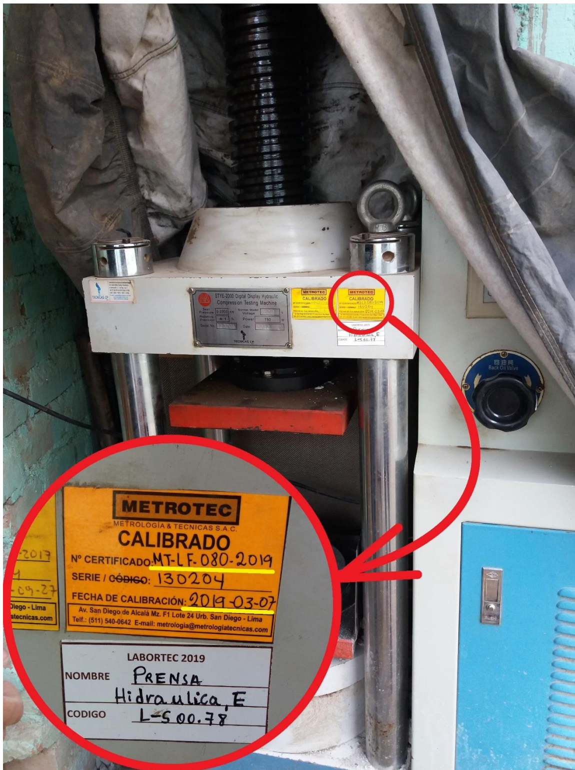
Foto 34. Máquina compresora de especímenes cilíndricos de concreto, con vista a detalle del sticker de Certificación de Calibración dada por la empresa METROTEC METROLOGÍA Y TÉCNICAS S.A.C.
