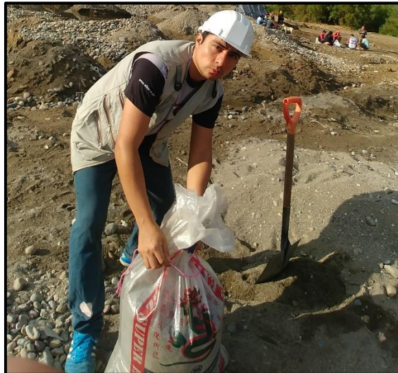
Foto 2. Extracción de material fino natural de cantera de río
