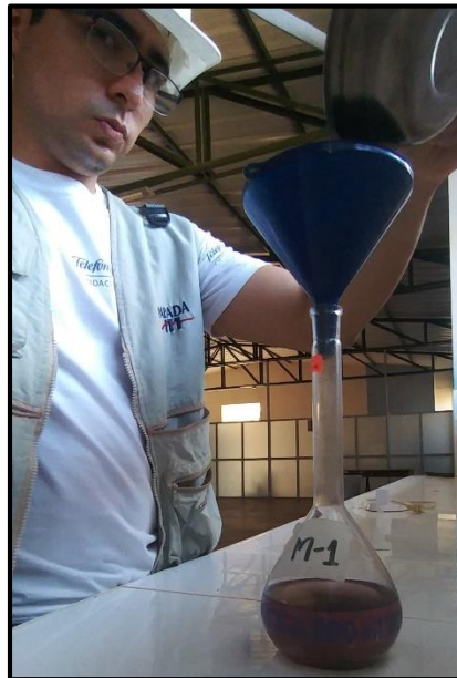
Foto 17. Inserción del material en fiola con fluido, para ensayo de densidad del cemento
