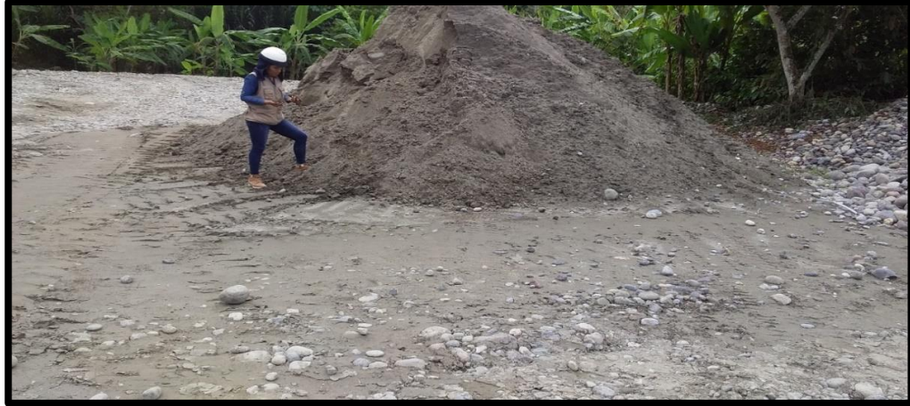
Figura 2.2: selección de cantera para el agregado fino de la cantera los Milagros ubicado en el Distrito de Castillo Grande.
