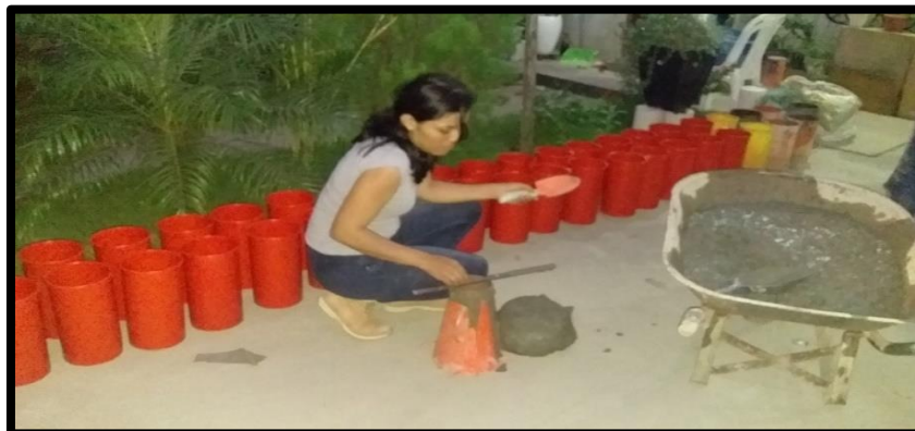
Figura 3.14: Medición del slump del concreto sin aditivo
