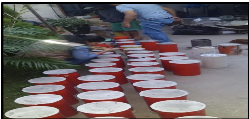
Figura 3.17: Desmolde de especímenes de concreto sin aditivo
