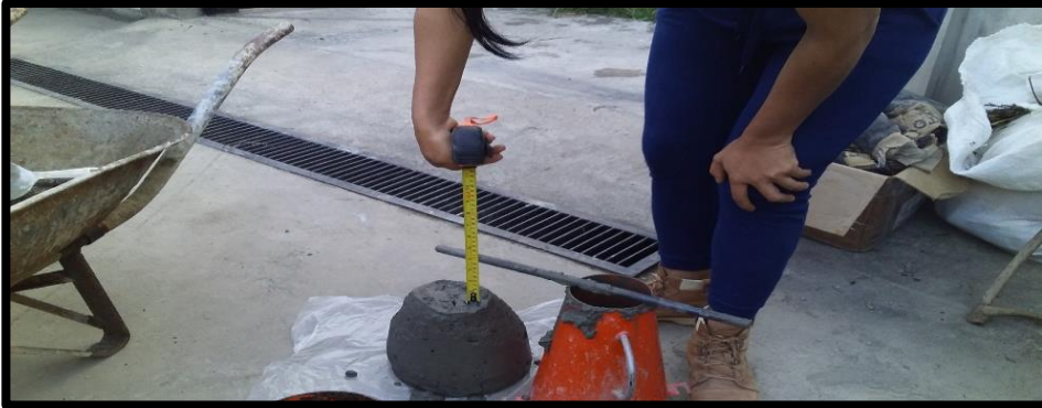
Figura 3.21: Medición del slump del concreto con aditivo
