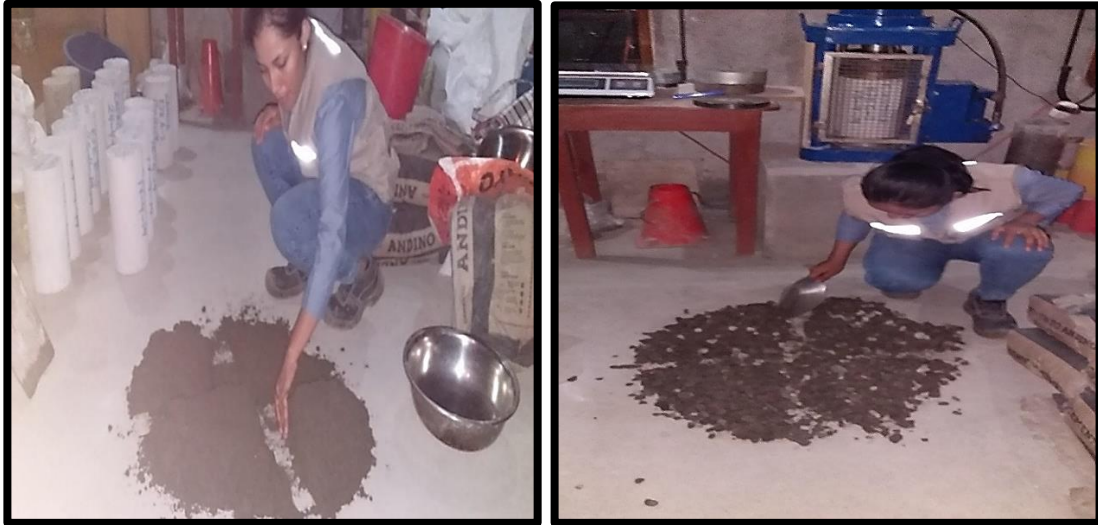
Figura 3.7: Agregado fino y grueso
