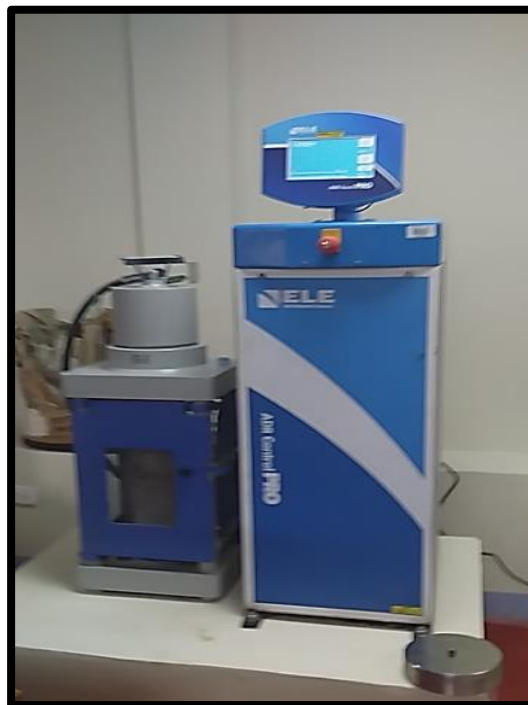
Figura 3.5: Prensa hidráulica para el ensayo a la compresión.
