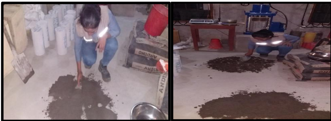
Figura 2.3: Cuarteado de los agregados para determinar el análisis granulométrico por tamizado y la curva granulométrica
