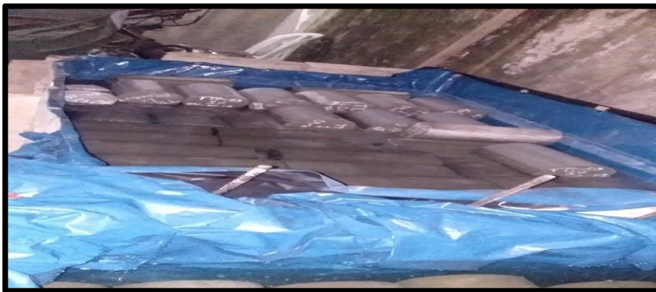
Figura 3.19: Curado de muestras de concreto sin aditivo
