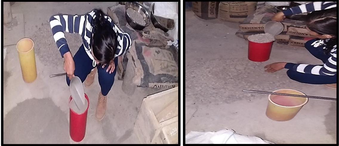
Figura 2.4: Pesado de los Agregados fino y grueso en su estado seco
