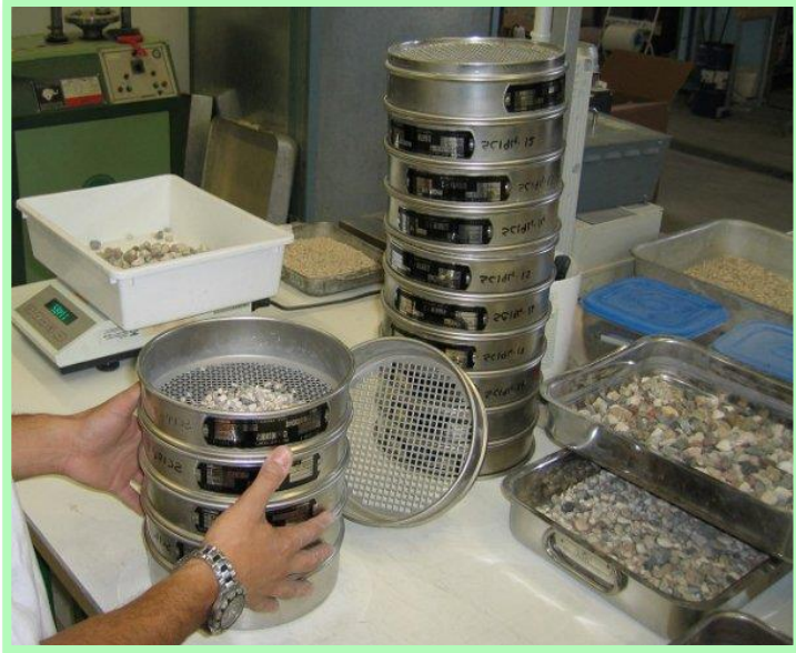
IMAGEN N°04: a continuación, se procede a realizar el ensayo de granulometría del material selecto. Dicho ensayo se realiza en el laboratorio de la UNIVERSIDAD DE HUANUCO.
