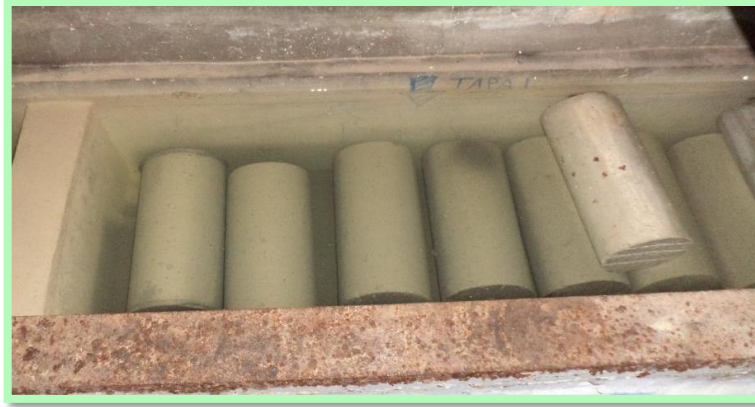
IMAGEN N°13: se procede a realizar el curado del concreto, considerando la norma NTP 339.033 o ASTM C-31
