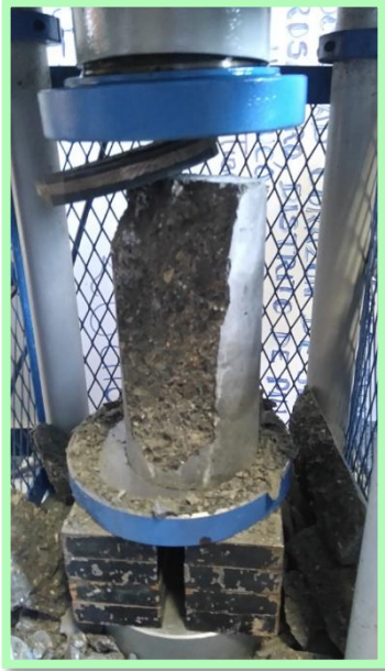
IMAGEN N°15: la prueba consiste en aplicar la fuerza sobre la probeta a las cuales se les pone una plantilla de azufre para que la presión sea uniforme, de esta manera se monitorea la resistencia ante la presión del concreto, presentándose una falla de
