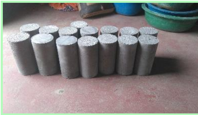
IMAGEN N°14: testigos para ensayos de resistencia de acuerdo a la norma peruana NTP 339.033 o ASTM C-31.
