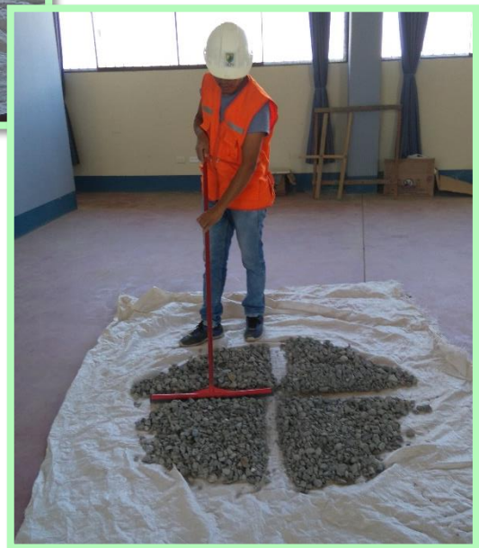
IMAGEN N°03: realizando el cuarteo, para seleccionar y realizar el ensayo respectivo.
