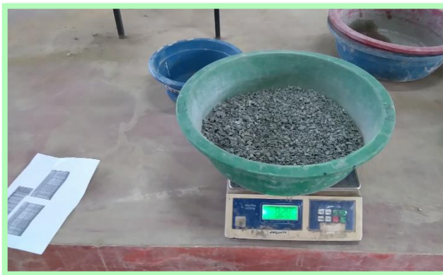
IMAGEN N°05: se realiza el peso respectivo, agregado grueso.
