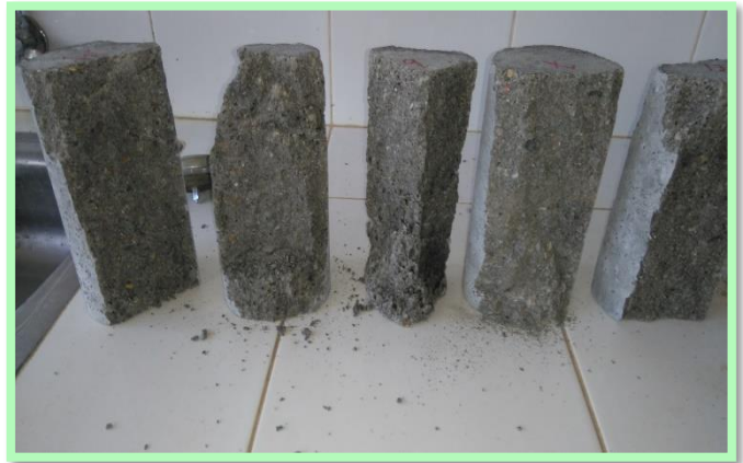
IMAGEN N°16: en la imagen se aprecia las fallas que resultaron al someterlos a ensayo a la compresión.
