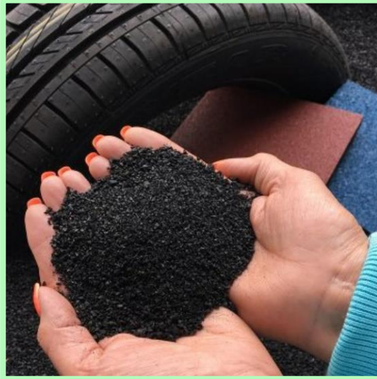
IMAGEN N°05: se añadirá un 10 % y 20% de fino de reciclado de llantas de caucho.
