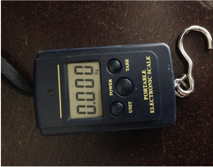
Fig.13. Instrumento de medición, Balanza digital utilizado en el pesaje de residuos.
