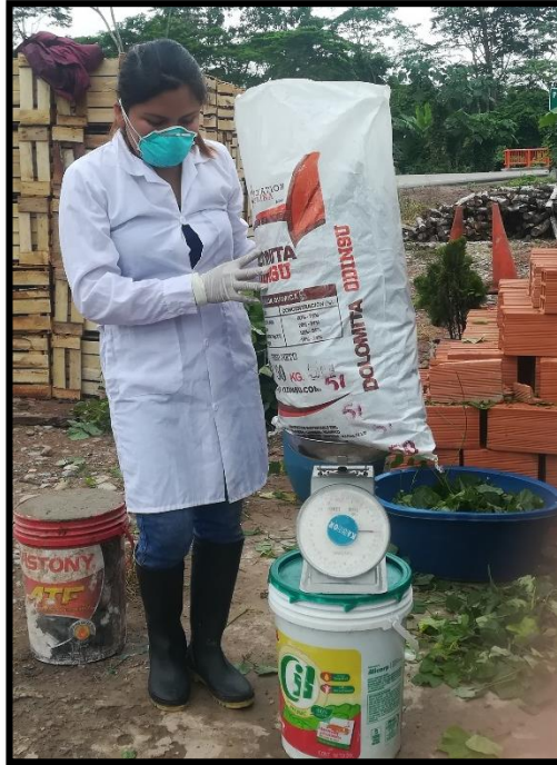
Pesado del kudzu picada y del estiércol para luego adicionar al biodigestor discontinuo.
