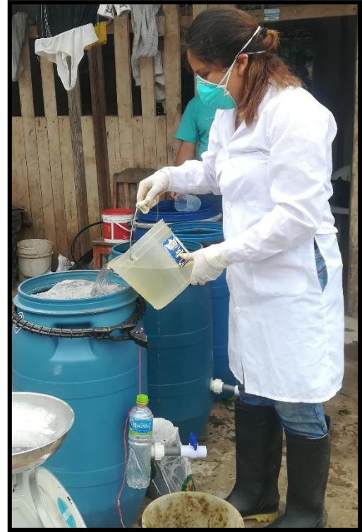
Adición de 1.65 L de melaza y 57 L de agua para la producción de los bioles
