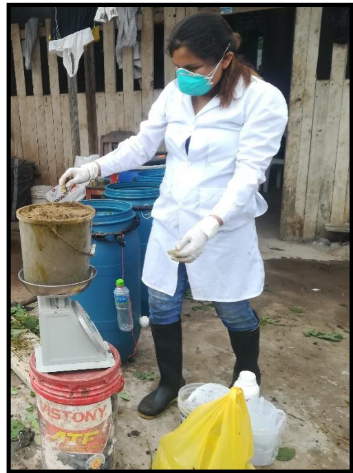
Pesado del kudzu picada y del estiércol para luego adicionar al biodigestor discontinuo.
