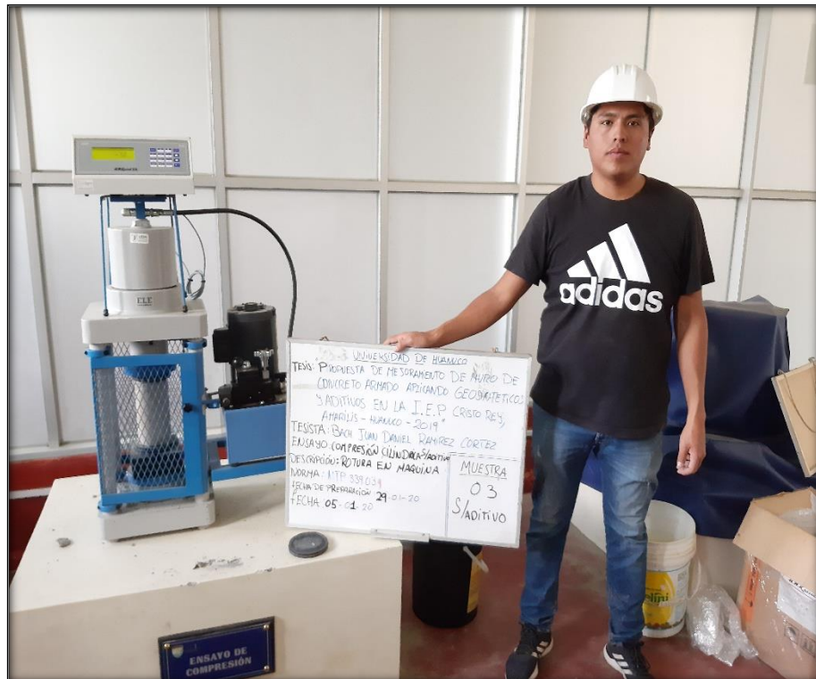
Foto n° 30 Rotura de probeta sin aplicación de aditivo a los 7 días de curado
