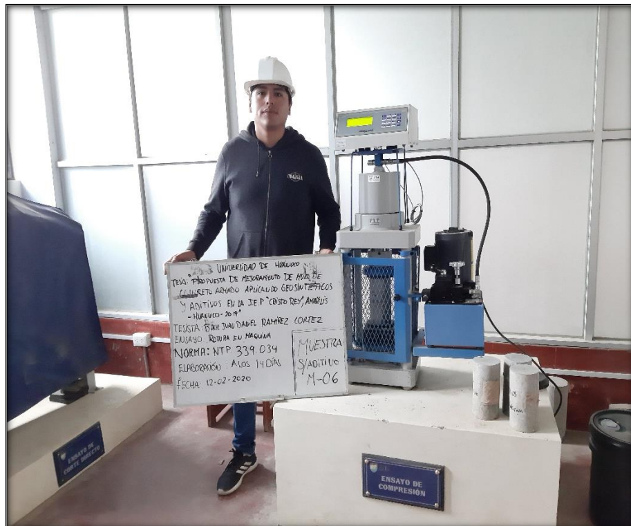
Foto n° 34 Rotura de probeta sin aplicación de aditivo a los 14 días de curado
