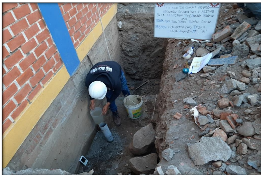
Foto n° 8 Ensayo de carga variable decreciente in situ
