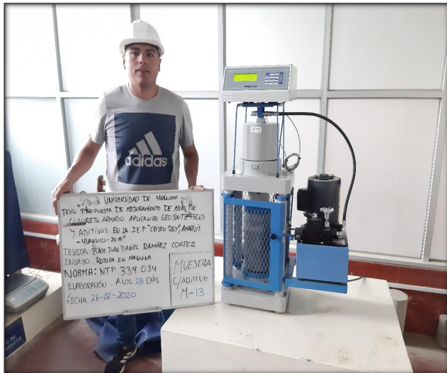
Foto n° 40 Rotura de probeta con aplicación de aditivo a los 28 días de curado
