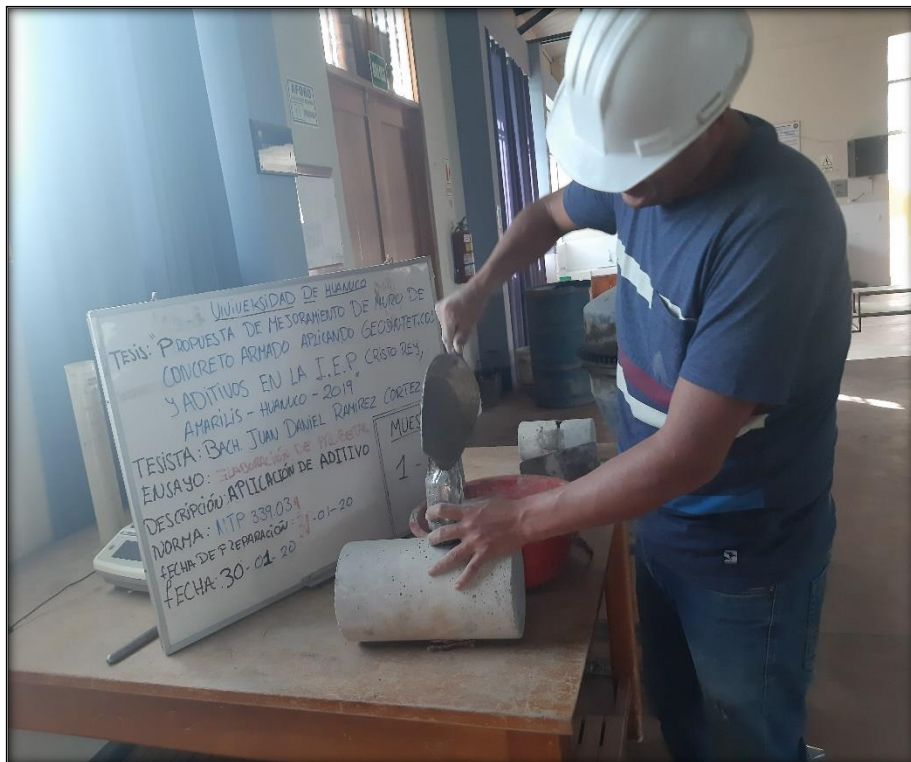
Foto n° 28 Adición de aditivo grout de alta resistencia a la probeta con fisura simulada
