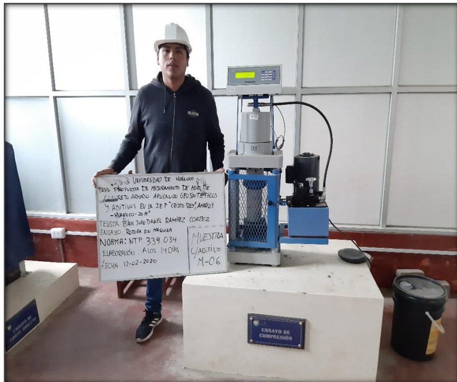
Foto n° 36 Rotura de probeta con aplicación de aditivo a los 14 días de curado
