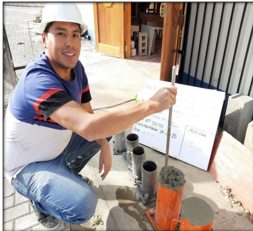
Foto n° 20 Varillado manual en 3 capas y enrasado
