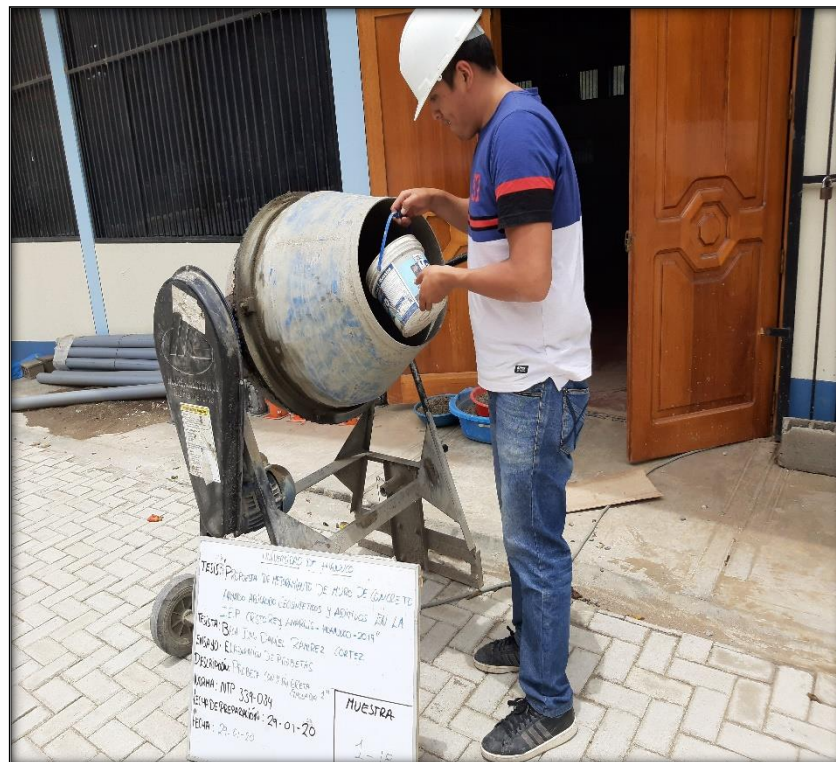
Foto n° 16 Mezclado en trompo pequeño de los materiales en el laboratorio de suelos UDH
