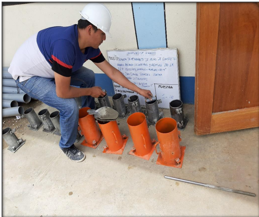
Foto n° 18 Colocación de tubo en las probetas para simular la grieta
