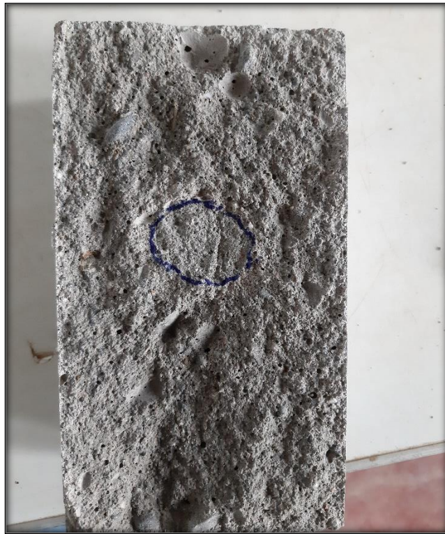
Foto n° 37 Testigos de concreto con aditivo a los 14 días de curado luego de realizar ensayo de rotura
