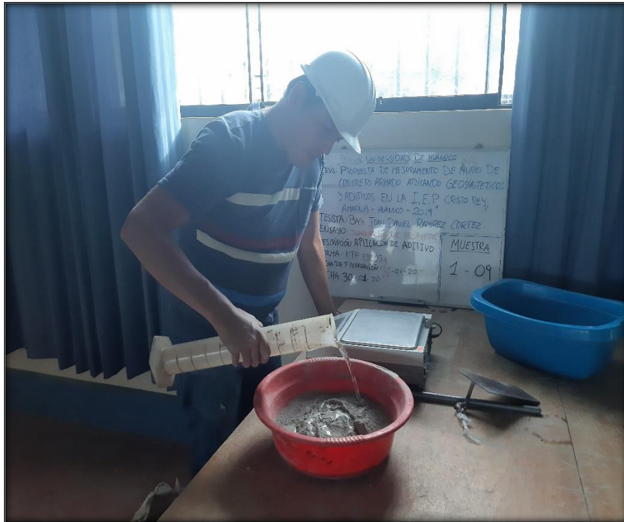
Foto n° 27 Dosificación según su ficha técnica otorgado por el fabricante
