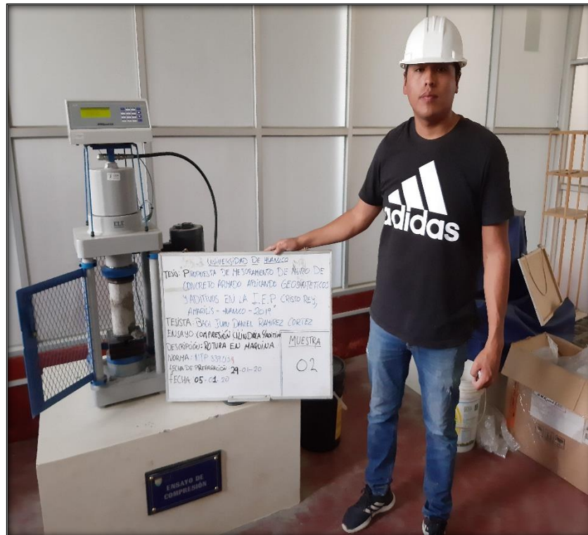
Foto n° 32 Rotura de probeta con aplicación de aditivo a los 7 días de curado
