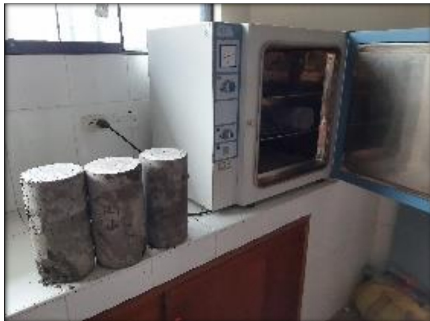
Foto n° 42 Pesado y secado de muestras representativas de las probetas rotas ya ensayadas, para determinación de densidades húmedas y secas
