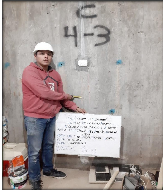
Foto n° 12 Disparos con el equipo de Esclerometría
