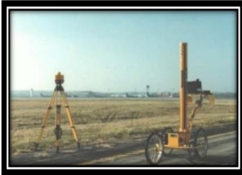
Figura N° 10 Los métodos para esta clase son la Mira y Nivel y TRRL Beam
