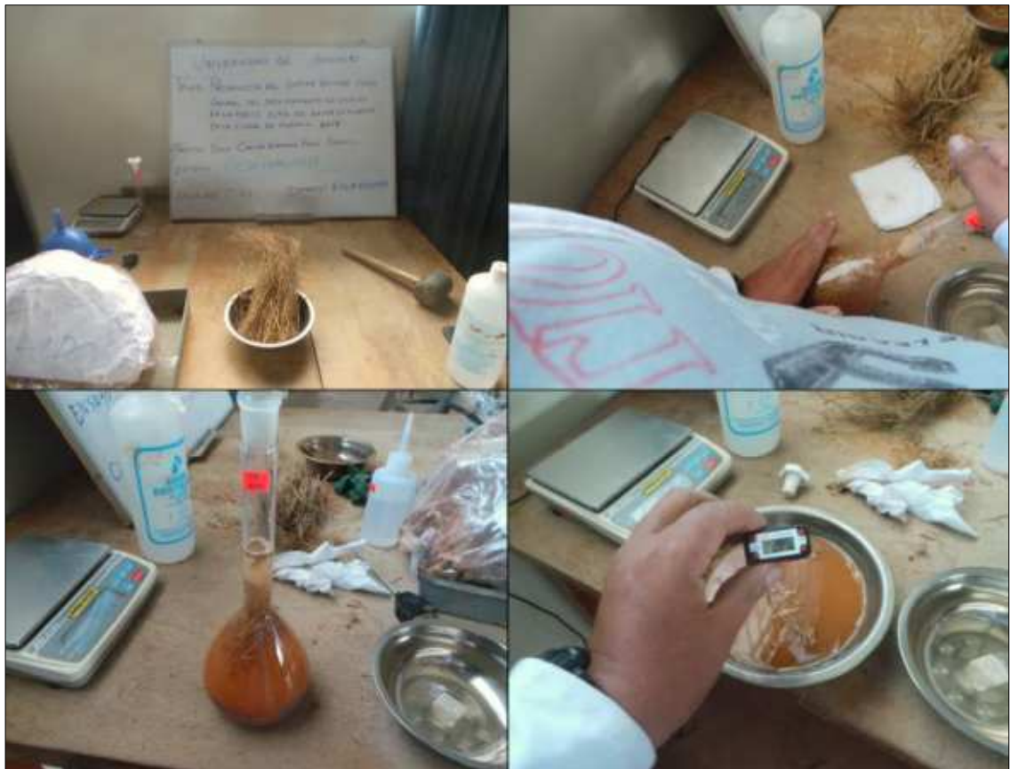
Fotografía 8: Ensayo de peso específico del Estrato E2 con las raíces del vetiver.
