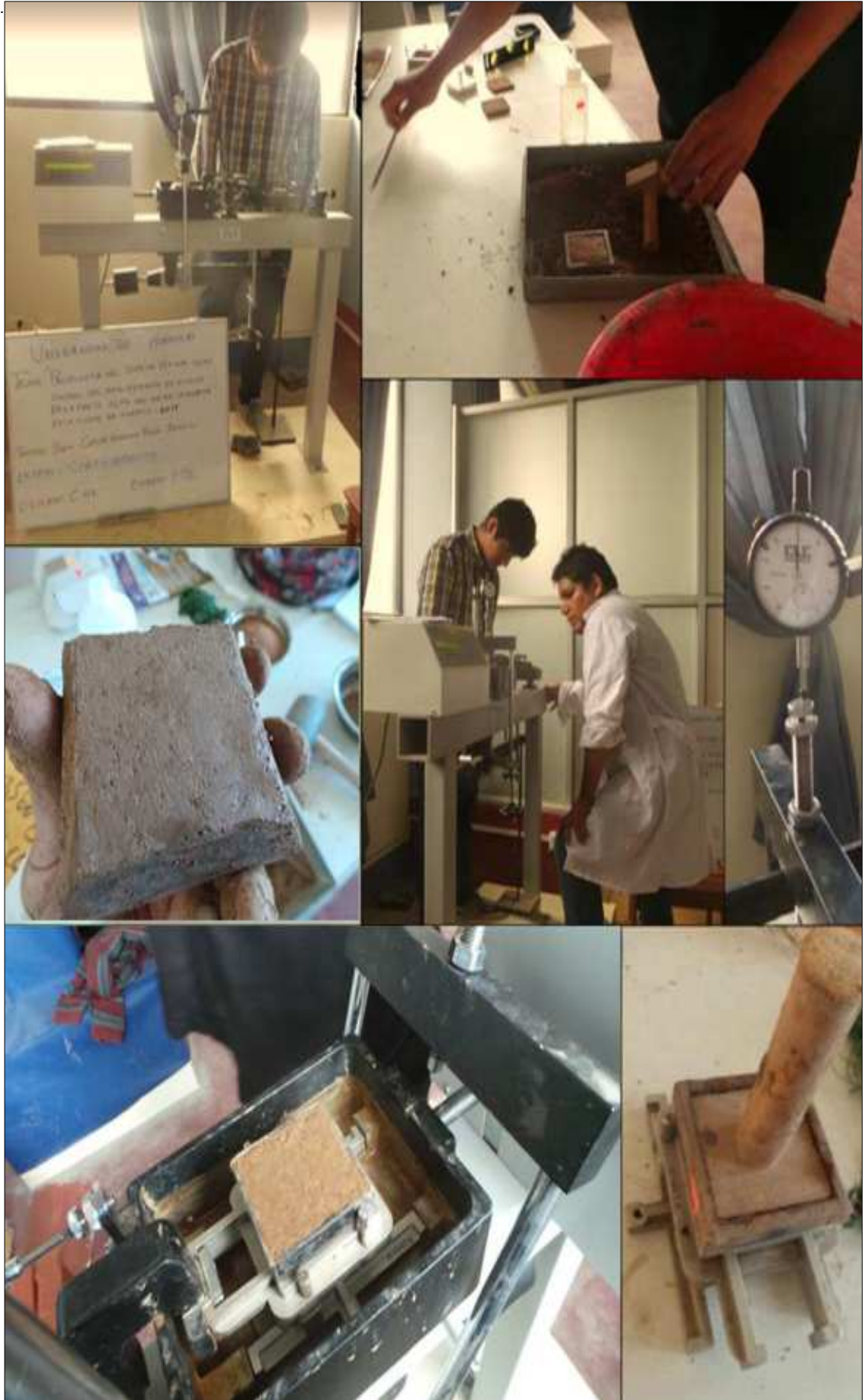
Fotografía 9: Ensayo de corte directo del Estrato E2.
