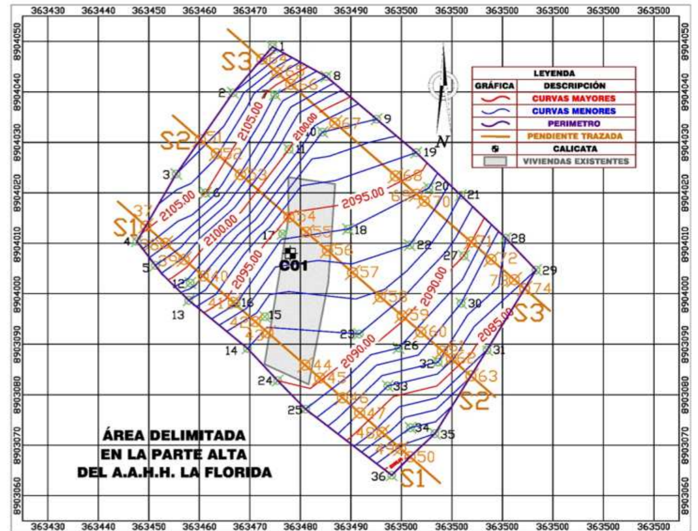
TOPOGRAFÍA DEL ÁREA DELIMITADA ESCALA 1/750
