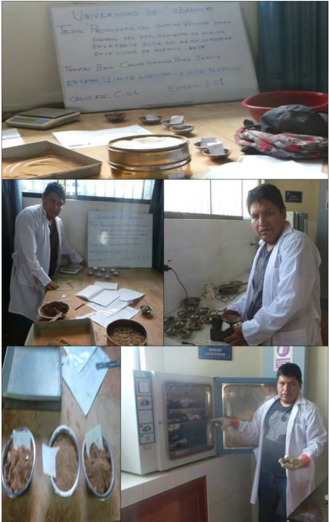
Fotografía 6: Ensayos de Plasticidad de suelos y contenido de humedad de los Estratos E1, E2.
