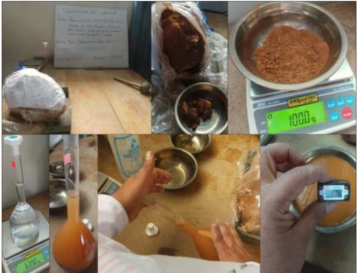
Fotografía 7: Ensayo de peso específico del Estrato E2.
