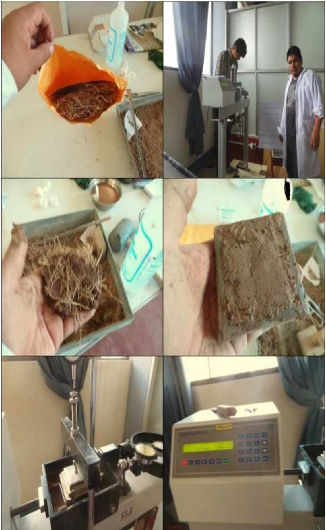
Fotografía 10: Ensayo de corte directo del Estrato E2 con las raíces del vetiver.
