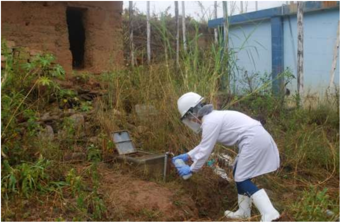
Figura 51. Toma de muestra de agua del reservorio (Muestra N° 3).
