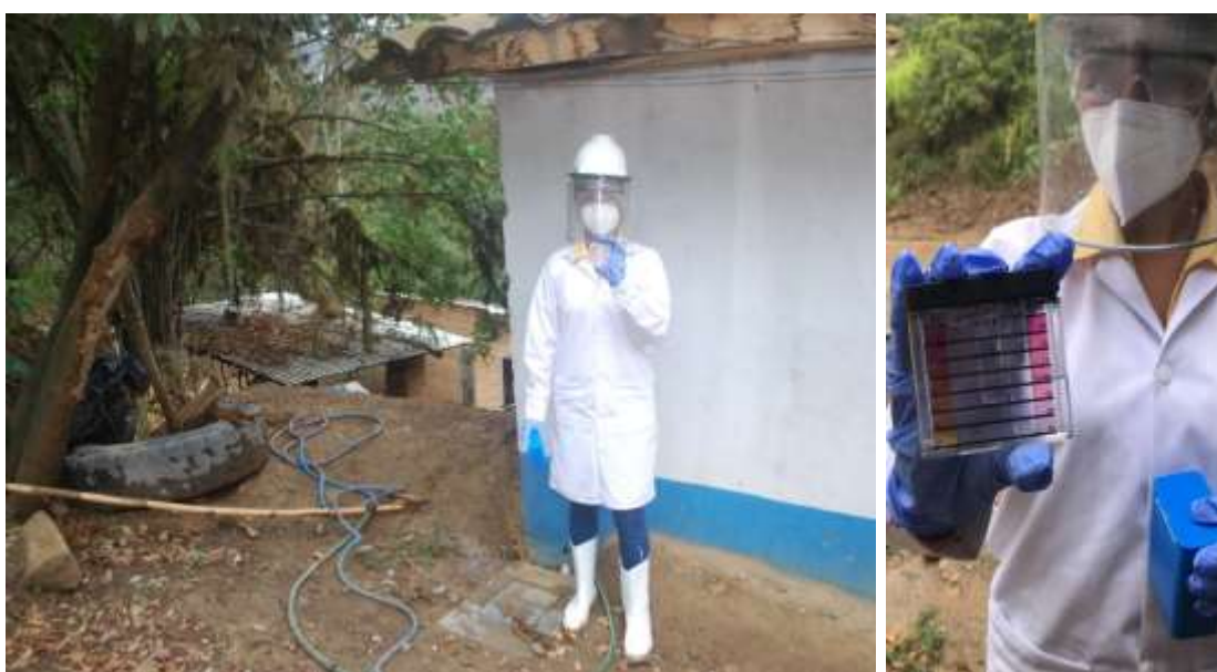
Figura 59. Control de cloro residual del agua de la vivienda intermedia, haciendo uso del comparador de cloro manual.
