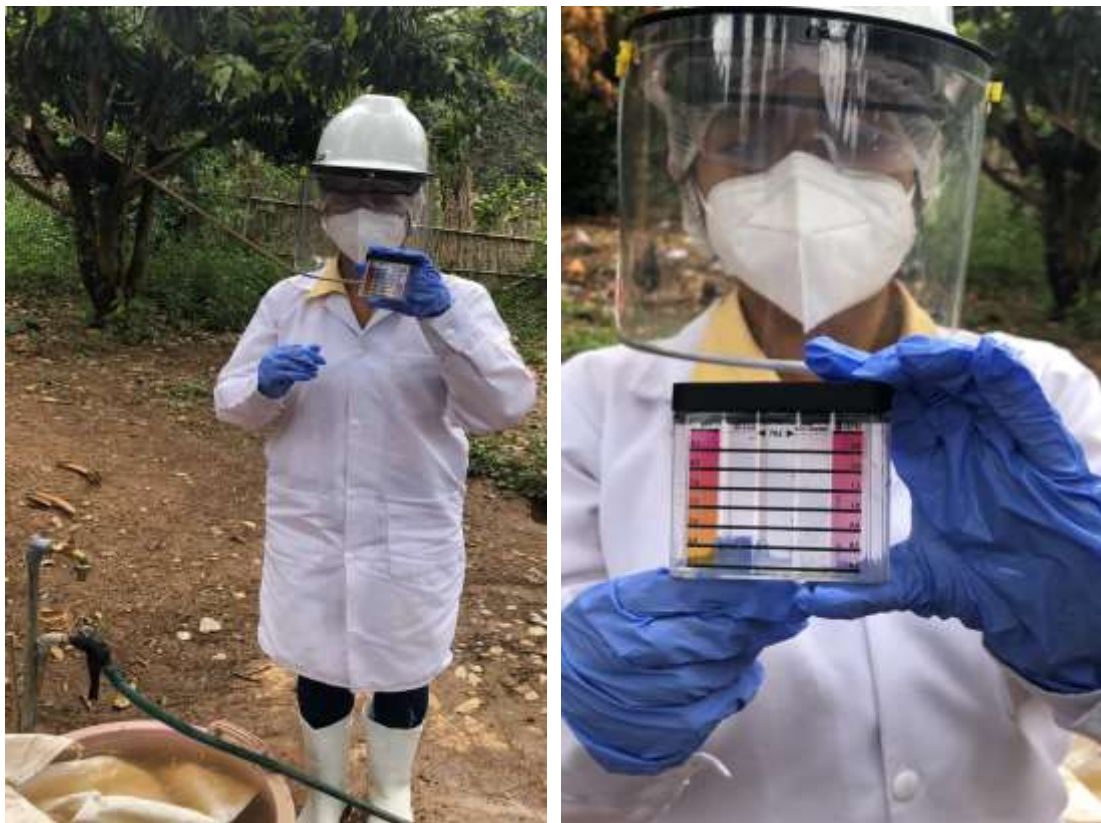
Figura 62. Control de cloro residual del agua de la última vivienda, haciendo uso del comparador de cloro manual.
