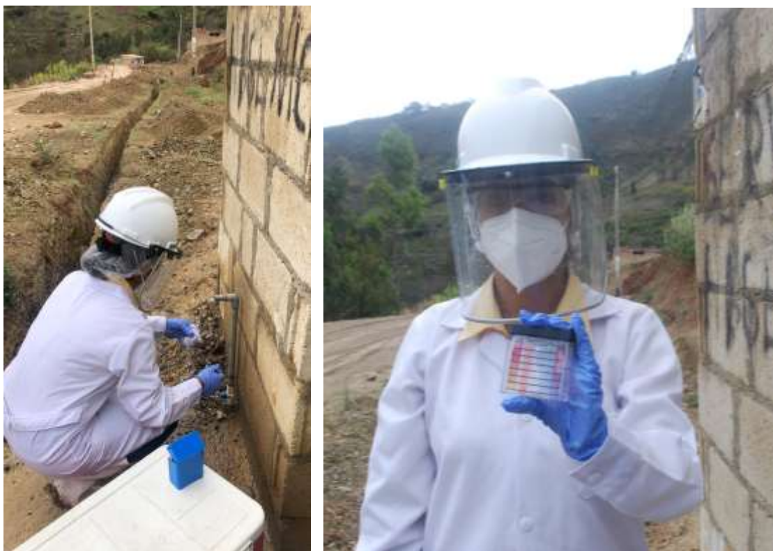
Figura 56. Control de cloro residual del agua de la primera vivienda, haciendo uso del comparador de cloro manual.
