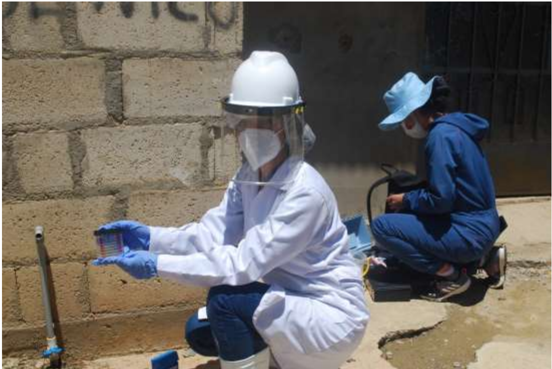
Figura 31. Control de cloro residual del agua de la primera vivienda, haciendo uso del comparador de cloro manual.
