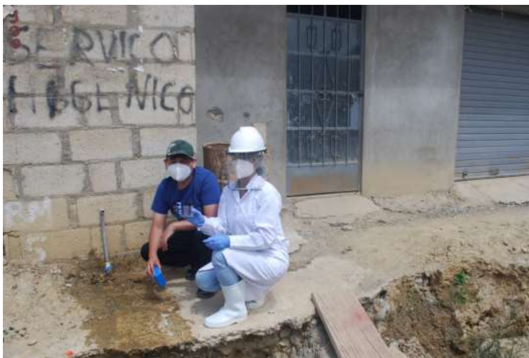
Figura 43. Control de cloro residual del agua de la primera vivienda, haciendo uso del comparador de cloro manual, bajo la supervisión del asesor.
