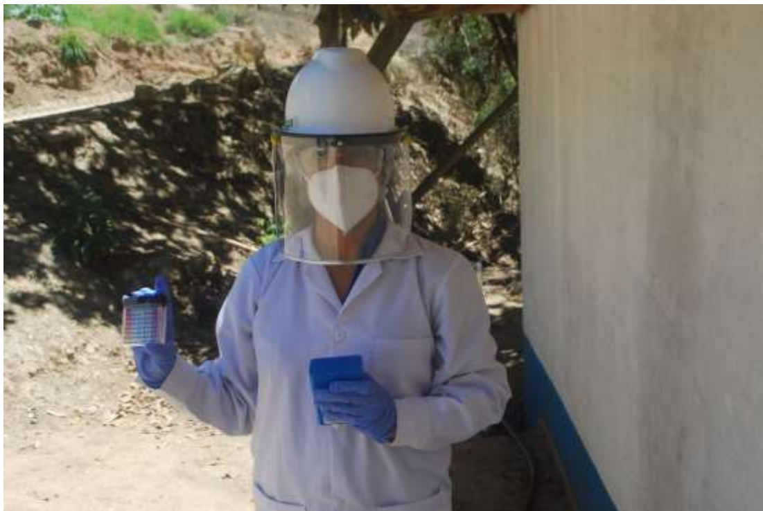
Figura 34. Control de cloro residual del agua de la vivienda intermedia, haciendo uso del comparador de cloro manual.
