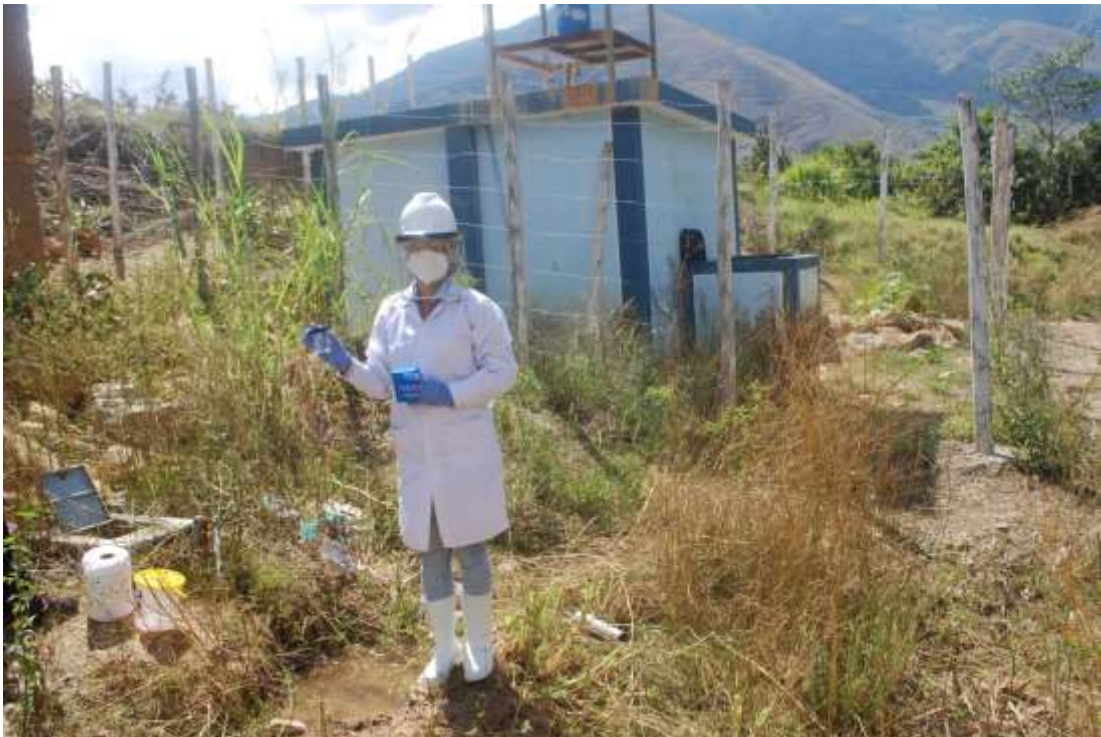
Figura 40. Control de cloro residual del agua del reservorio, bajo la supervisión del asesor.
