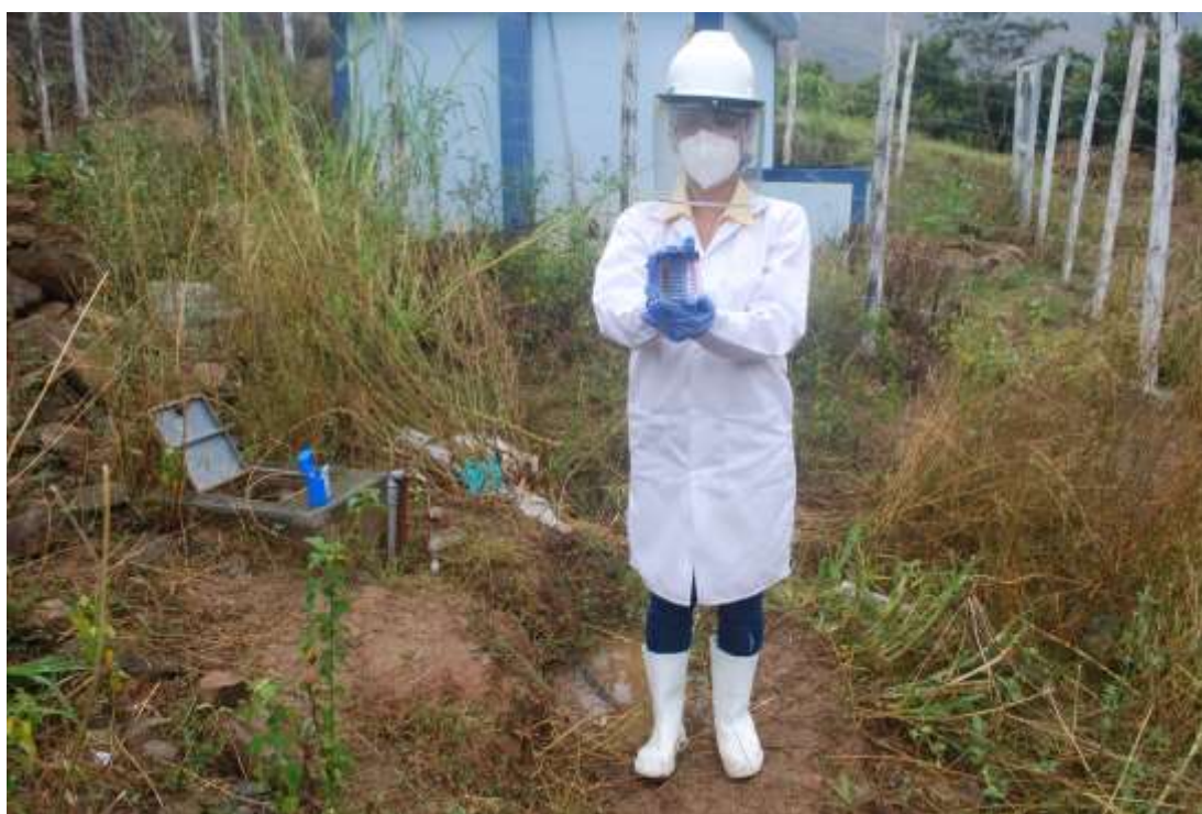
Figura 53. Control de cloro residual del agua del reservorio, haciendo uso del comparador de cloro manual.
