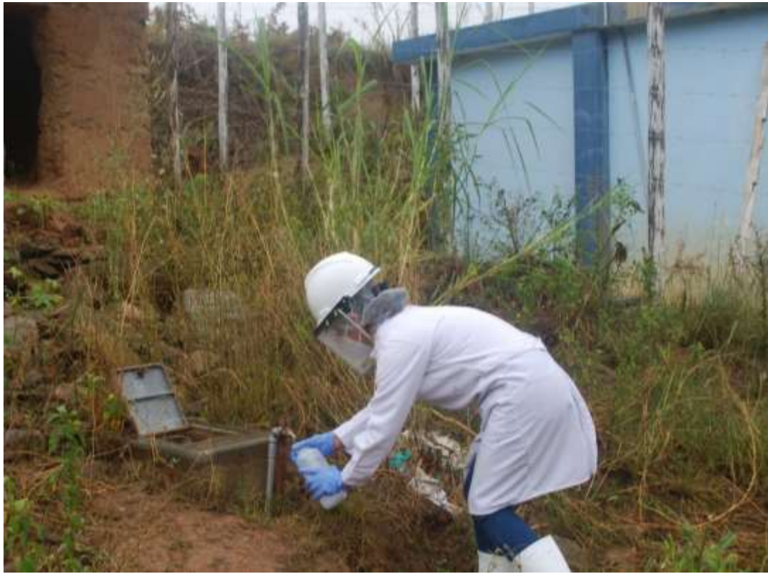
Figura 25. Toma de muestra de agua del Reservorio (Muestra N° 1).
