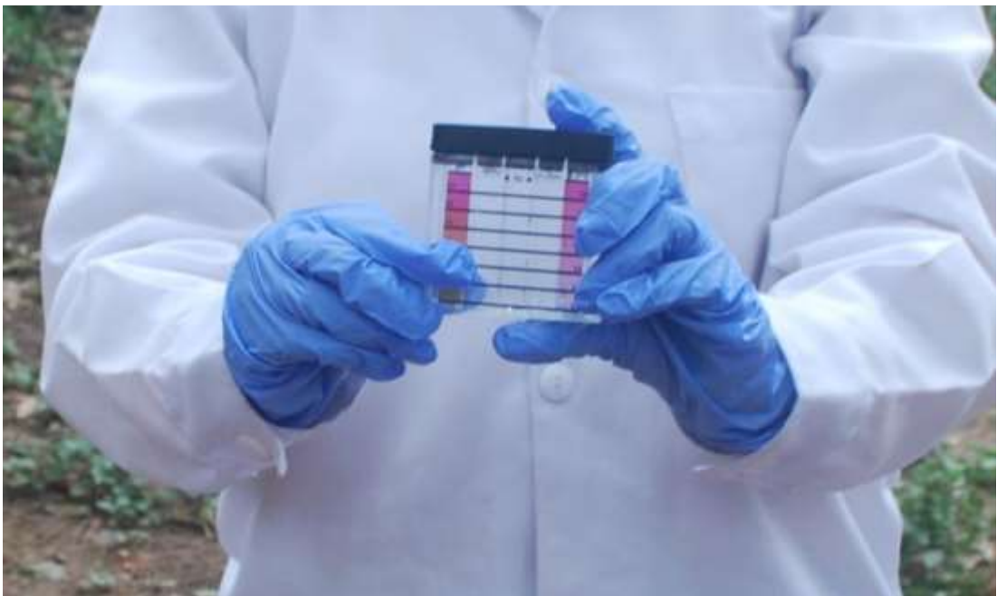
Figura 36. Control de cloro residual del agua de la última vivienda, haciendo uso del comparador de cloro manual.
