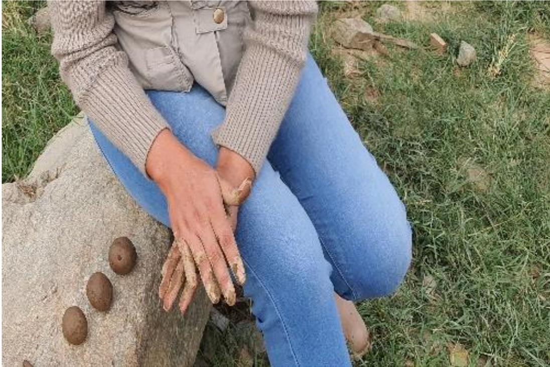
**Fotografía 3. Prueba de campo presencia de arcilla o resistencia seca para el agregado según la norma E.080**
