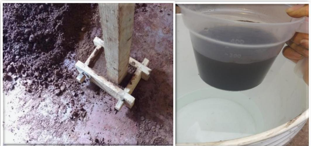
Fotografía N° 13: La dosificación 250ml 1m<sup>3</sup> de aditivo impermeabilizante perma- zyme.
