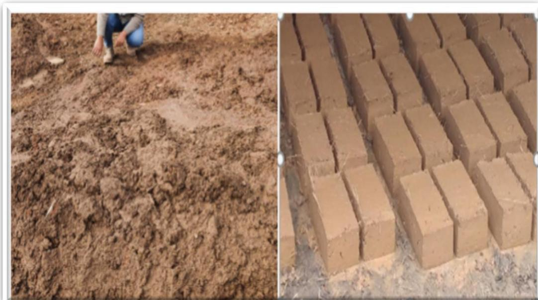
Fotografía N° 10: Preparación del barro y el dormido del barro para la fabricación de unidades de adobe tradicionales y su posterior secado por 28 días.
