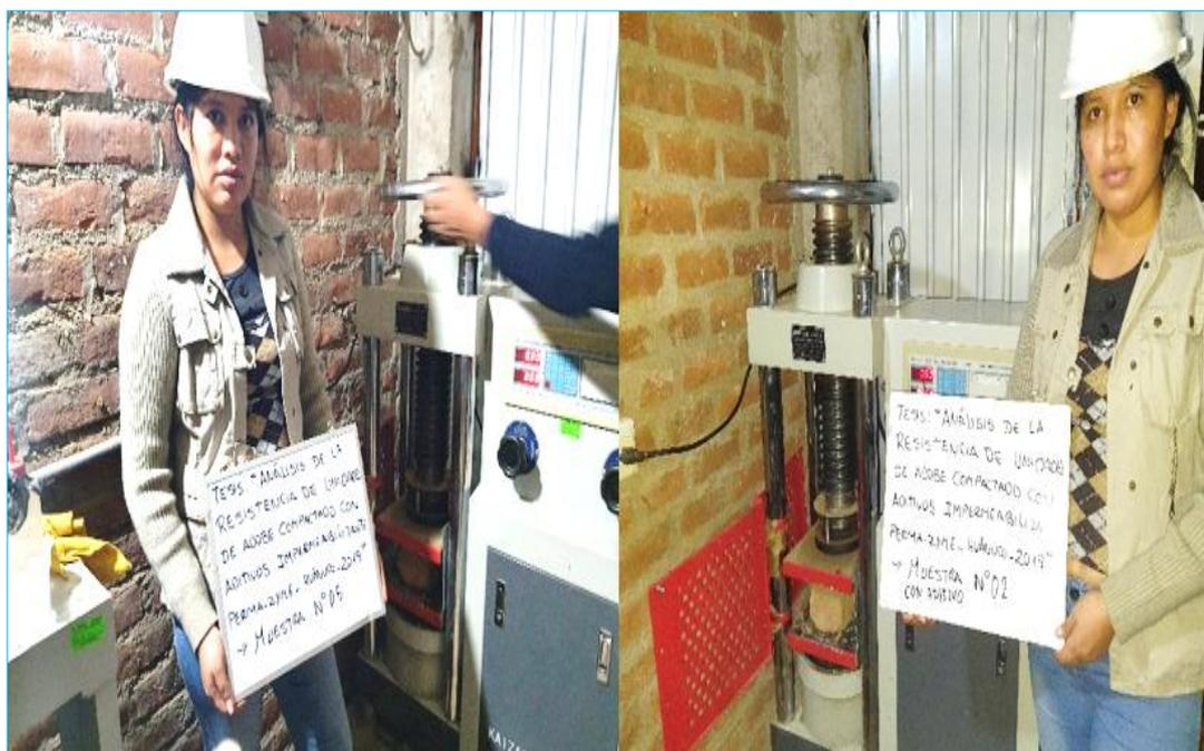
**Fotografía 12. Ensayo de resistencia a la compresión de las unidades de adobe tradicional y las unidades de adobe compactados según las dosificaciones de aditivo impermeabilizante perma-zyme**
