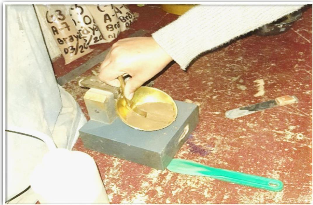
Fotografía N° 06: Se muestra el ensayo de Límites de Atterberg para determinar limite líquido de la muestra en el aparato de copa Casagrande y el ranurador.
