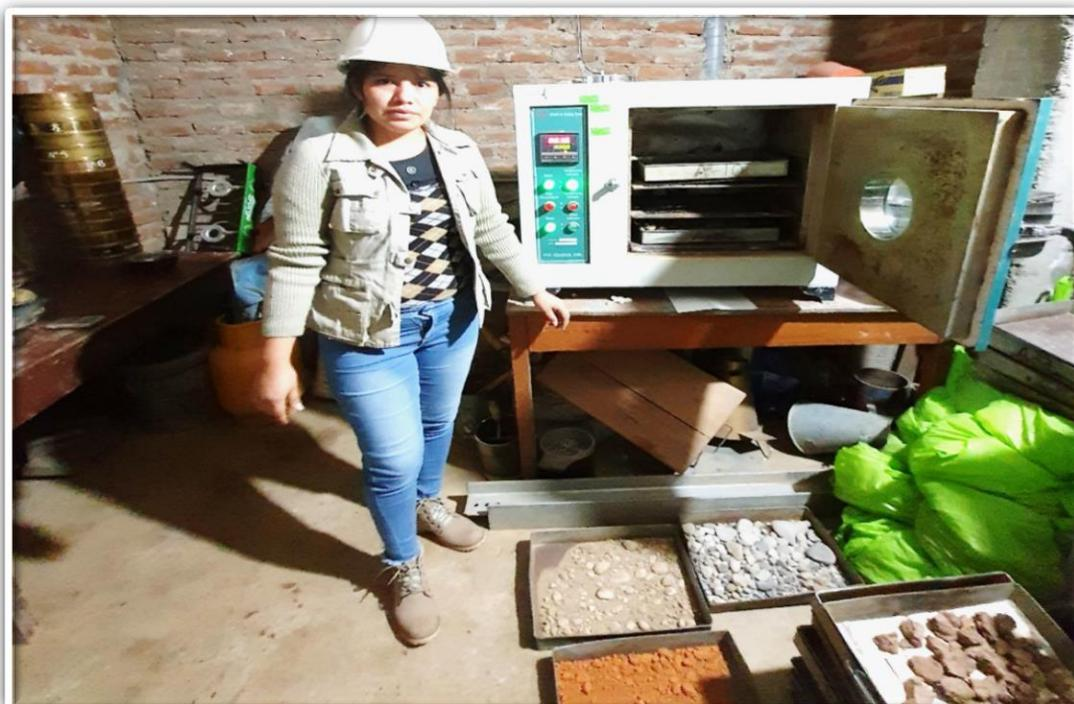
Fotografía N° 04: Colocación del material lavado en horno el por 24 horas de secado
