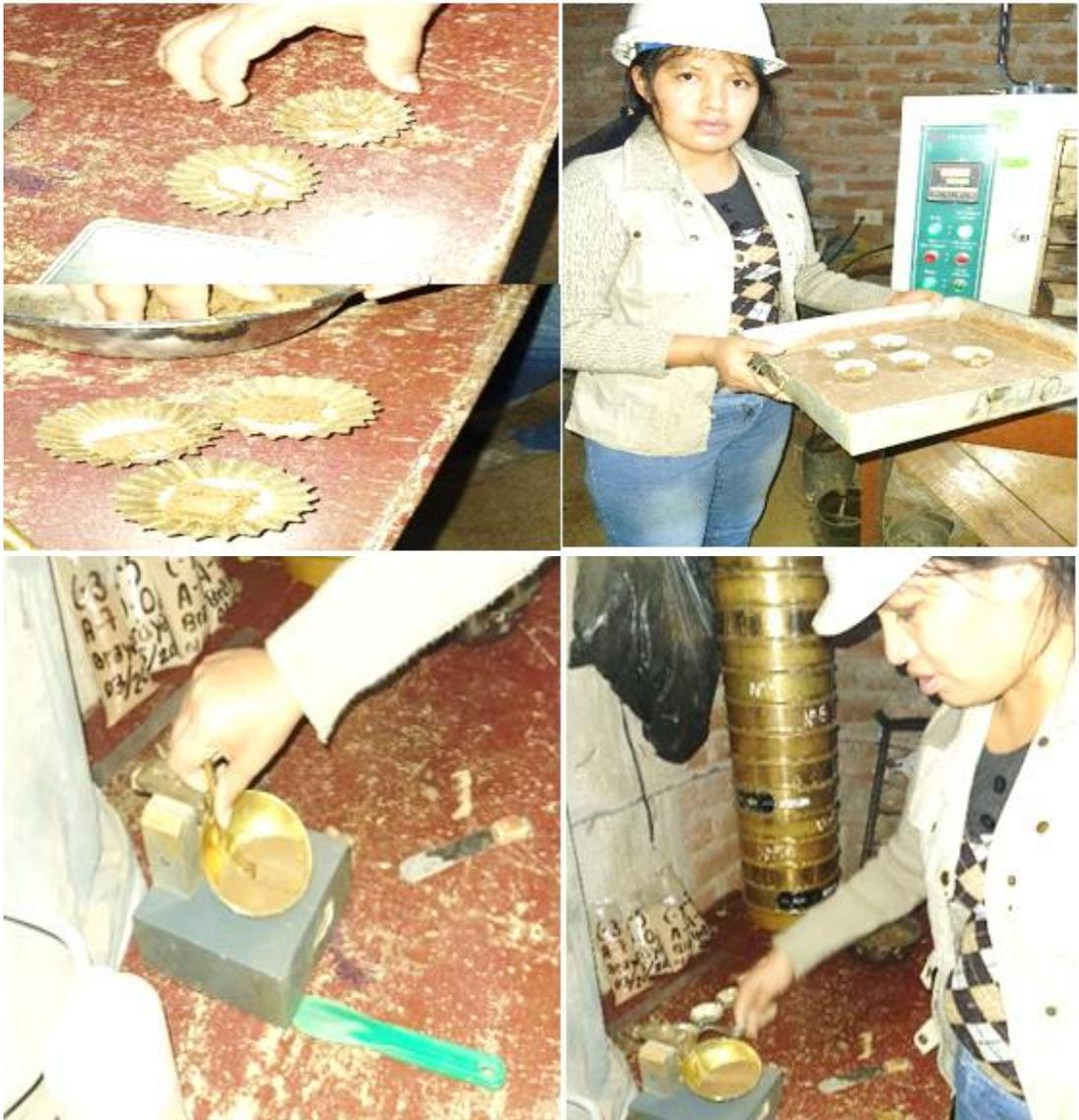
**Fotografía 6. El ensayo de Límites de Atterberg para determinar límite líquido y límite plástico de la muestra**
