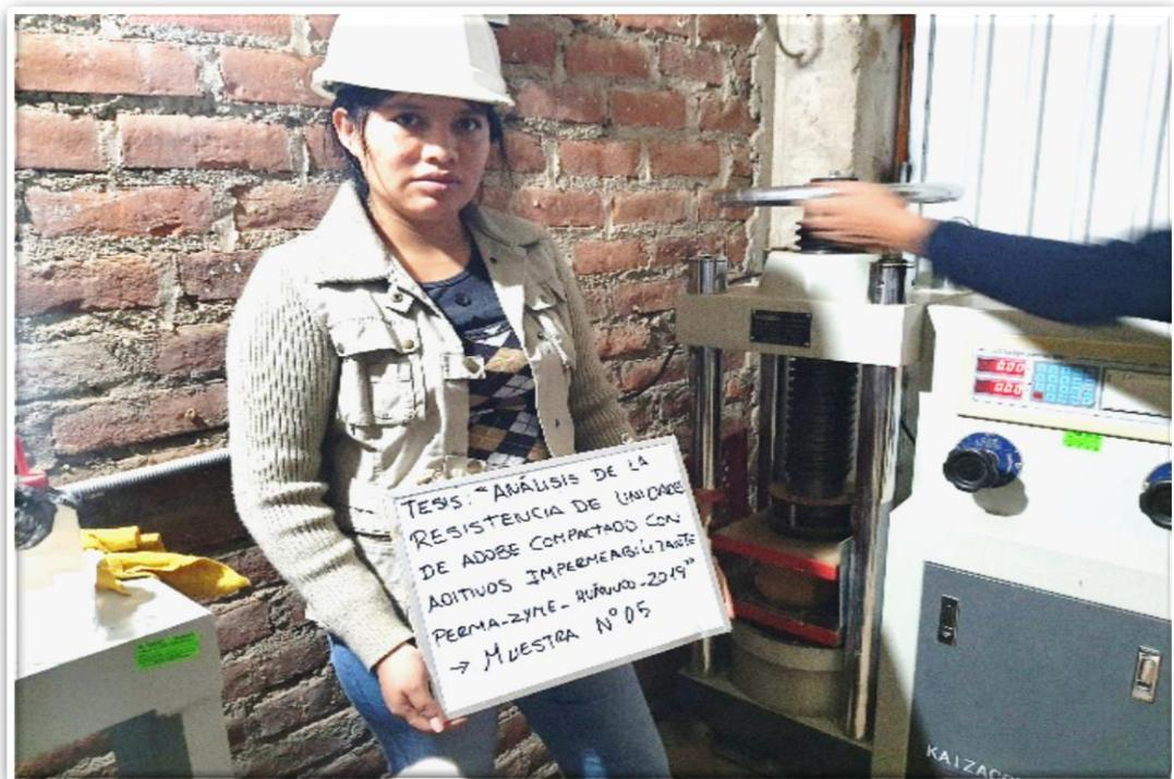
Fotografía N° 17: El ensayo de la resistencia a compresión de las unidades de la muestra n° 5 de adobe tradicional.
