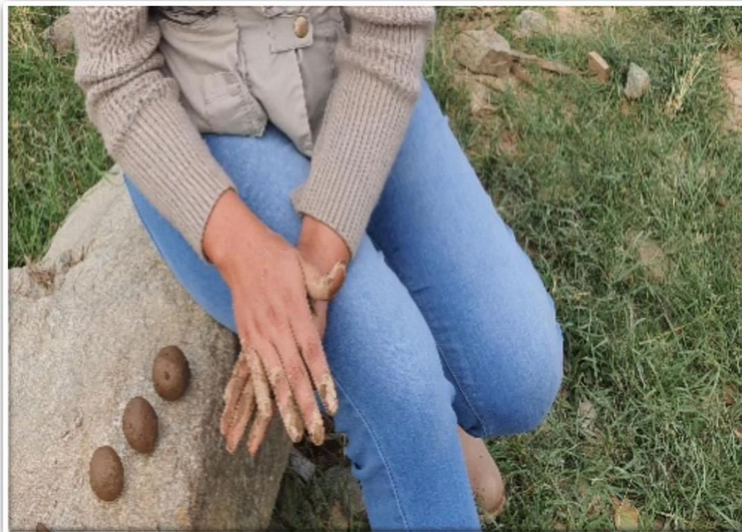
Fotografía N° 03: Prueba de la resistencia seca de la bolita según la norma E.080
