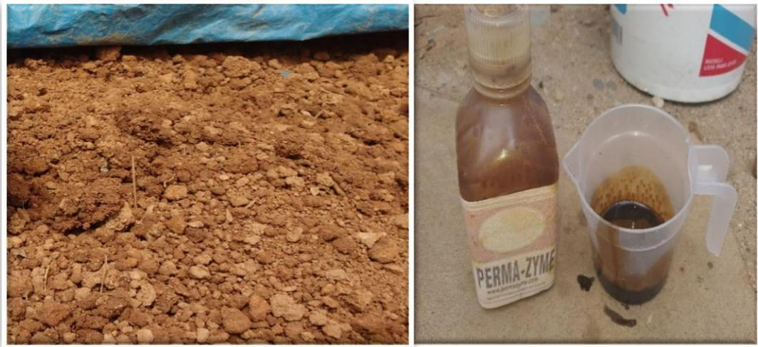
Fotografía N° 11: La dosificación de 100ml de aditivo impermeabilizante perma- zyme 1m<sup>3</sup> tierra.
