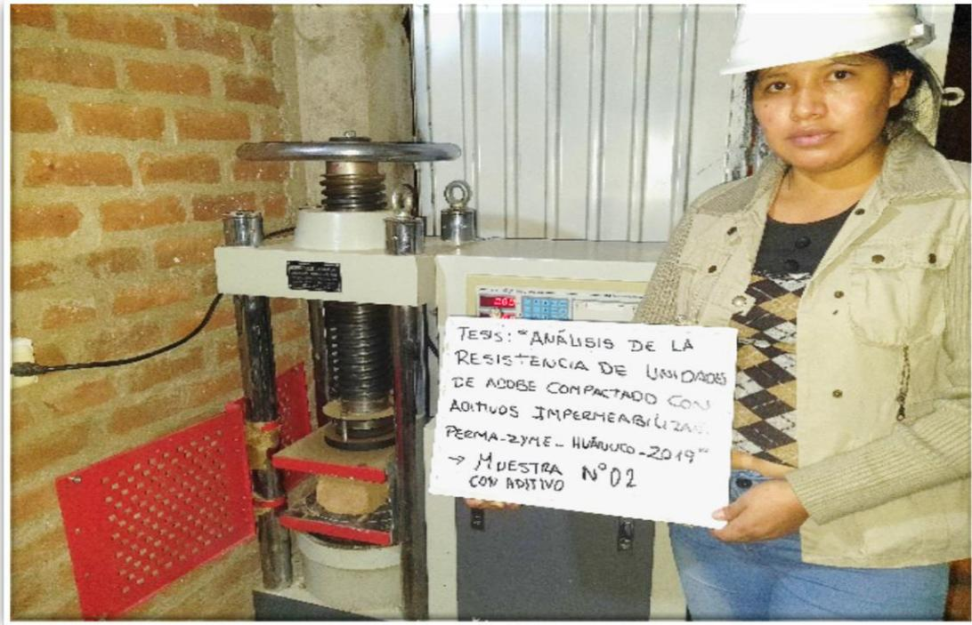
Fotografía N° 16: El ensayo de la resistencia a compresión de las unidades de la muestra n° 2 de adobe compactados según las dosificaciones de aditivo impermeabilizante perna-zyme.
