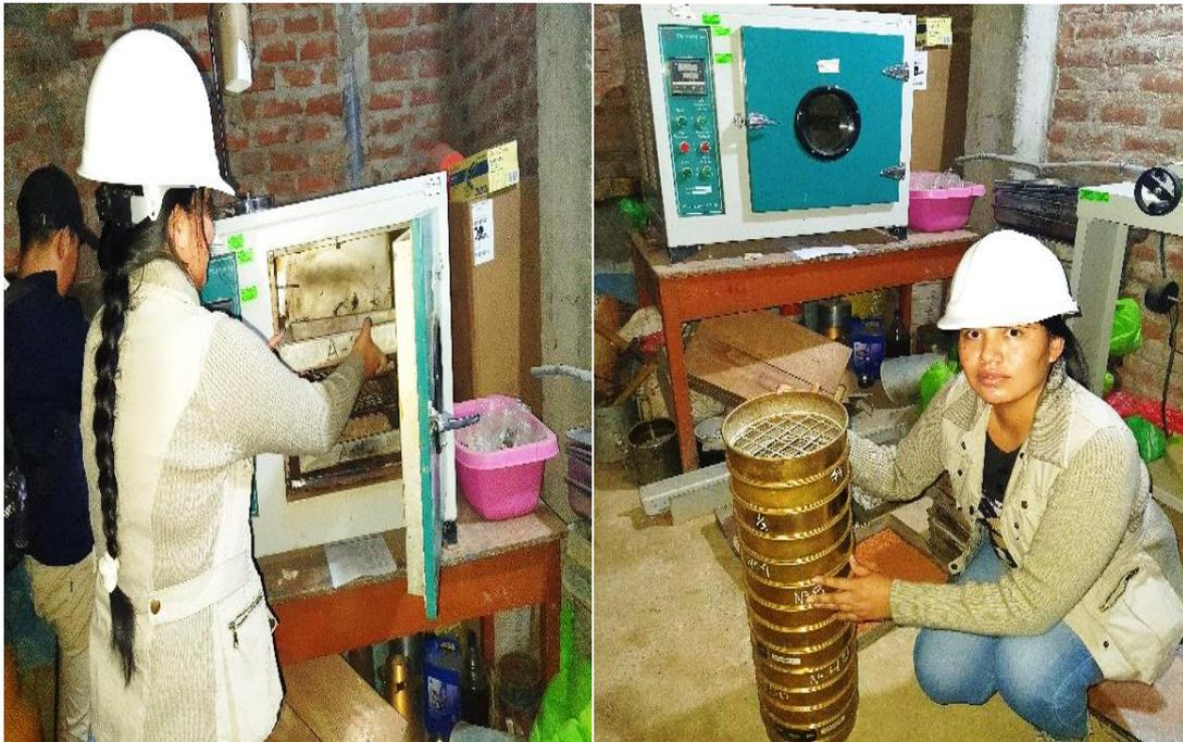
**Fotografía 4. Colocado en horno por 24 horas el material en una tara y posteriormente el tamizado por los juegos de tamices.**
