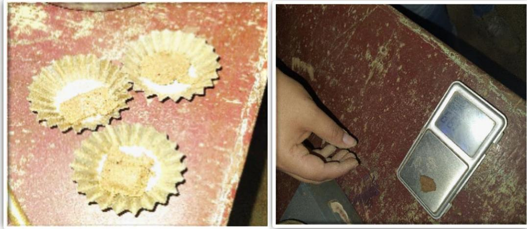
Fotografía N° 07: Se aprecia las muestras en las taras antes de colocar al horno el pesaje para determinar limite líquido.
