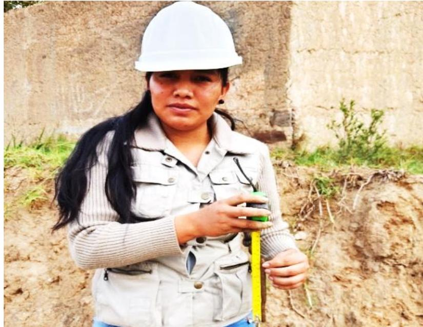
**Fotografía 2. Prueba de campo Cinta de mano evaluación de existencia de arcilla para el agregado según la norma E.080.**
