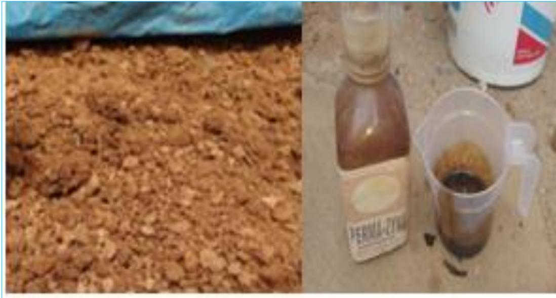
**Fotografía 8. La selección de 1m<sup>3</sup> de tierra y la dosificación de 100ml de aditivo impermeabilizante perma-zyme**
