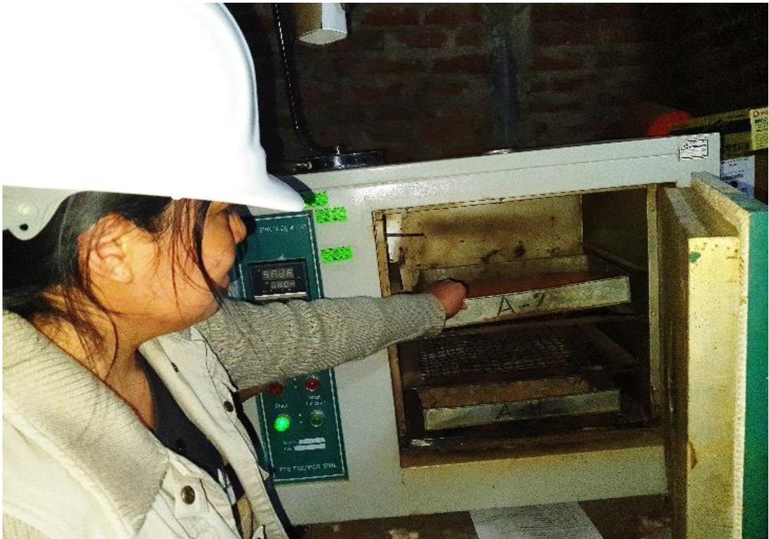
**Fotografía 5. Colocación de las muestras al horno por 24 horas para obtener el contenido de humedad.**
