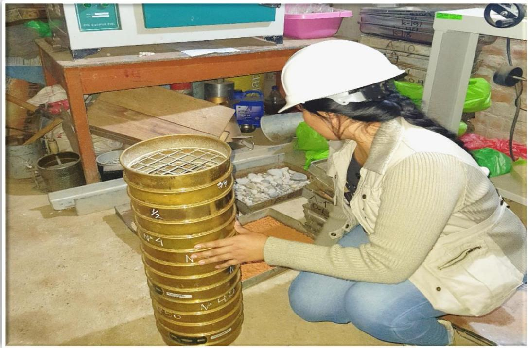
Fotografía N° 05: El tamizado para el análisis granulométrico
