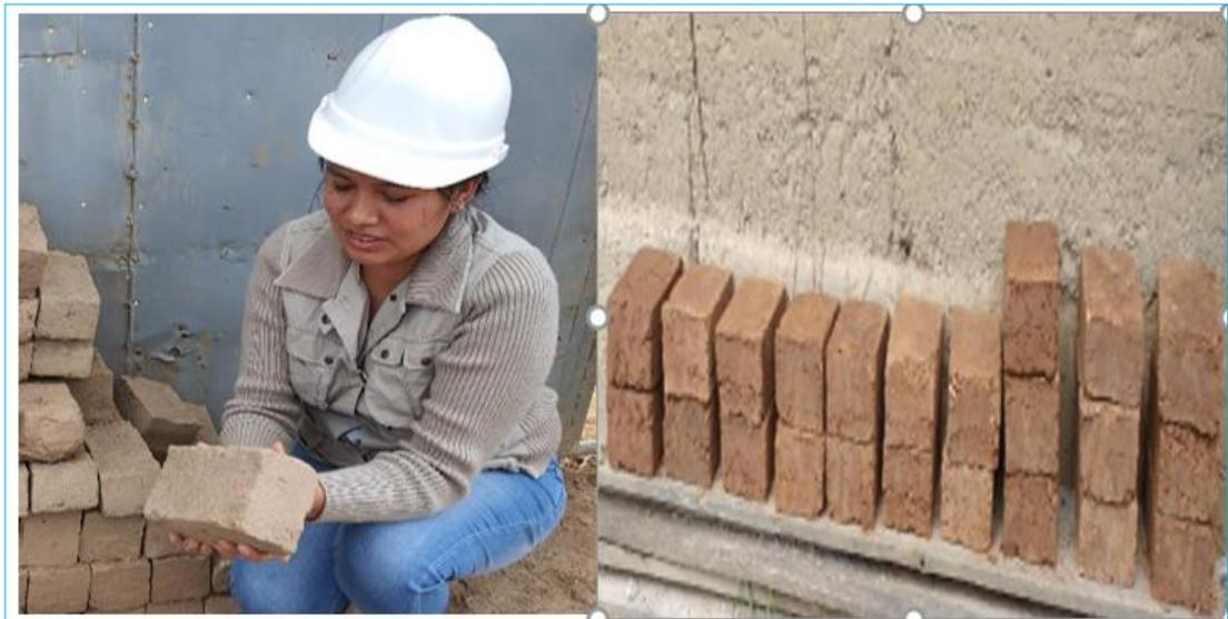
**Fotografía 11. Adobes de diferentes especímenes de aditivo impermeabilizante perma-zyme.**
