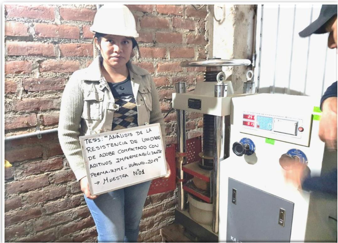
Fotografía N° 15: El ensayo de la resistencia a compresión de las unidades de adobe tradicional y las unidades de adobe compactados según las dosificaciones de aditivo impermeabilizante perna-zyme.
