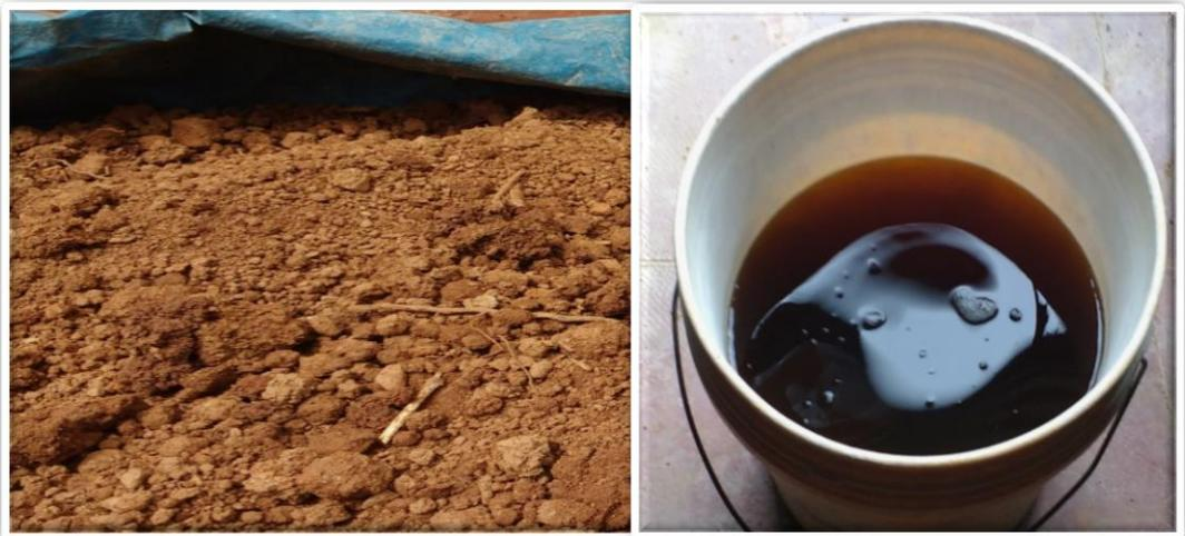
Fotografía N° 12: La dosificación 150ml de aditivo impermeabilizante perma- zyme diluido en 18 litros de agua.
