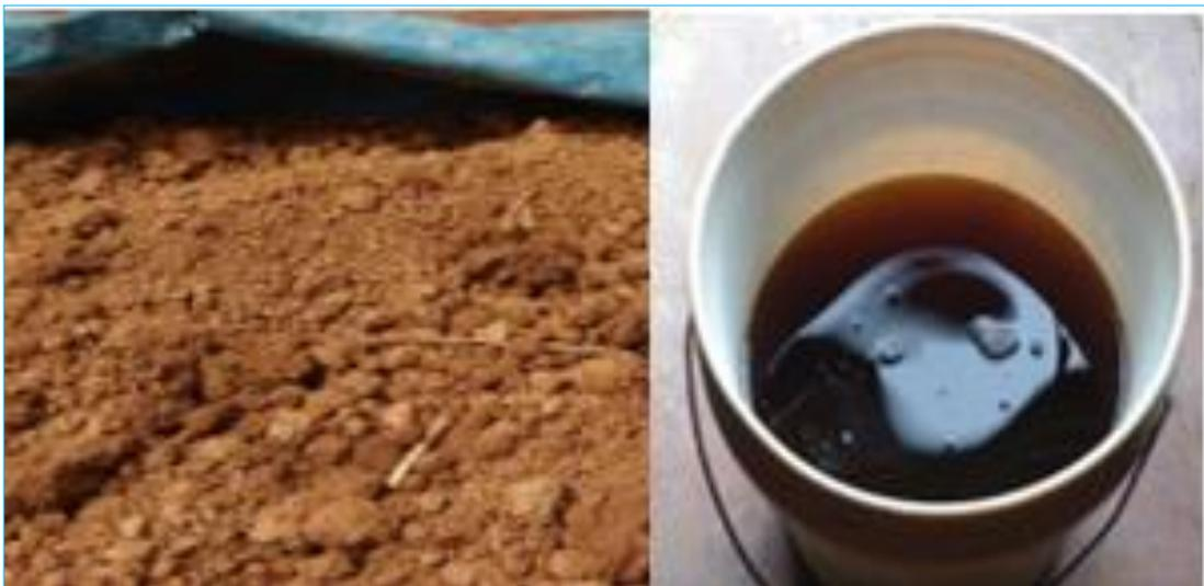
**Fotografía 9. Selección de 1m<sup>3</sup> de tierra y la dosificación de 150ml de aditivo impermeabilizante perma-zyme diluido en agua.**
