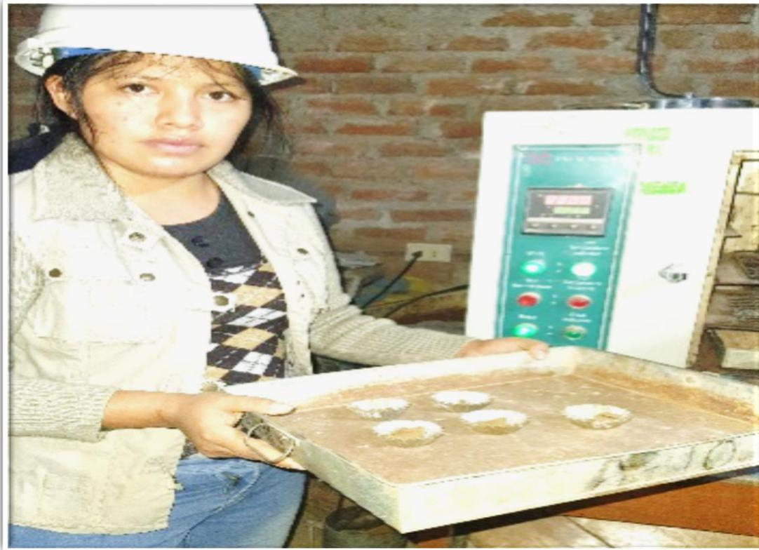
Fotografía N° 09: La colocación en el horno por 24 horas las muestras para calcular su peso seco.
