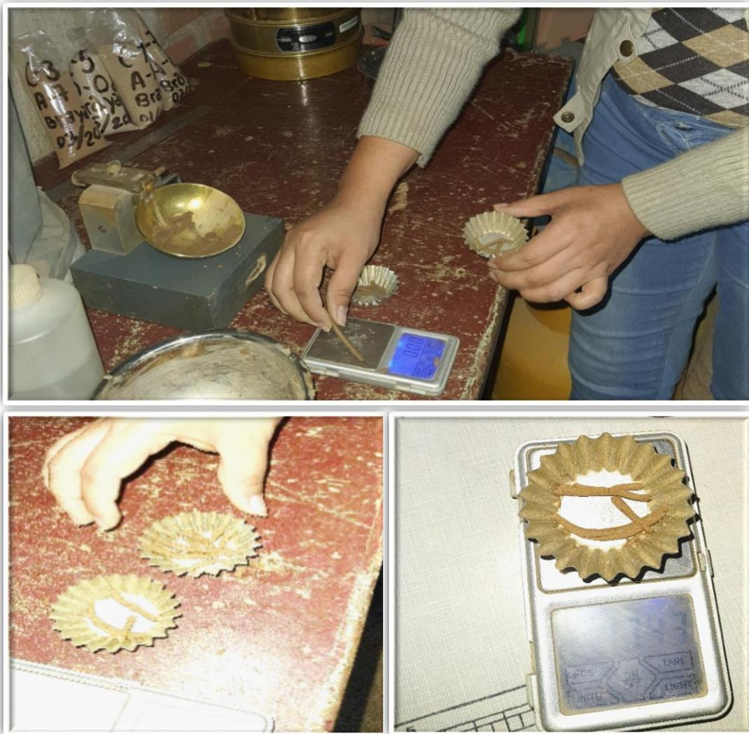
Fotografía N° 08: Se muestra el ensayo de Límites de Atterberg para determinar limite plástico.
