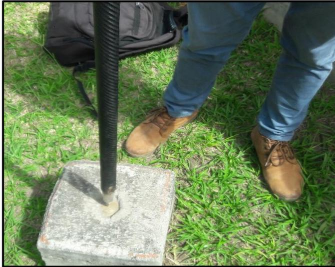
Colocación del equipo GPS diferencial sobre el elemento identificable para dar inicio a la calibración de lectura de la cota base (BM).
