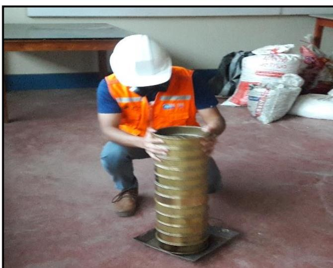
Tamizado de muestras en diferentes mallas mediante el método manual.
