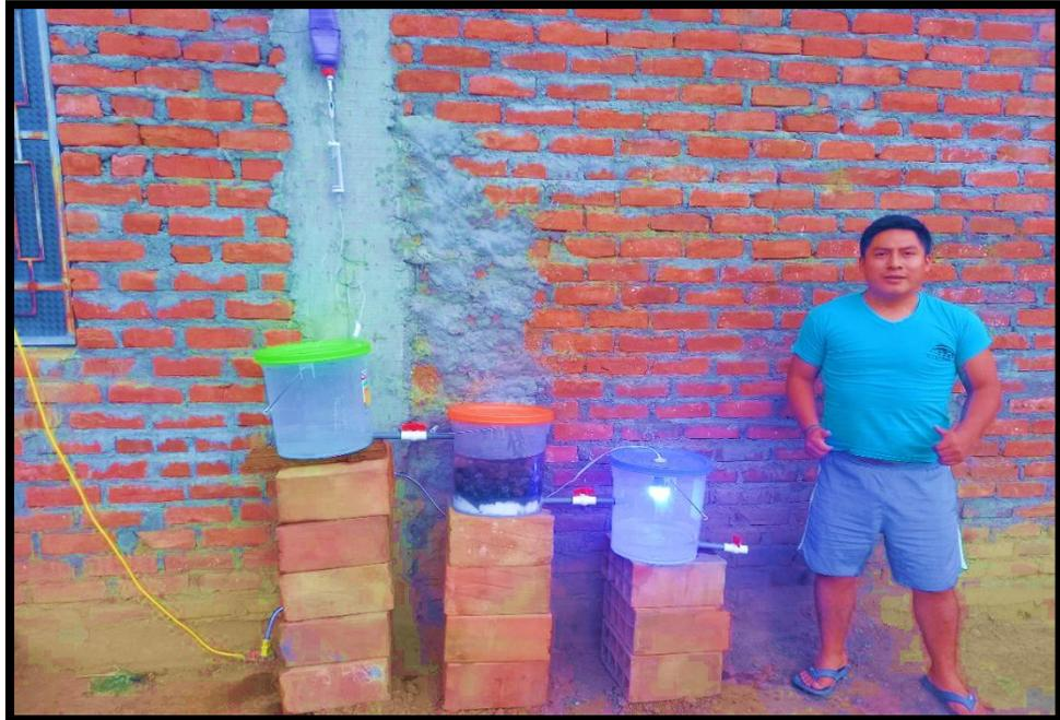
5. Realizar la instalación de la maqueta para la recepción del agua, esperar que el agua siga el curso del tratamiento y tomar las muestras correspondientes para el análisis al laboratorio.
