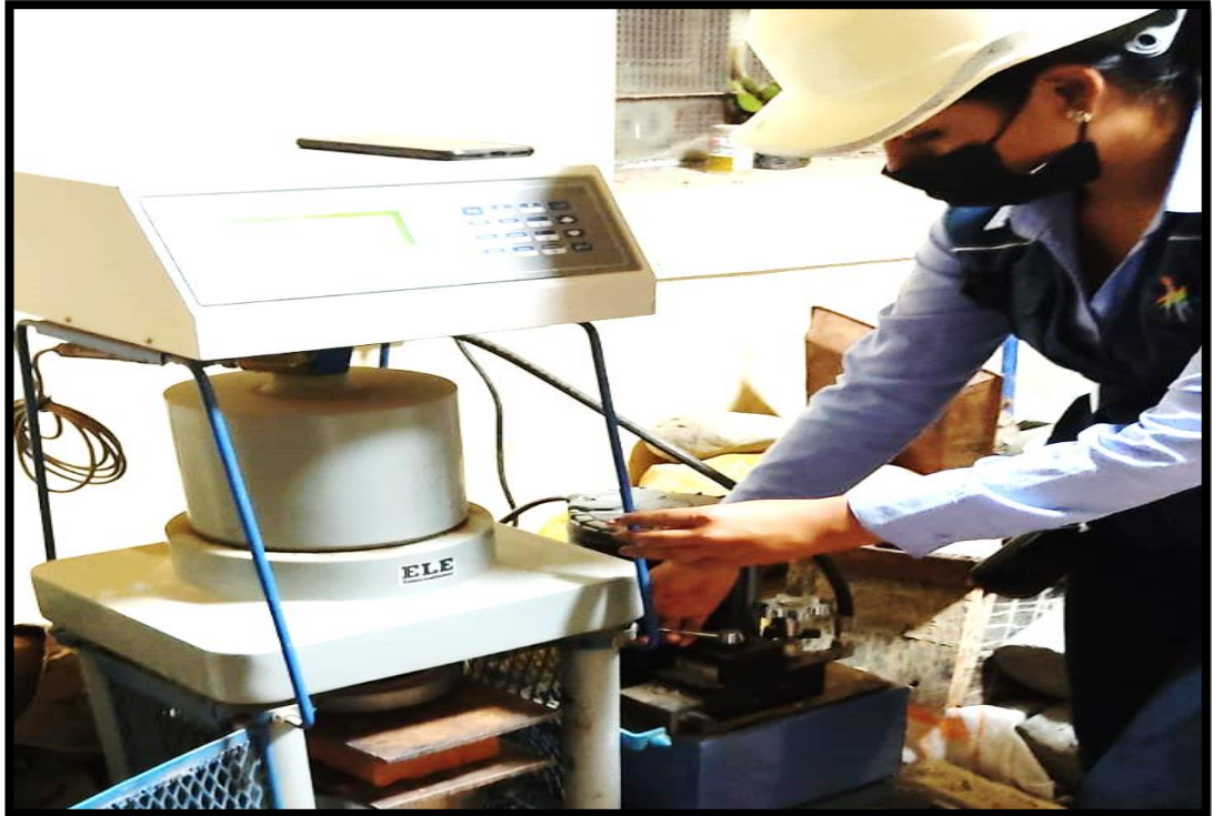
Foto 19: Preparamos el equipo de PRENSA CBR de compresión.
