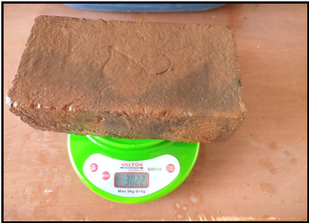
Foto 24: Peso saturado de ladrillo ecológico.
