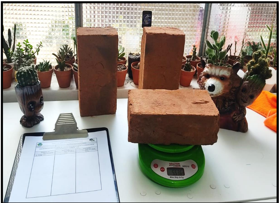
Foto 22: Peso seco del ladrillo ecológico.
