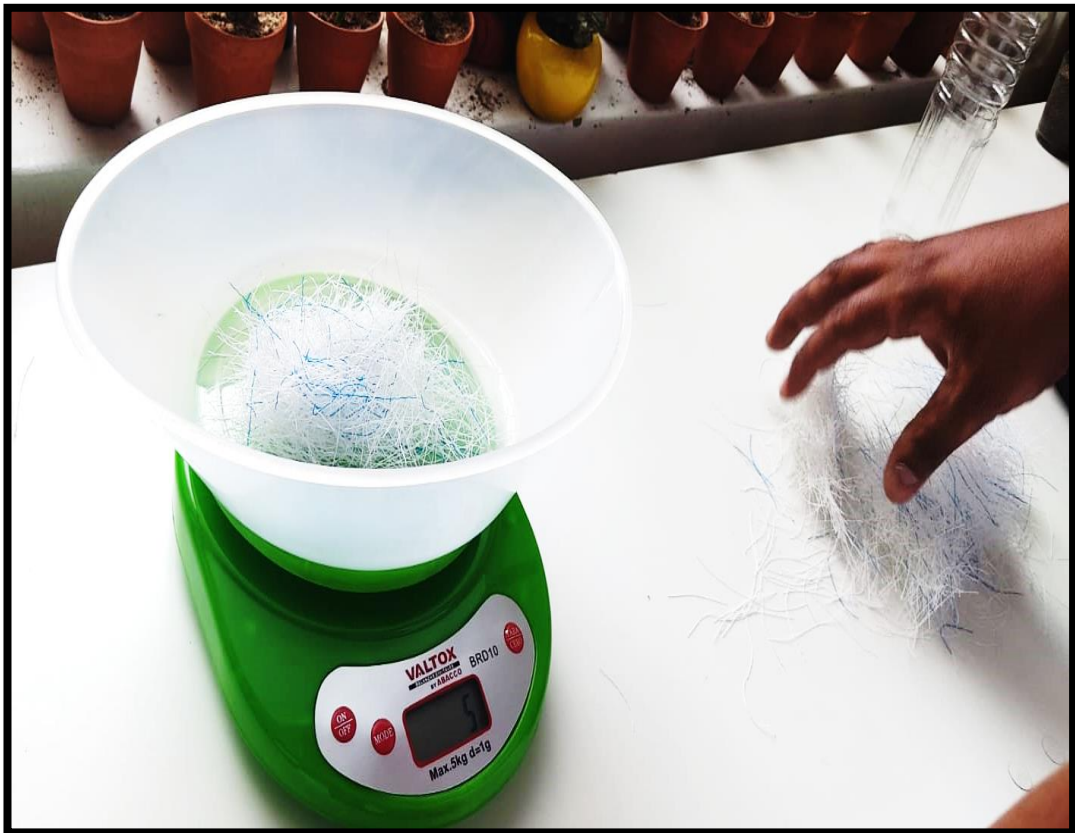
Foto 4: Pesar las concentraciones de Fibras de plásticos PET
