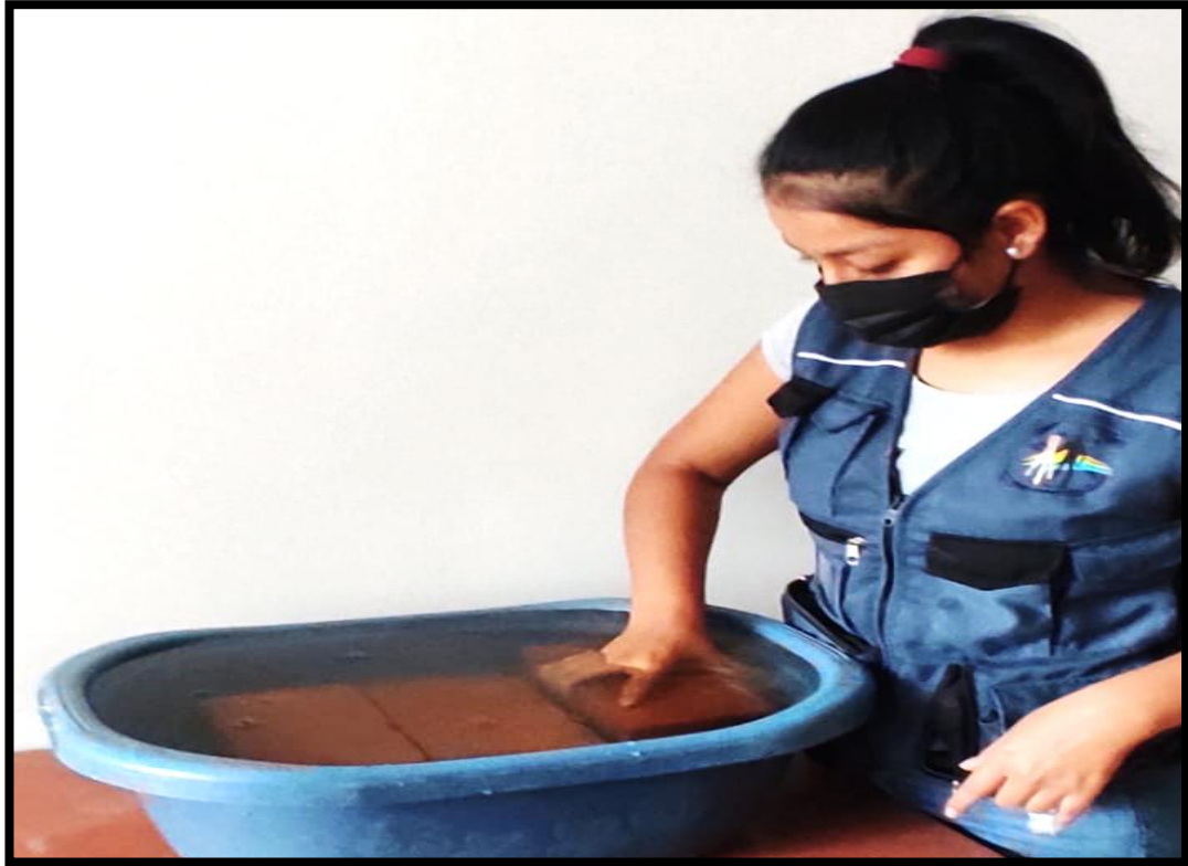
Foto 23: Prueba de adsorción – ladrillos sumergidos por 24h.
