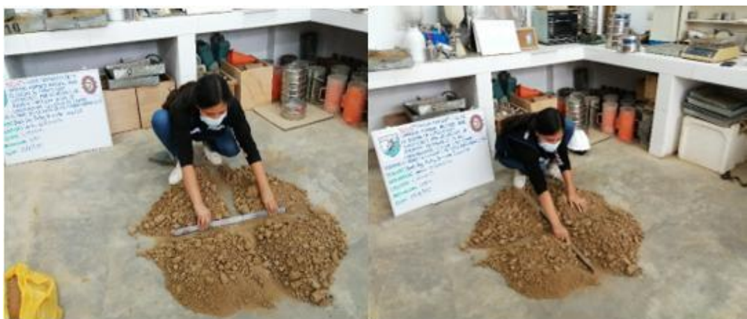
Foto N°10. Se realiza el cuarteo de la muestra.
