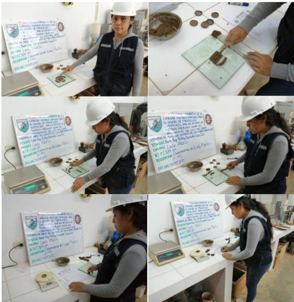
Foto N°19. Determinación del Límite Plástico.
