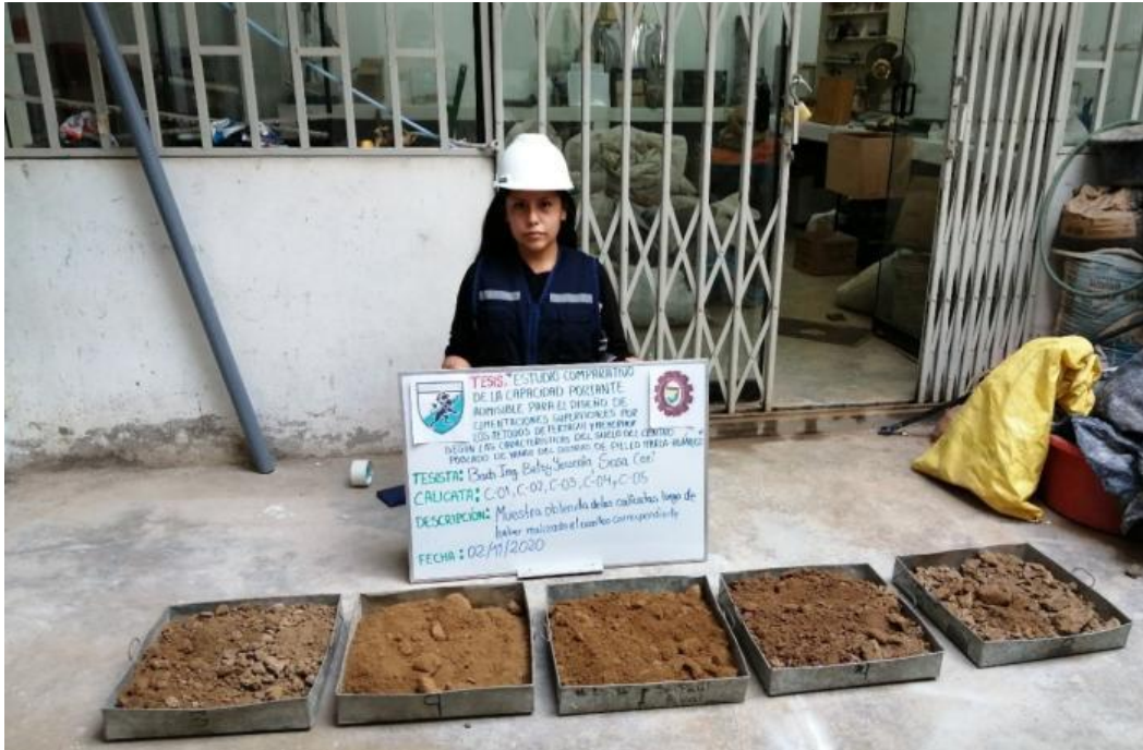
Foto N°11. Muestras obtenidas de las calicatas luego de haber realizado el cuarteo correspondiente.
