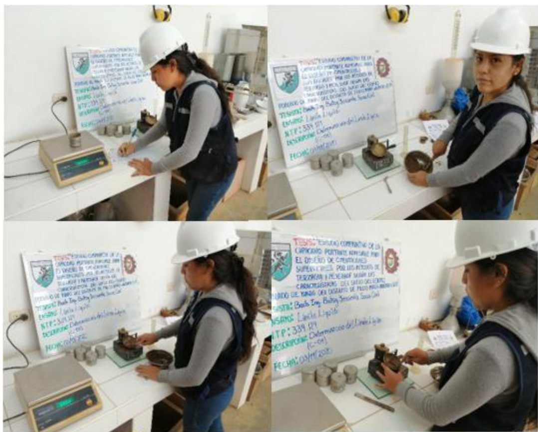
Foto N°17. Determinación del Límite Líquido.
