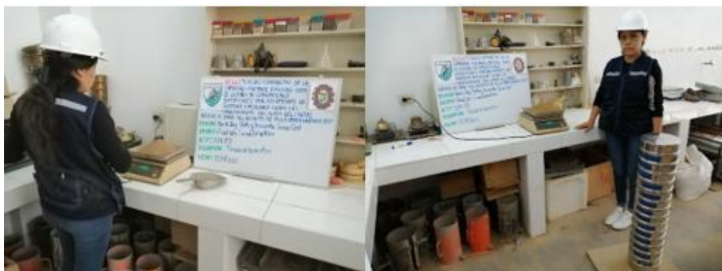
Foto N°13. Peso de la muestra para comenzar a realizar el ensayo de análisis granulométrico.
