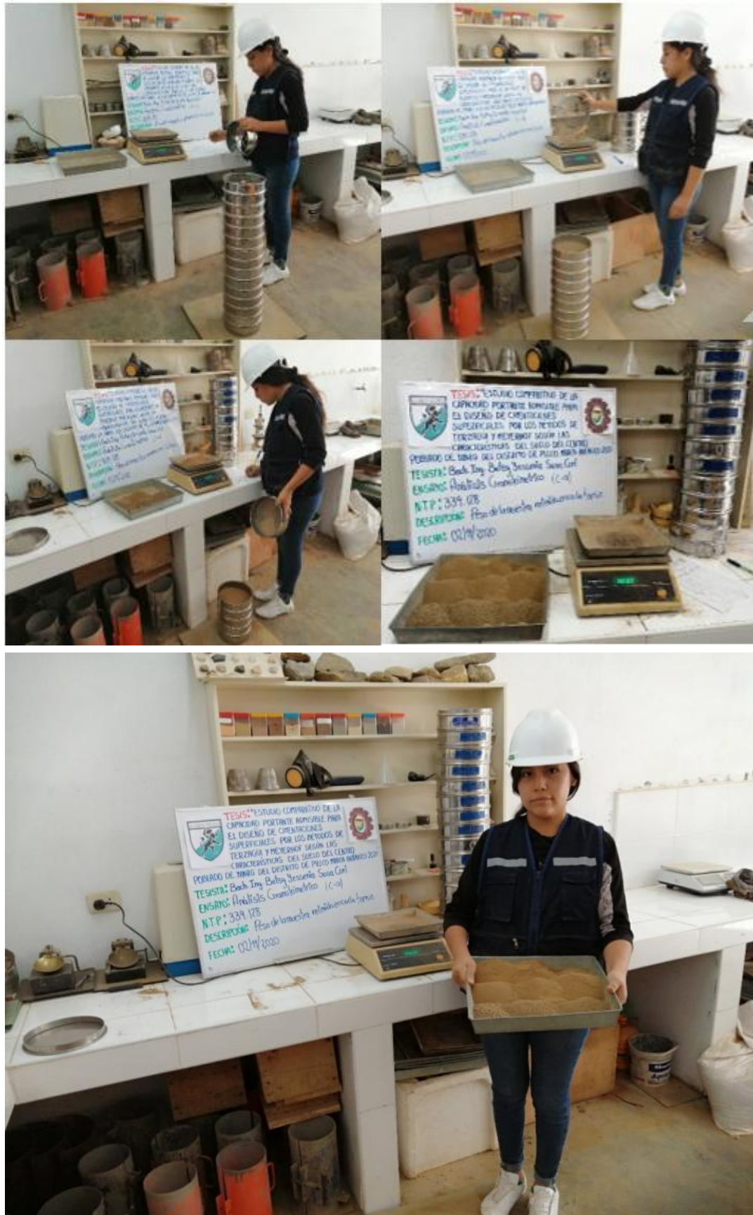
Foto N°15. Peso de la muestra retenida en cada tamiz
