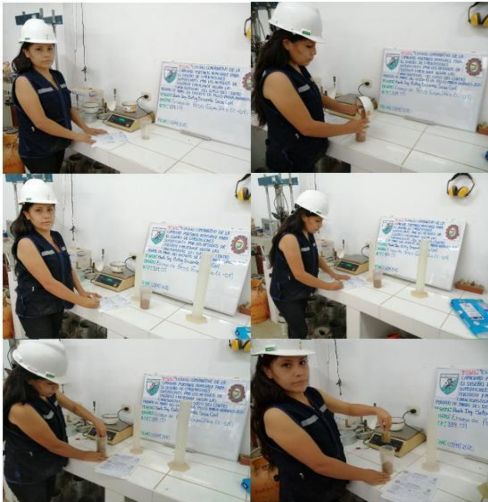
Foto N°21. Determinación del Peso Específico
