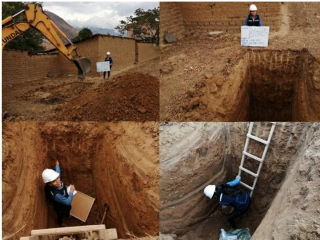
Foto N°04. En las fotografías se aprecia el reconocimiento directo del terreno, así como la toma de muestras de la calicata N°02.
