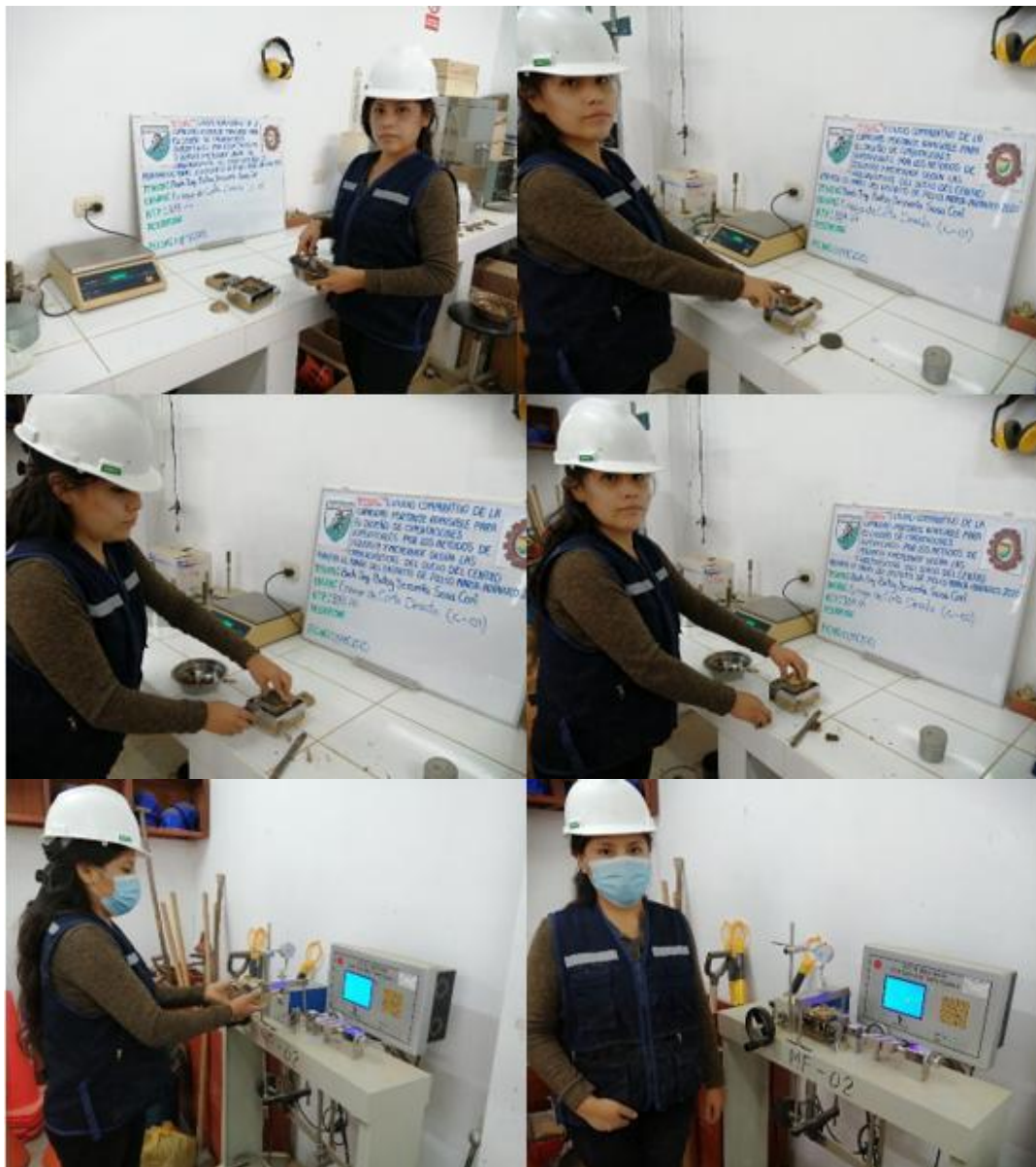
Foto N°22. Ensayo de Corte Directo.
