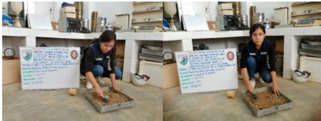
Foto N°12. Triturado de la muestra, para que las porciones de la muestra a la hora de realizar el ensayo de análisis granulométrico puedan pasar las mayas.
