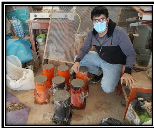
**Anexo 25:** Curado de las probetas de concreto.
