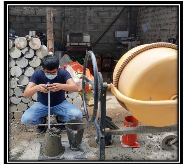
**Anexo 24: Elaboración de las probetas de concreto.**
