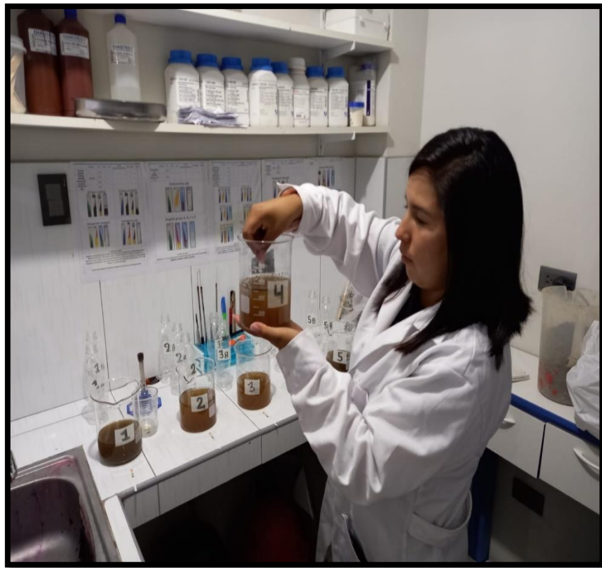
Fotografía 8: Muestras Hipoclorito de Sodio, se puede evidenciar que el color en cada muestra es diferente por la variación de dosis
