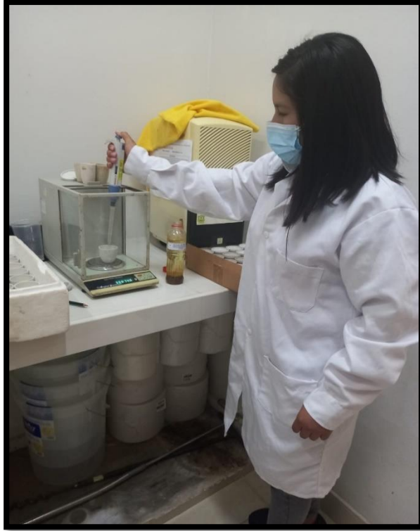
Fotografía 9: Peso de solución para determinar metales pesados en el espectrofotómetro
