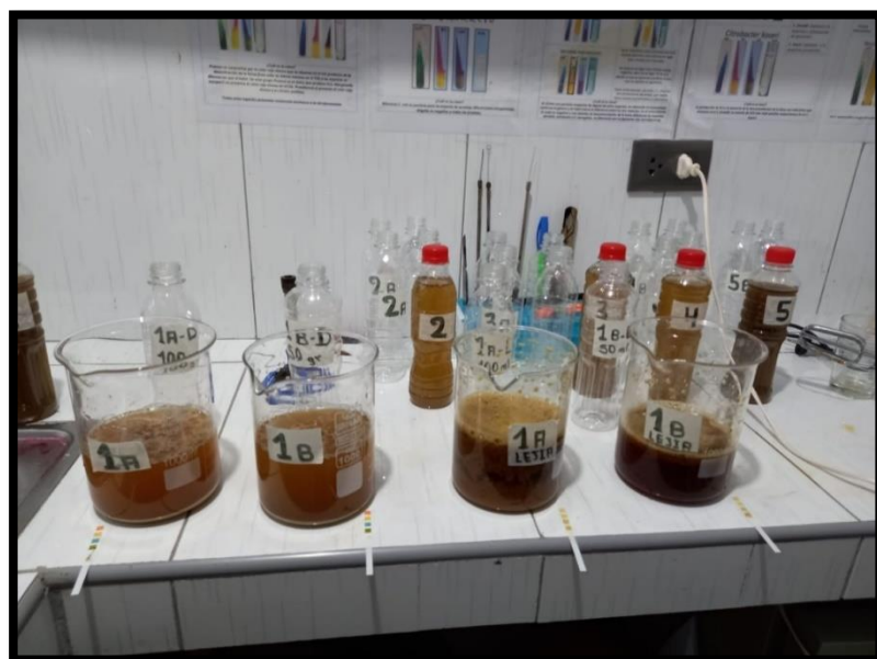
Fotografía 8: Muestras Hipoclorito de Sodio, se puede evidenciar que el color en cada muestra es diferente por la variación de dosis
