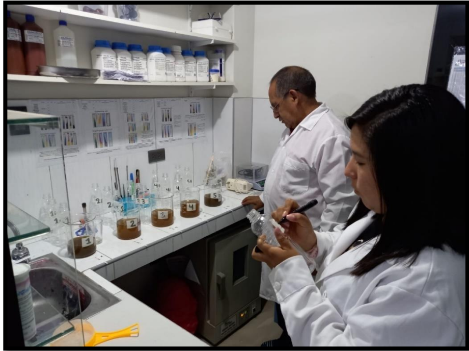
Fotografía 6: Lectura del pH de las muestras en el laboratorio
