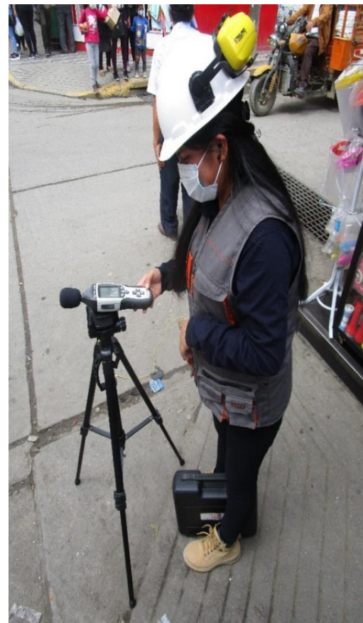
Fotografía N°01,02,03,04.- Armado del Trípode y sonómetro
