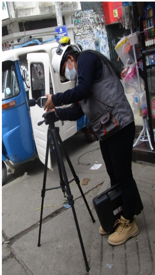
Fotografía N°01,02,03,04.- Armado del Trípode y sonómetro
