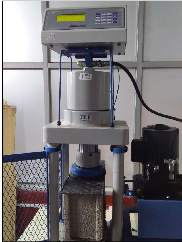
Fotografía 42 Bloques de concreto sometidos al ensayo de compresión en el laboratorio de la Universidad de Huánuco
