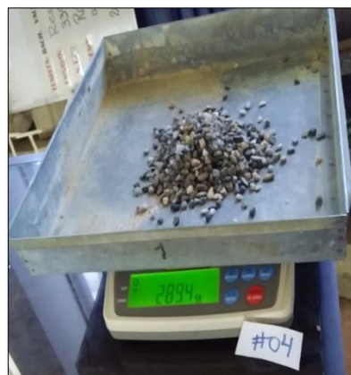
Fotografía 9 Peso del agregado retenido en la malla N°4
