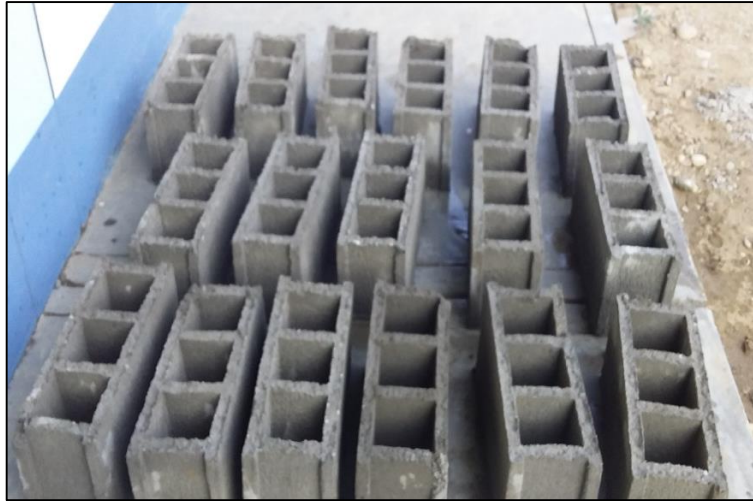
Fotografía 36 Bloques de concreto elaborados en forma manual
