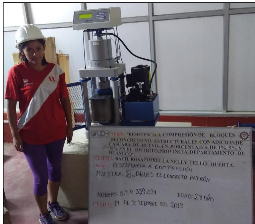
Fotografía 49 Bloques de concreto patrón sometidos al ensayo de compresión a la edad de 28 días
