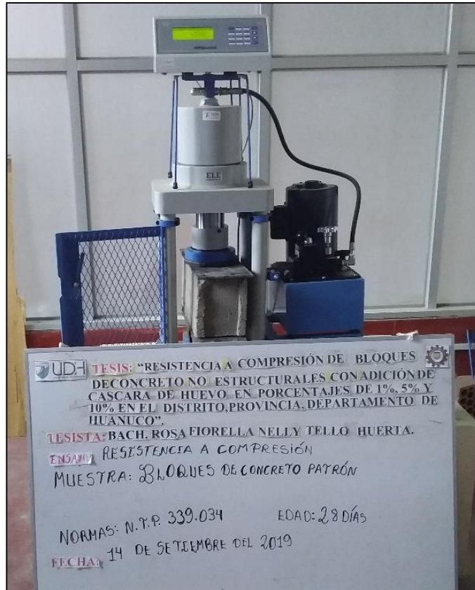
Fotografía 48 Bloques de concreto patrón sometidos al ensayo de compresión a la edad de 28 días
