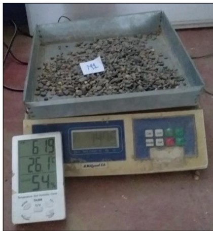
Fotografía 16 Peso natural húmedo del agregado grueso utilizando la balanza eléctrica de 30 kg
