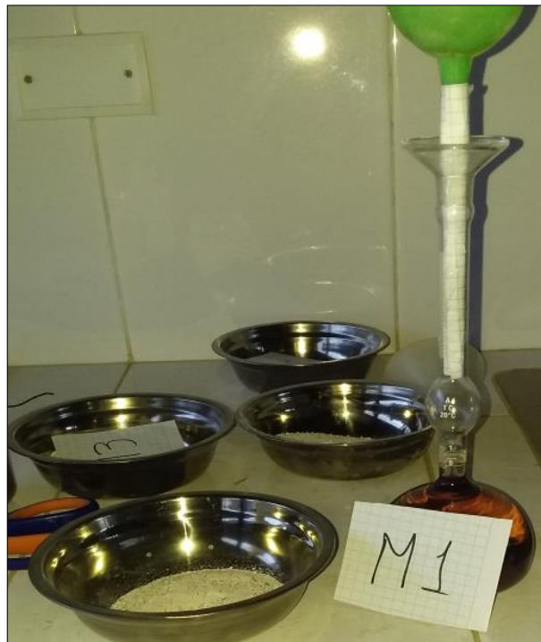
Fotografía 28 Determinación de la densidad de la cáscara de huevo para lo cual se pesó tres muestras de 64 gr de cáscara de huevo, gasolina, frasco Le Chatelier y termómetro digital
