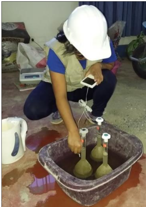
Fotografía 22 Ensayo de densidad relativa del agregado fino para lo cual se utilizó picnómetros de 500 ml, hervidora eléctrica y termómetro digital para controlar la temperatura del agua
