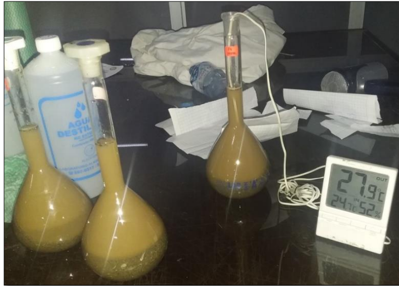
Fotografía 23 Picnómetros de 500 ml con las muestras de agregado fino los cuales fueron colocadas posteriormente en taras para ser llevadas al horno electrico por un periodo de 24 horas a una temperatura de 110^{\circ}\text{C} \pm 5^{\circ}\text{C}
