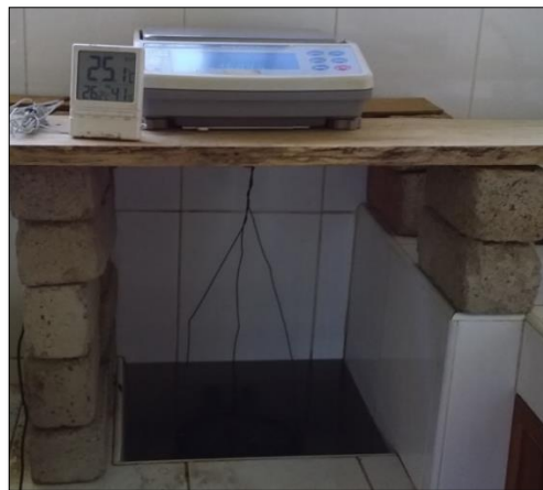
Fotografía 24 Ensayo de densidad relativa del agregado grueso por el método de gravedad específica para lo cual se utilizó la balanza eléctrica de 30kg, termómetro digital, alambre N°16 y la malla N°04
