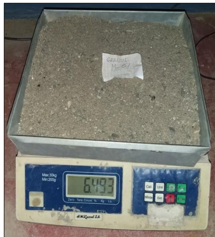
Fotografía 6 Peso de las muestras en estado seco del agregado global
