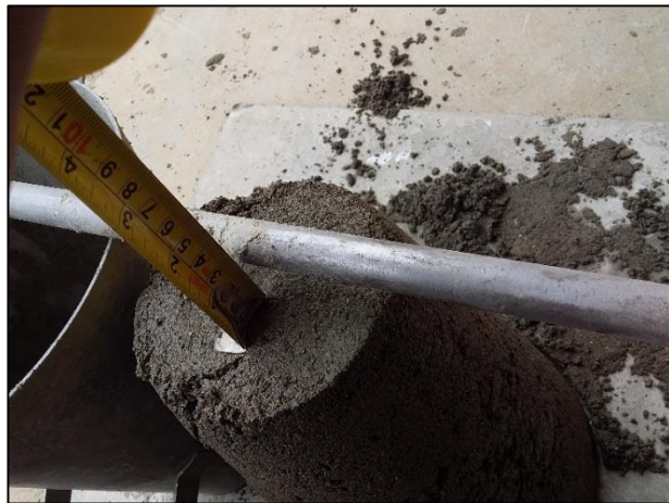
Fotografía 37 Medición del SLUMP del concreto donde se obtuvo un asentamiento de 1"
