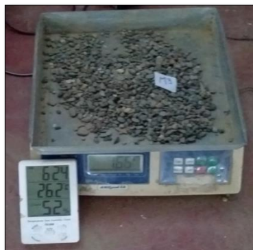
Fotografía 17 Peso natural húmedo del agregado grueso utilizando la balanza eléctrica de 30 kg
