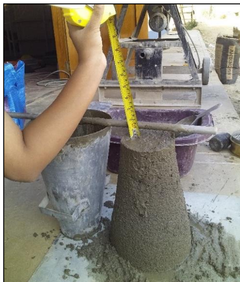
Fotografía 38 Medición del SLUMP del concreto donde se obtuvo un asentamiento de 1"
