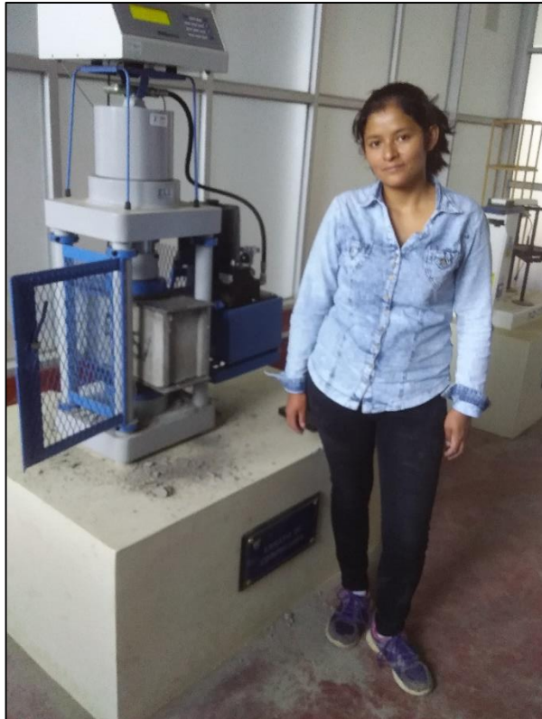
Fotografía 44 Bloque de concreto con adición de cáscara de huevo al 5% sometido a fuerzas axiales de compresión a la edad de 7 días
