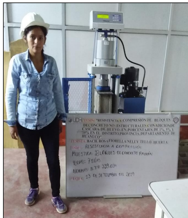
Fotografía 45 Bloques de concreto patrón sometidos al ensayo de compresión a la edad de 7 días
