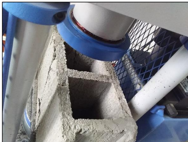
Fotografía 43 Falla del bloque de concreto se puede apreciar las fisuras en la parte central
