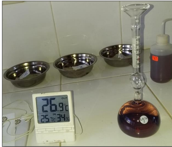
Fotografía 25 Determinación de la densidad del cemento para lo cual se utilizo tres muestras de 64 gr, gasolina, termómetro digital y frasco Le Chatelier
