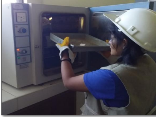
Fotografía 15 Colocación de las muestras de agregado fino en el horno eléctrico por un período de 24 horas a una temperatura de 110^{\circ}\text{C} \pm 5^{\circ}\text{C} para determinar el contenido de humedad de la muestra
