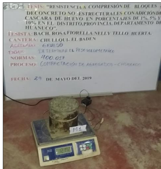
Fotografía 14 Peso del agregado grueso varillado utilizando la balanza eléctrica de 30kg y un termómetro digital para controla la temperatura y humedad del medio ambiente
