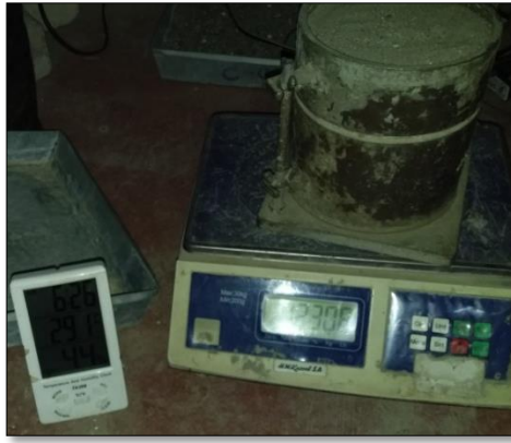
Fotografía 13 Peso del agregado fino varillado utilizando la balanza eléctrica de 30kg y un termómetro digital para controla la temperatura y humedad del medio ambiente
