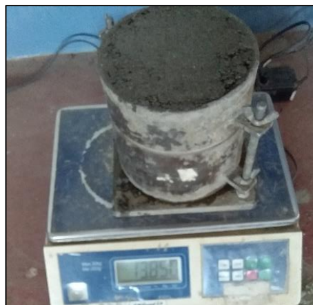
Fotografía 41 Peso volumétrico del concreto el procedimiento es similar al del peso volumétrico de los agregados, donde emplea la varilla de acero liso de 5/8", balanza de 30kg y vasija volumétrica de 1/10 ft 3
