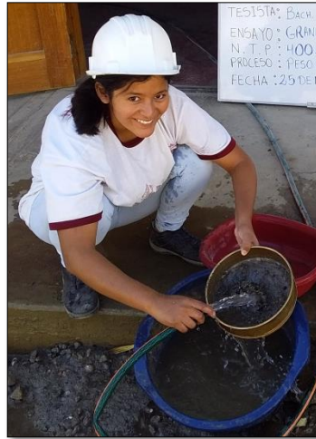
Fotografía 7 Procedimiento de lavado del agregado global utilizando la malla N°200 con la finalidad de eliminar arcillas u otro tipo de material
