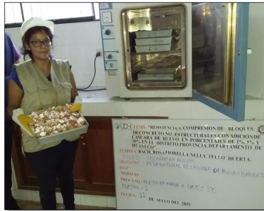
Fotografía 18 Colocación de las cáscaras de huevo sin membrana en el horno eléctrico por un período de 24 horas a una temperatura de 110°C +/-5°C
