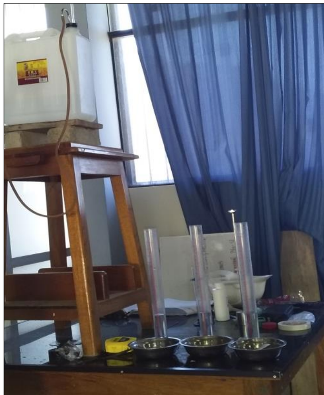
Fotografía 30 Ensayo de equivalente de arena para determinar el contenido de arcillas en las muestras del agregado global
