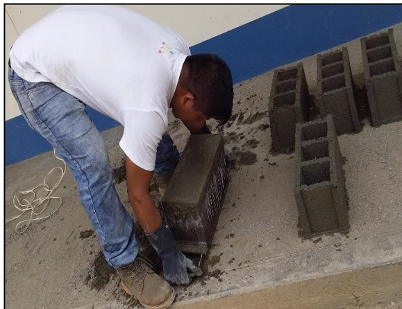
Fotografía 35 Elaboración de las unidades de albañilería en forma manual proceso de desmoldeo
