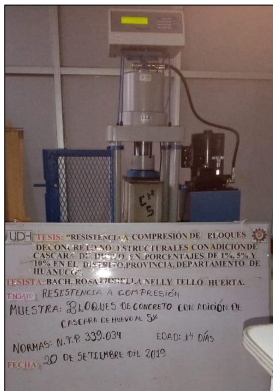
Fotografía 51 Bloques de concreto con adición de cáscara de huevo al 5% sometidos al ensayo de compresión a la edad de 14 días
