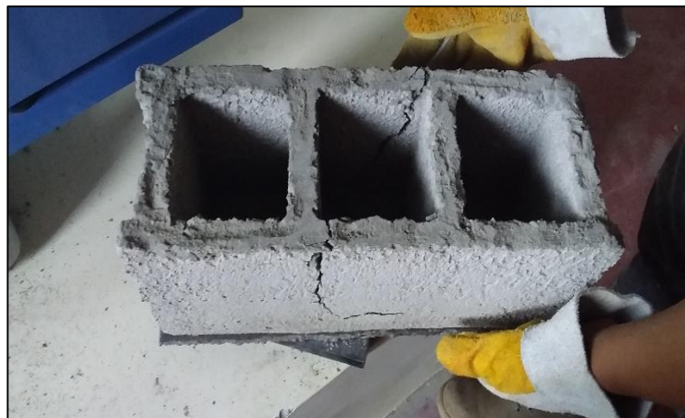
Fotografía 47 Bloques retirados después del ensayo de compresión
