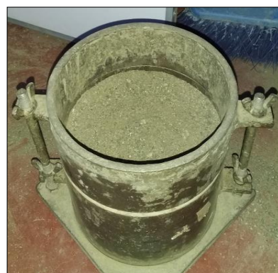
Fotografía 12 Agregado fino varillado a 2/3 de la altura del recipiente
