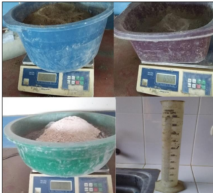
Fotografía 32 Peso de los materiales que se utilizaron para la elaboración de los bloques de concreto patrón y con adición de cáscara de huevo de acuerdo a los diseños de mezcla propuesto
