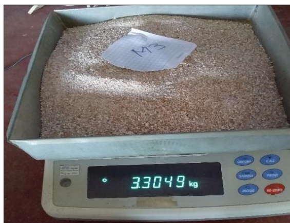
Fotografía 20 Peso de la cáscara de huevo molida antes de ser puesta nuevamente al horno eléctrico
