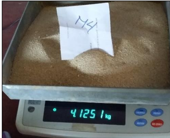
Fotografía 21 Peso de la cáscara de huevo molida después de a ver sido colocada al horno eléctrico nuevamente por un período de 24 horas a una temperatura de 275 °C donde se observa un aspecto más oscuro y una disminución en su peso
