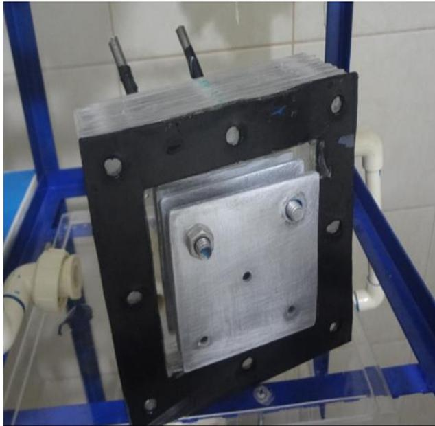
e) Los pernos con sus respectivas tuercas para la celda electroquímica
