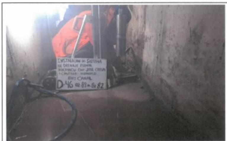
FOTO. 104.- MEDICION TESTIGO DIAMANTINA N° 46, D-46, CANAL BZ-83 AL BZ-82
