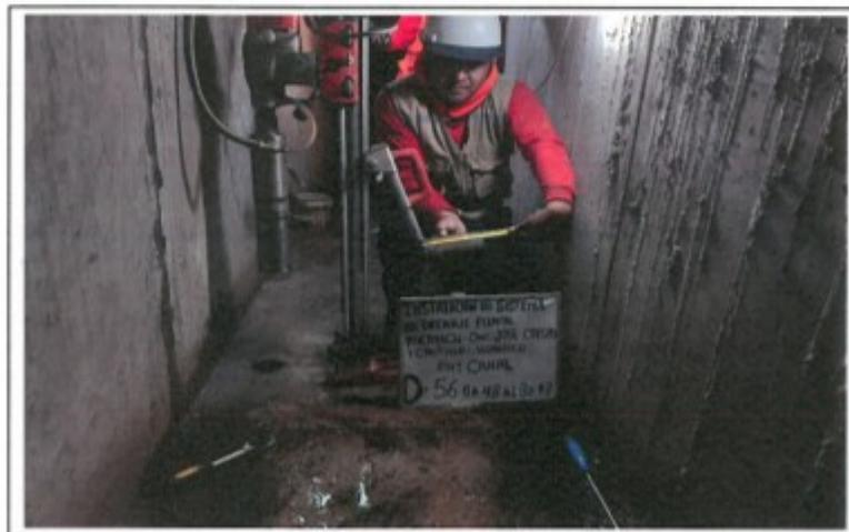
FOTO. 144.- MEDICION TESTIGO DIAMANTINA N° 56, D-56, CANAL BZ-48 AL BZ-47
