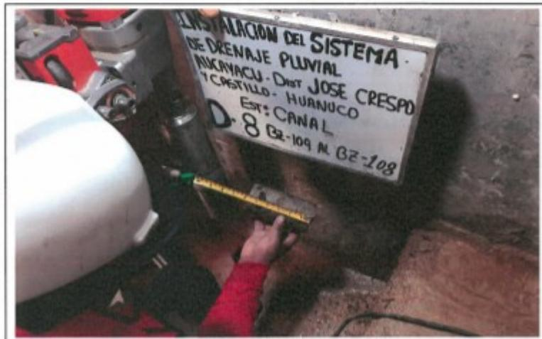
FOTO. 16.- MEDICION TESTIGO DIAMANTINA N° 08, D-8, CANAL BZ-109 AL BZ-108
