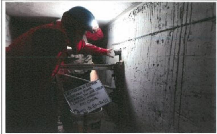
FOTO. 95.- EXTRACCION DEL TESTIGO DIAMANTINO N° 44, D-44, CANAL BZ-86 AL BZ-111
