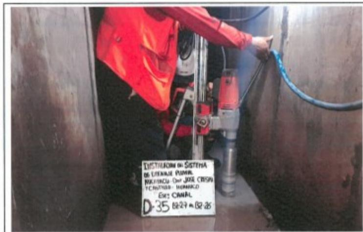
FOTO. 66.- PERFORACION DEL TESTIGO DIAMANTINO N° 35, D-35, CANAL BZ-27 AL BZ-26
