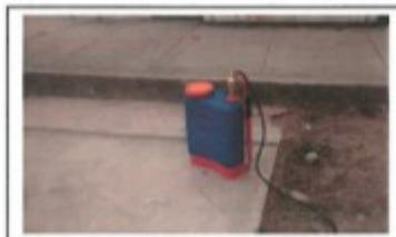
3.-Tanque de agua para la lubricación.
