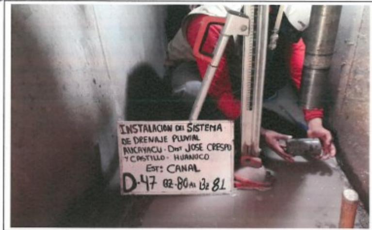
FOTO. 107.- EXTRACCION DEL TESTIGO DIAMANTINO N° 47, D-47, CANAL BZ-80 AL BZ-81
