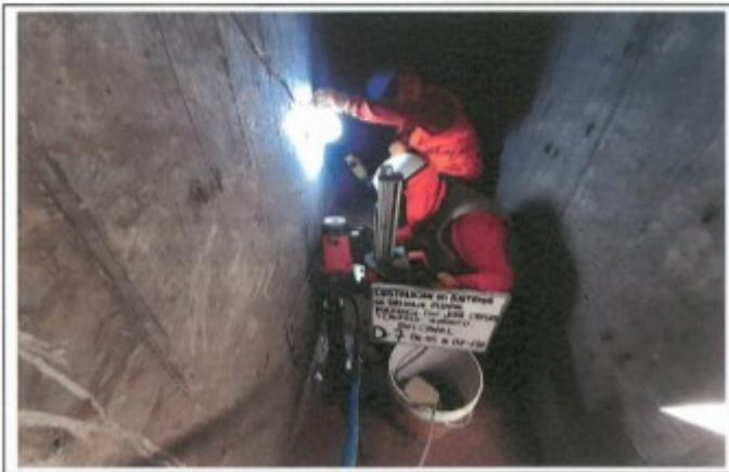
FOTO. 10.- PERFORACION DEL TESTIGO DIAMANTINO N° 07, D-7, CANAL BZ-115 AL BZ-116
