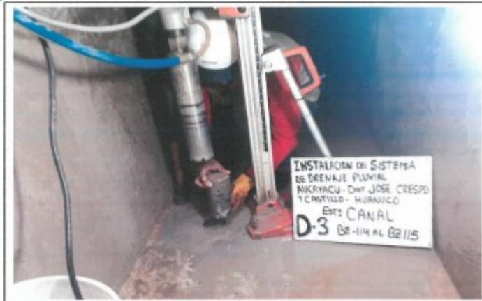
FOTO. 03.- EXTRACCION DEL TESTIGO DIAMANTINO N° 03, D-3, CANAL BZ-114 AL BZ-115
