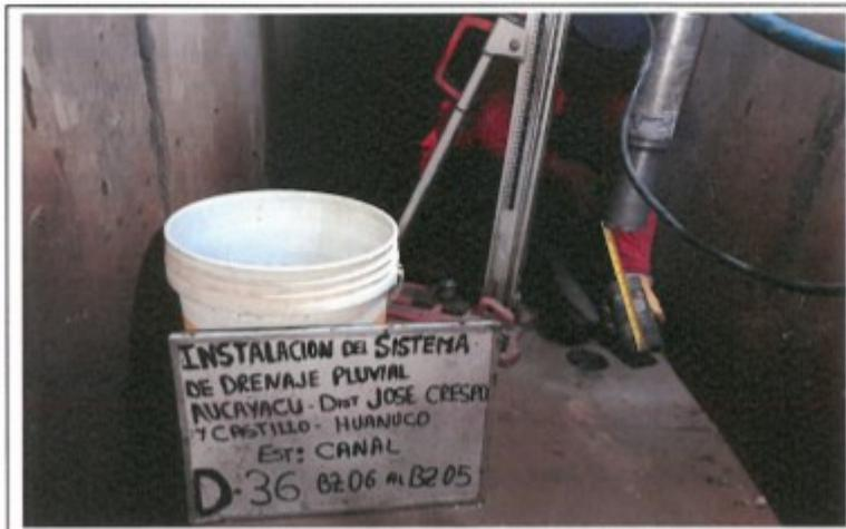
FOTO. 72.- MEDICION TESTIGO DIAMANTINA N° D-36, CANAL BZ-06 AL BZ-05
