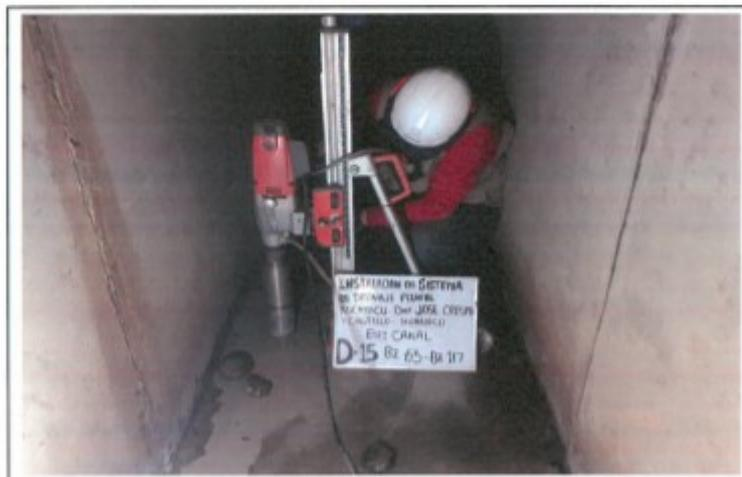
FOTO 26.- PERFORACION DEL TESTIGO DIAMANTINO N° 15, D-15, CANAL BZ-65 AL BZ-117
