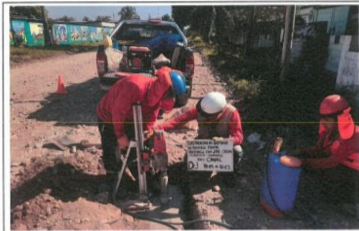
FOTO. 62.- PERFORACION DEL TESTIGO DIAMANTINO N° 32, D-32, CANAL BZZ-04 AL BZ-03
