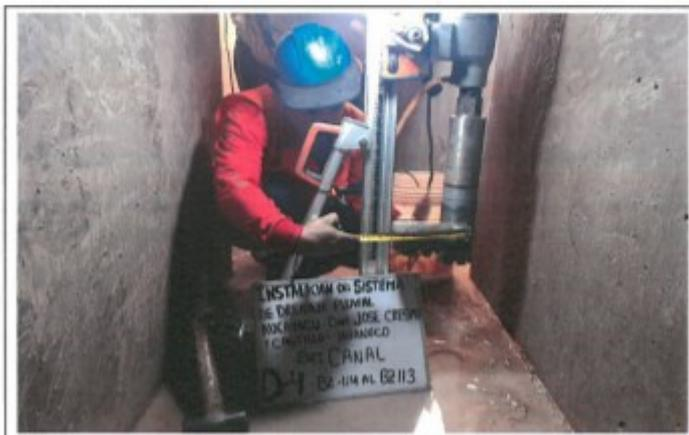
FOTO. 08.- MEDICION TESTIGO DIAMANTINA N° 04, D-4, CANAL BZ-114 AL BZ-113
