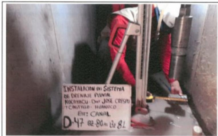
FOTO. 108.- MEDICION TESTIGO DIAMANTINA N° 47, D-47, CANAL BZ-80 AL BZ-81
