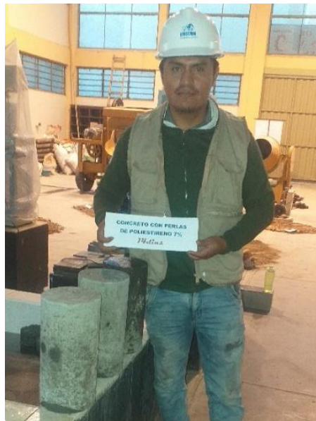
Figura 30: Concreto con 7% de perlas de poliestireno.
