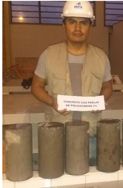
Figura 32: Concreto con 3% de perlas de poliestireno.
