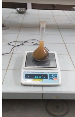
Figura 13: Peso del material en el picnómetro con agua.
