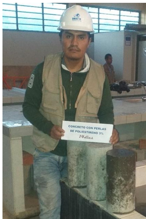
Figura 28: Concreto con 3% de perlas de poliestireno.
