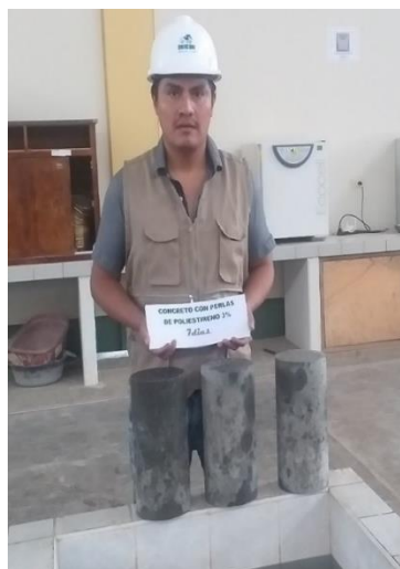
Figura 24: Concreto Con Perlas De Poliestireno - 3%
