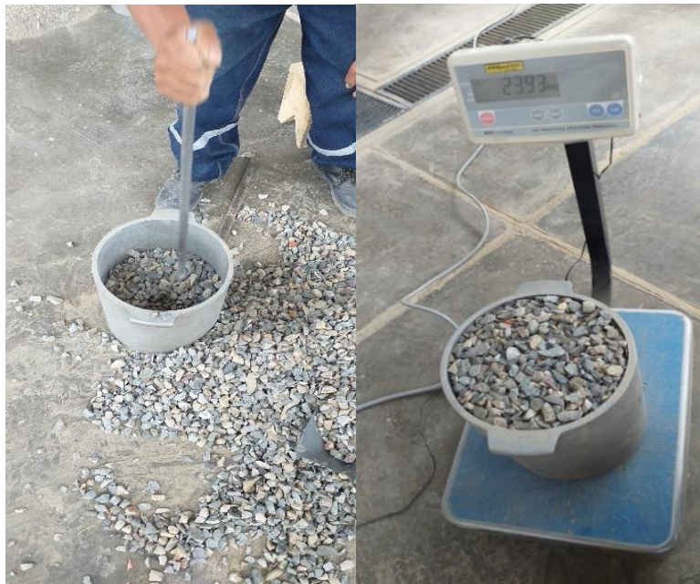
Figura 14: Peso del molde más agregado grueso.
