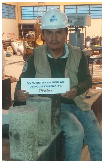
Figura 29: Concreto con 5% de perlas de poliestireno.
