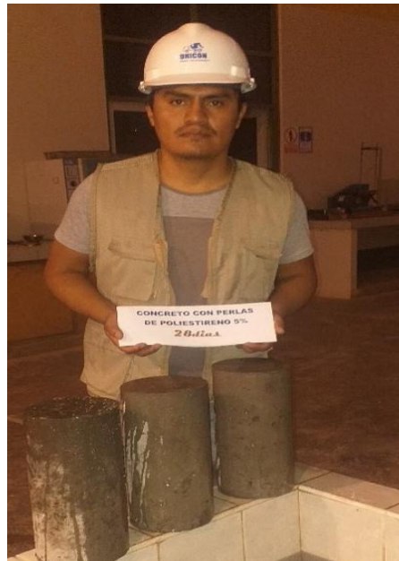
Figura 33: Concreto con 5% de perlas de poliestireno.
