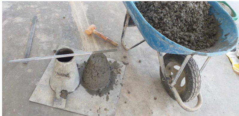
Figura 15: Muestra fuera del cono de Abrams.
