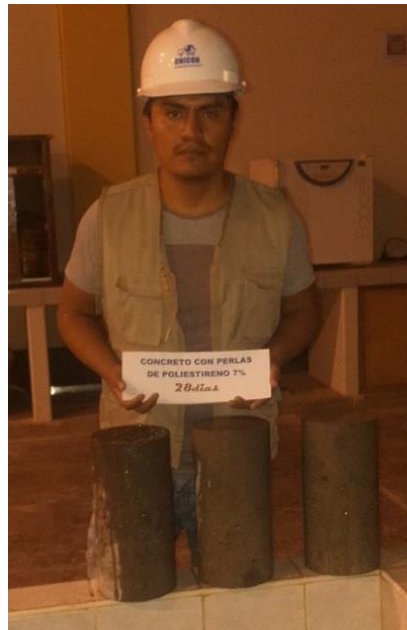
Figura 34: Concreto con 7% de perlas de poliestireno.
