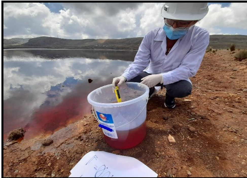
Fotografia 2: Medición del pH del agua acida de la Laguna Quiulacocha.
