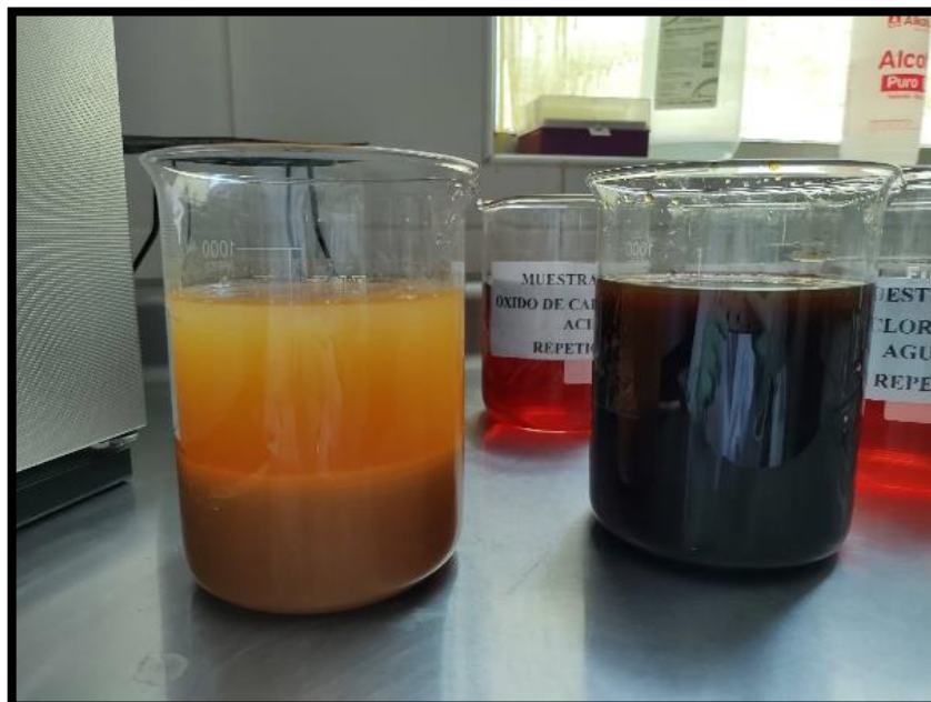
Fotografía 8: Las soluciones resultantes de Óxido de calcio y Hipoclorito de sodio antes de dejarlas reposar.
