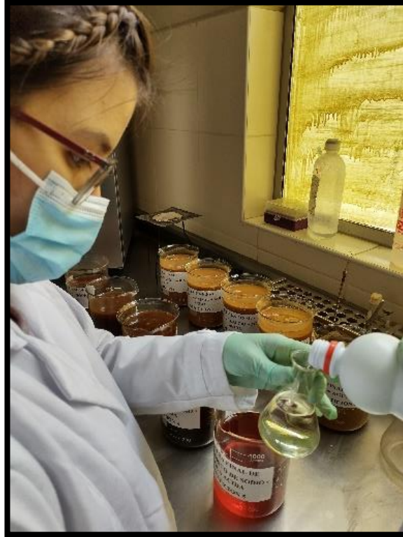
Fotografía 7: El Hipoclorito de Sodio se agrego gradualmente a cada vaso precipitado.
