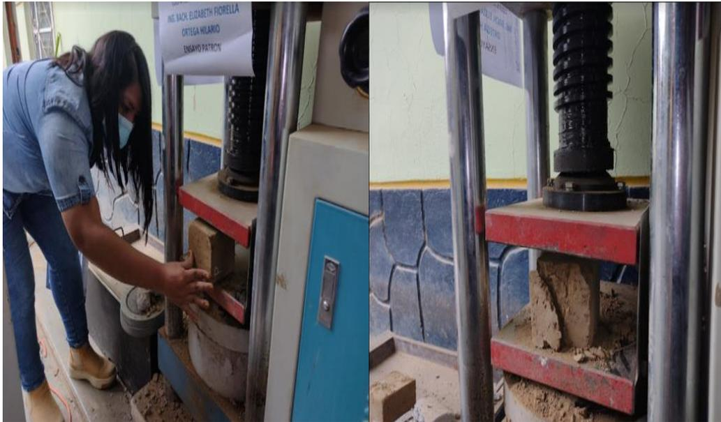
De la misma manera se realizan los ensayos de resistencia a la compresión de las muestras de arcilla adicionado con 5%, 10% y 15% de cemento.
