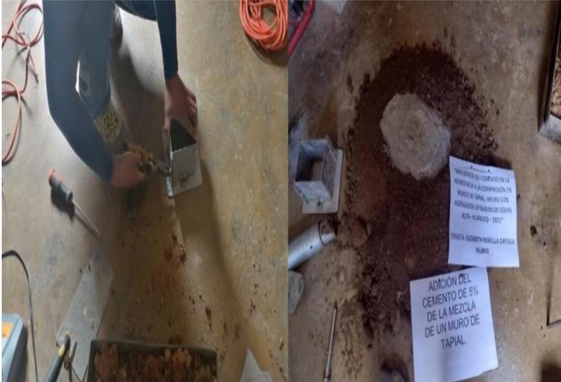
Figura: en la imagen se aprecia la adición del cemento del 10% y 15% de la mezcla de un muro de tapial.
