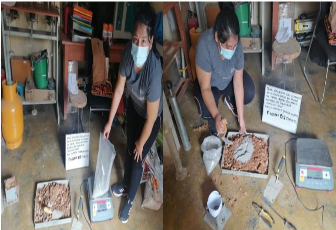
Figura: en la imagen se aprecia los bloques de tierra patrón y los bloques de tierra con adición del cemento del 5%, 10% y del 15% de la mezcla de un muro de tapial.
