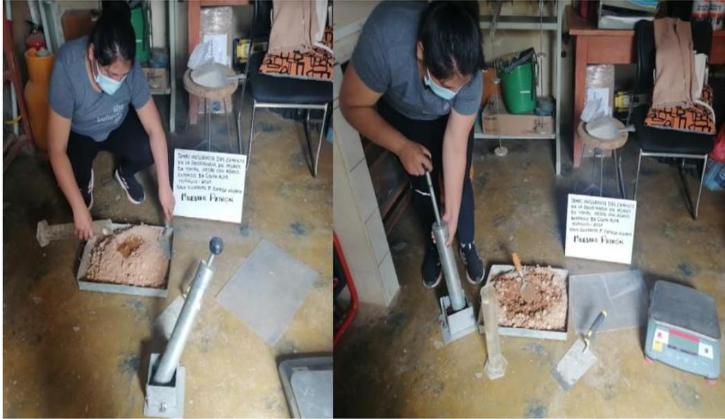
De igual forma, este proceso implica verter la arcilla mezclada con 5%, 10% y 15% de cemento en el molde para cada bloque, cada capa se va comprimiendo con golpes para suprimir el volumen de aire que contiene el bloque de tierra con adición de cemento.
