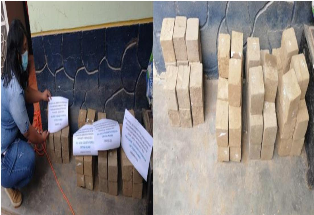
Figura: en la imagen se aprecia los ensayos de compresión del bloque de tierra de la muestra patrón y de la muestra adicionada con un 5% de cemento de un muro de tapial.
