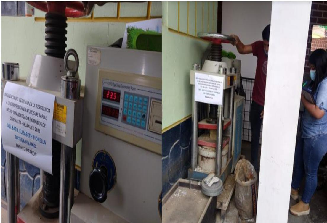
Figura: en la imagen se aprecia los ensayos de compresión del bloque de tierra de la muestra adicionada con un 10% de cemento de un muro de tapial.
