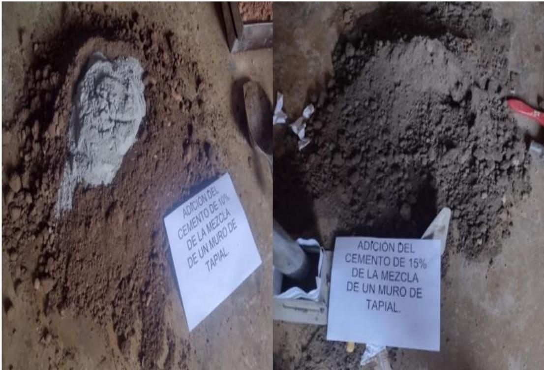
Figura: en la imagen se aprecia la elaboración del bloque de la muestra patrón y del bloque con adición del cemento del 5% de la mezcla de un muro de tapial.
