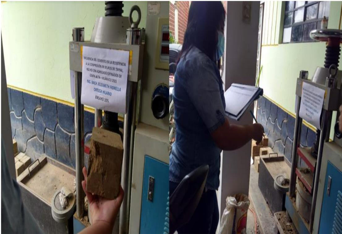
Figura: en la imagen se aprecia los ensayos de compresión del bloque de tierra de la muestra adicionada con un 15% de cemento de un muro de tapial.
