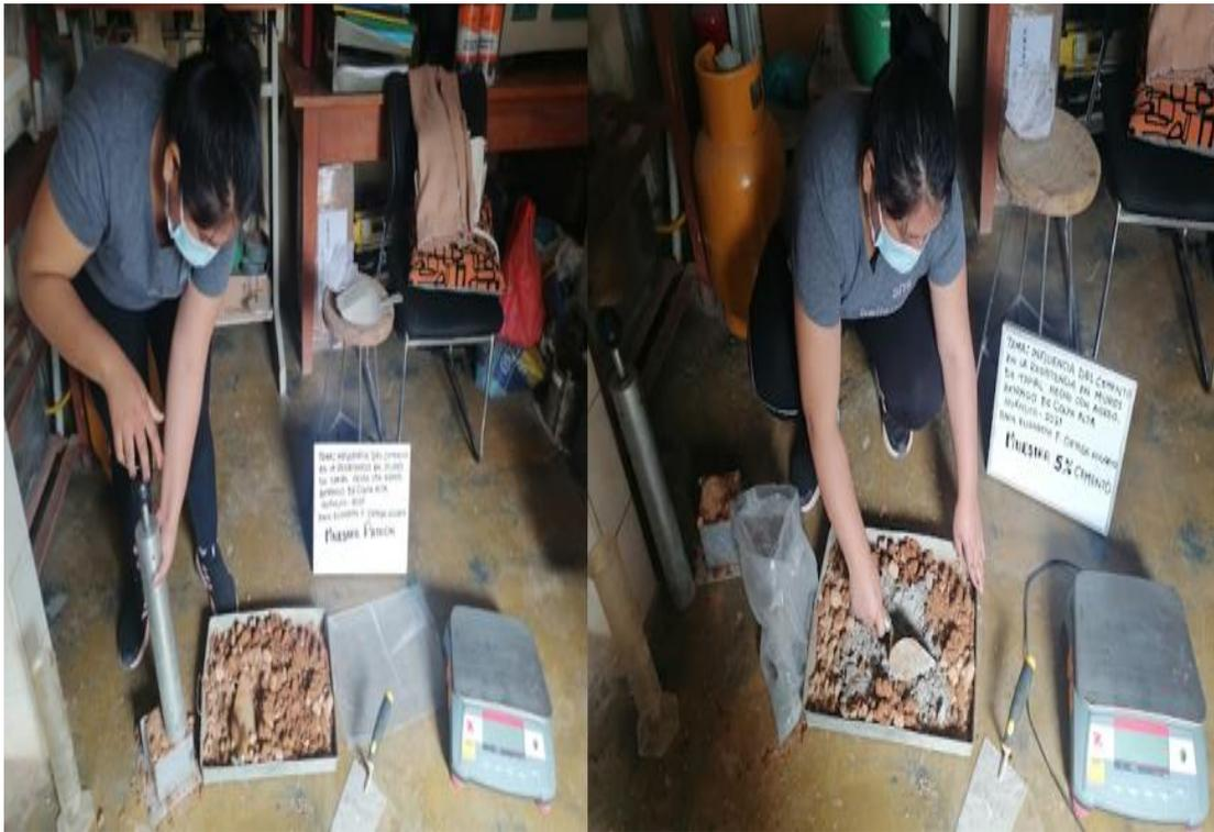
Figura: en la imagen se aprecia la elaboración del bloque de tierra con adición del cemento del 10% y del 15% de la mezcla de un muro de tapial.
