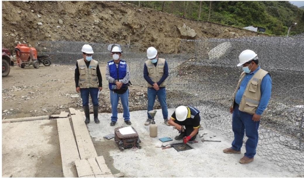
**EN LA IMAGEN SE MUESTRA EL ENSAYO DE DENSIDAD DE CAMPO**
