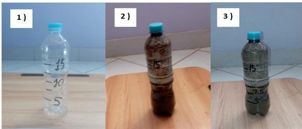
Figura 14: Pasos 1, 2 y 3 de la prueba de la botella.
