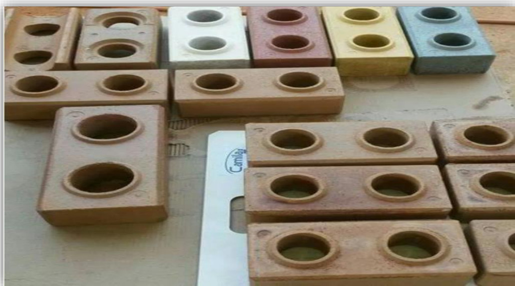
Figura 1: Ladrillos de tierra comprimida de forma biselada y orificios
