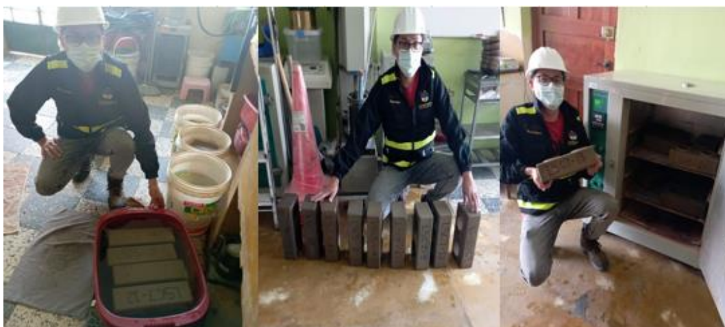
Figura 4: Humedecido, secado y secado en el horno de ladrillos suelo – cemento
