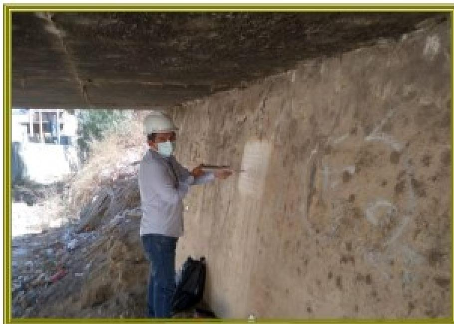
VISTA PANORÁMICA DEL ENSAYO NO DESTRUCTIVO - ESCLEROMETRO, ESTRIBO DERECHO - PUENTE AMARILIS PE-18A (CARRETERA CENTRAL)
