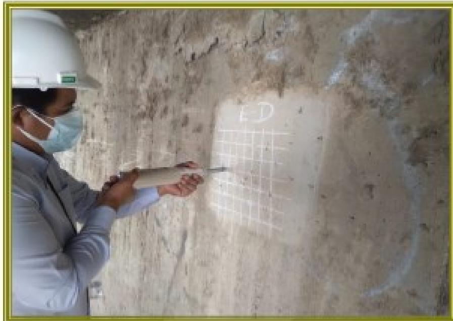
VISTA FOTOGRÁFICA DEL ENSAYO NO DESTRUCTIVO - ESCLEROMETRO, ESTRIBO DERECHO - PUENTE AMARILIS PE-18A (CARRETERA CENTRAL)
