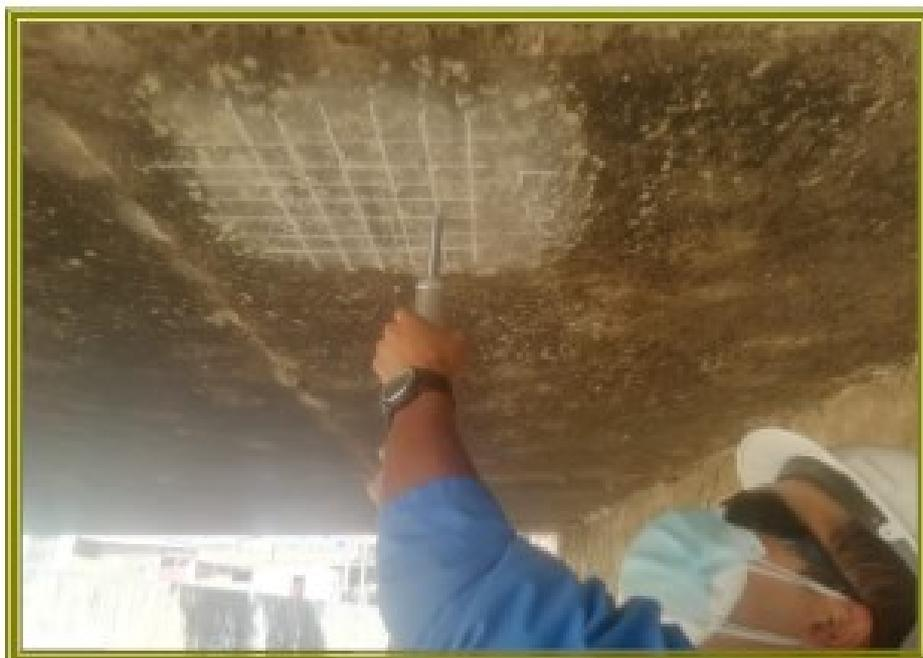
**VISTA FOTOGRAFICA DEL ENSAYO NO DESCTRUCTIVO - ESCLEROMETRO,
