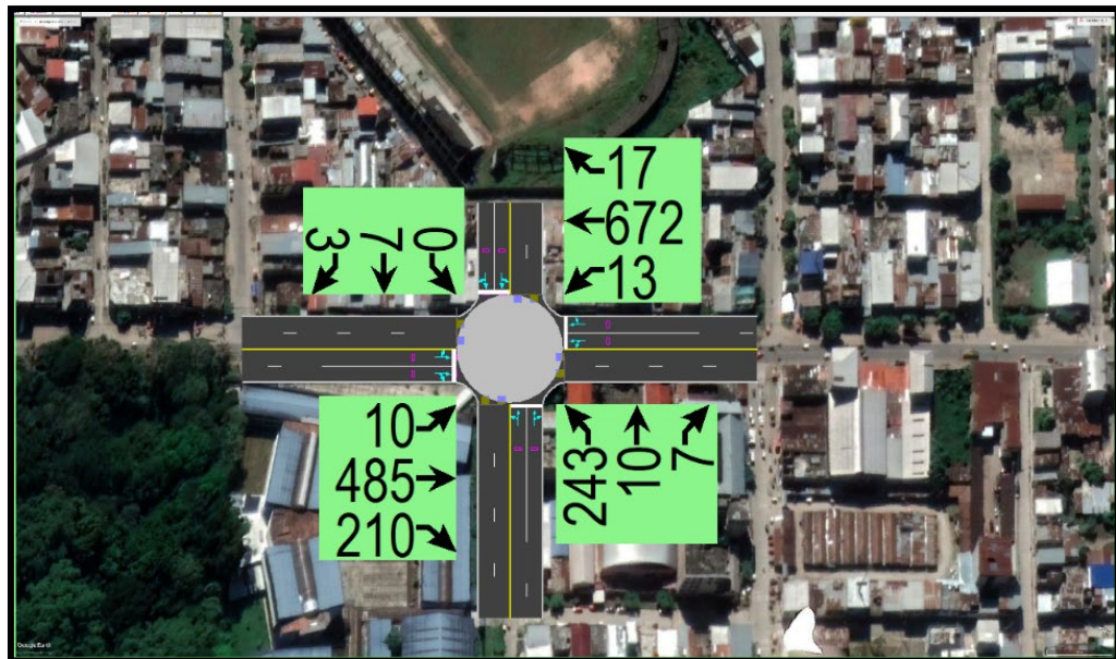
Niveles de servicio de la intersección con el aumento de carriles (norte y sur)
