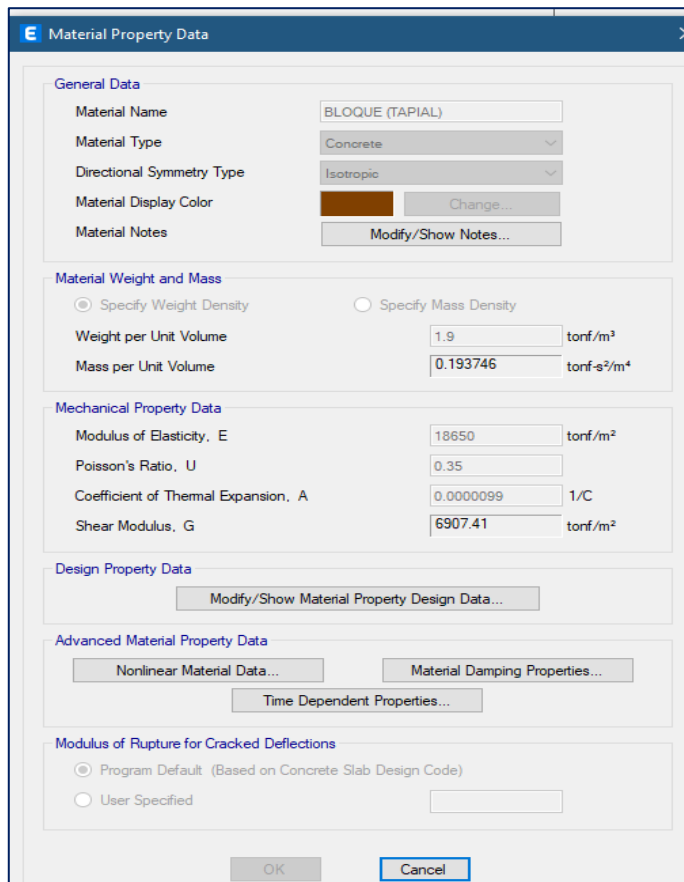
Figura 51 Definición de propiedades de tapial en Etabs V.19
