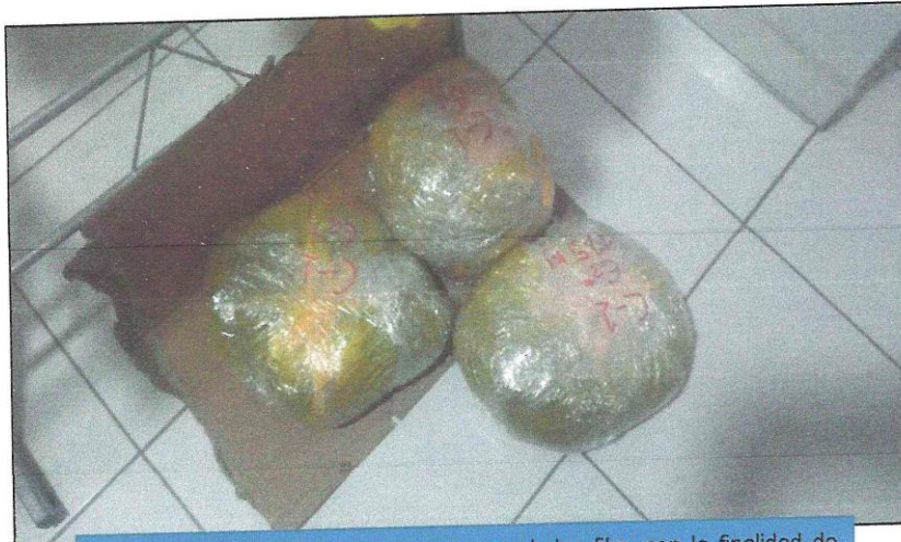
Imagen 06: Embolsado de muestras con bolsa film, con la finalidad de mantener la humedad en su estado natural.
