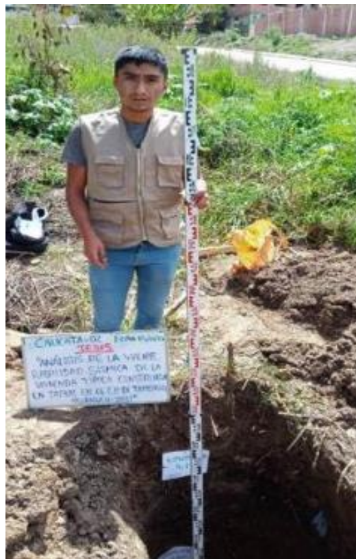
FOTOGRAFÍA N°08: Se observa la calicata C-02. La cual se realizó con la finalidad de verificar el perfil estratigráfico In-Situ. Y asimismo extraer muestras para ensayo en laboratorio de mecánica de suelos.
