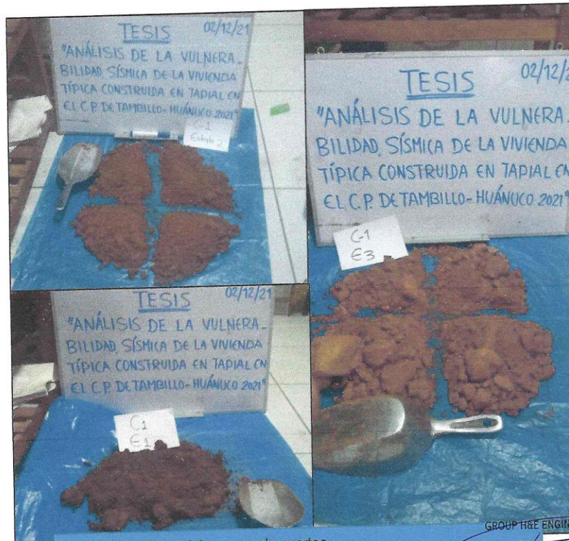
Imagen 07: Vistas del proceso de cuarteo
