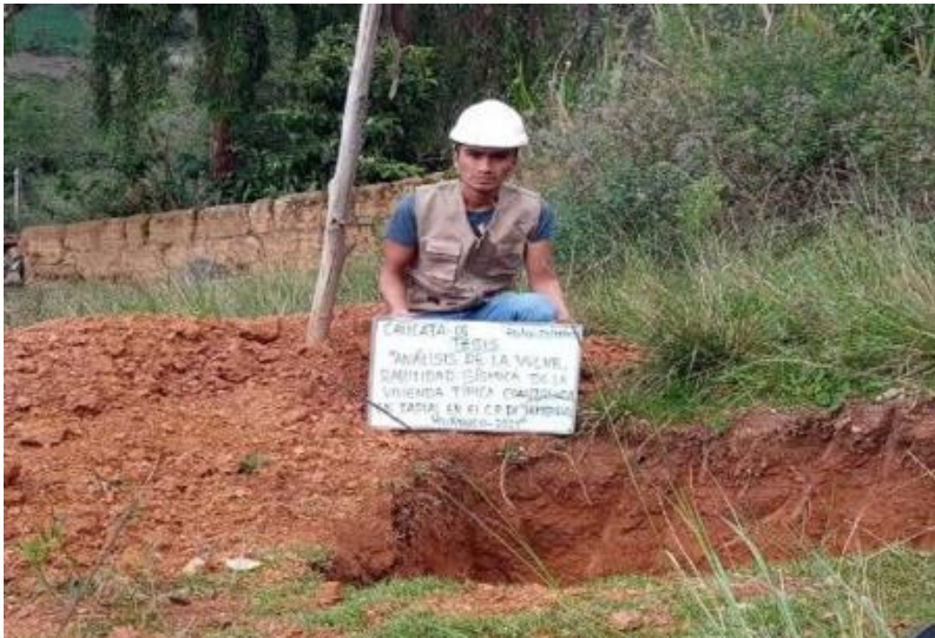
FOTOGRAFÍA N°07: Se observa la calicata C-01. La cual se realizó con la finalidad de verificar el perfil estratigráfico In-Situ. Y asimismo extraer muestras para ensayo en laboratorio de mecánica de suelos.
