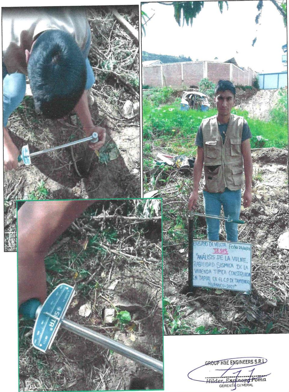
Imagen 41. Se realiza el ensayo de veleta de campo a una profundidad de 0.60 m. y la cual nos determinó el Torque; 30 N.M.
