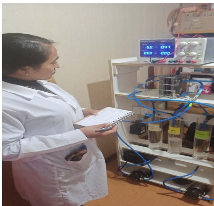
Figura 6 Operación del equipo de electrodiálisis
