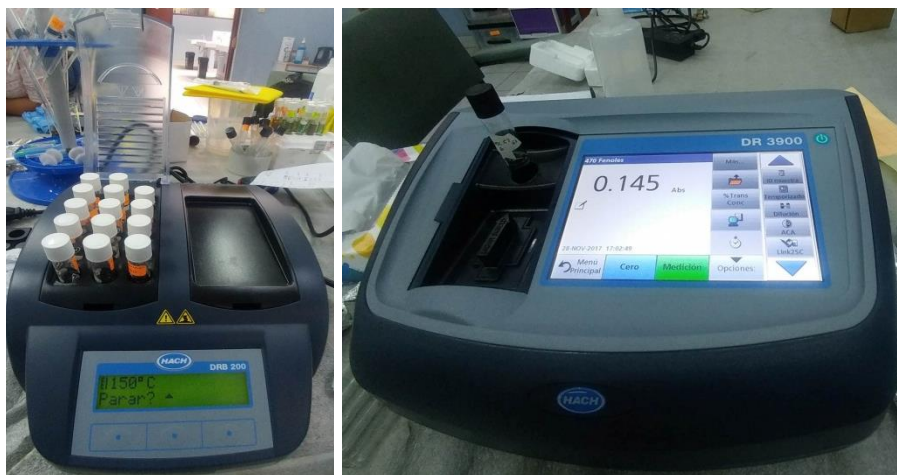
Figura 10: lado izquierdo la incubadora, donde se digesta las muestras y el lado derecho el espectrofotómetro, donde se hacen las medidas de absorbancia, transmitancia y ppm.
