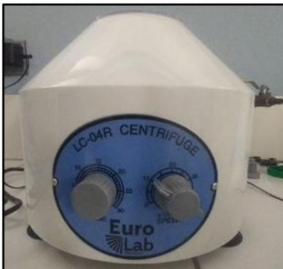
Foto 6: centrifugación de las muestras para decantar las nanopartículas
