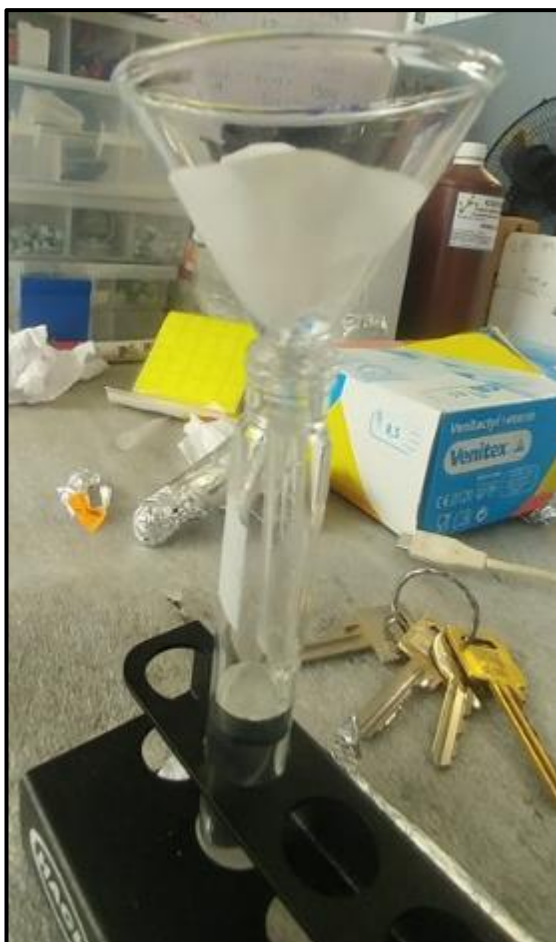
Foto 5: filtración de la muestra para retirar las partículas aglomeradas
