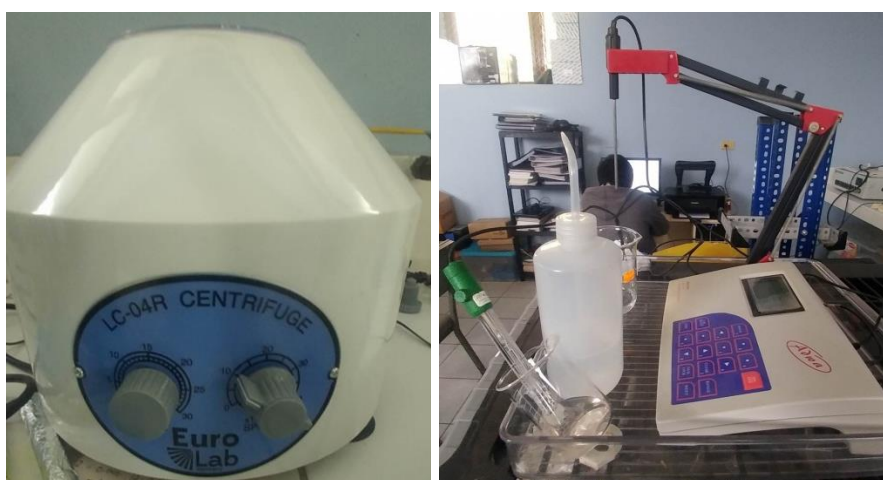
Figura 11: El lado izquierdo la centrifugadora, para decantar al \text{TiO}_2 y el lado derecho el pH-metro para medir el potencial de Hidrogeno.
