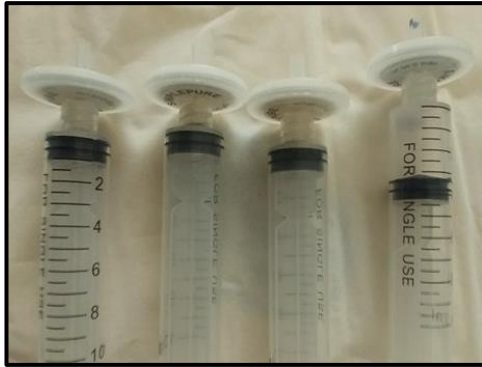
Foto 7: Filtración de a muestra por un micro filtro millipore de 0.45 \mu\text{m} .
