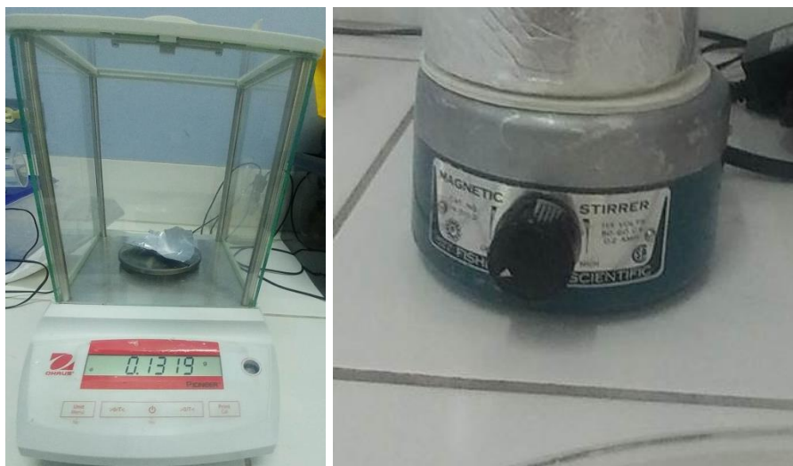
Figura 12: El lado izquierdo la balanza analítica, y el lado derecho el agitador magnético.
