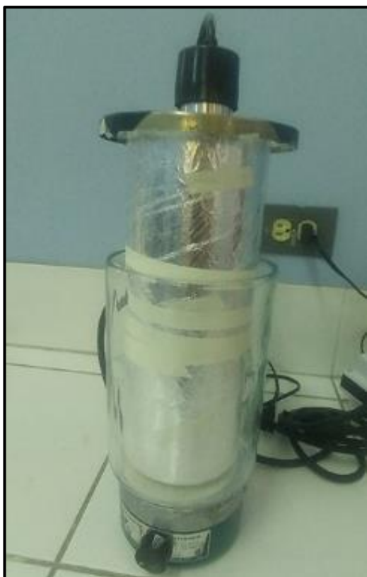
Foto 3: Fotoreactor puesto en marcha para la degradación del contaminante
