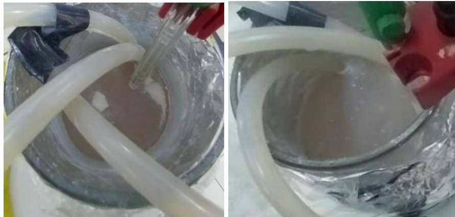
Figura 18: fotoreactor modificado conteniendo la muestra y el catalizador \text{TiO}_2 .
