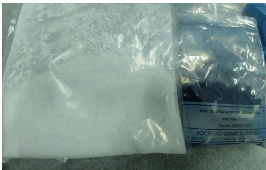
Figura 9: lado izquierdo el \text{TiO}_2 nano, el lado derecho el colorante DB199.
