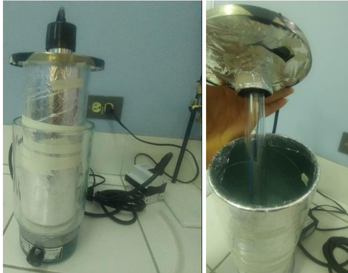
Figura 8: fotoreactor modificado para el tratamiento del fenol, tipo bach.
