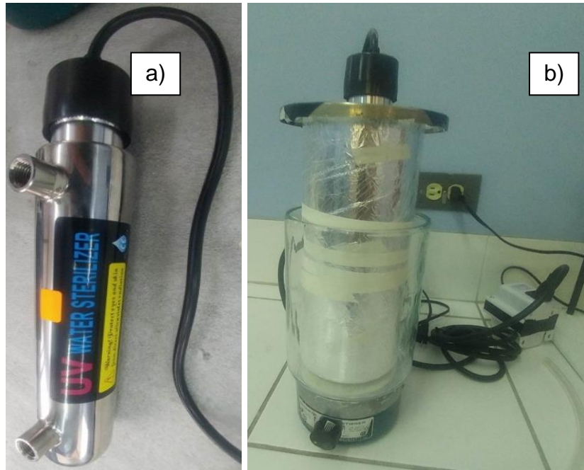
Figura 13: a) fotoreactor sin modificar; b) Fotoreactor modificado recipiente de vidrio circular de 13 cm de diámetro y 26 cm de longitud forrado con papel aluminio.
