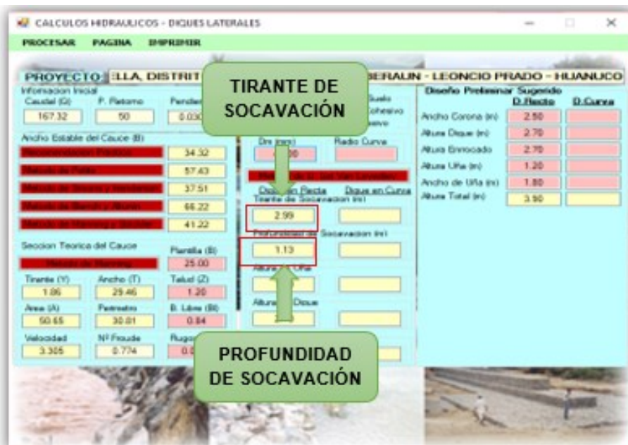
Figura 14 Tirante y profundidad de socavación
