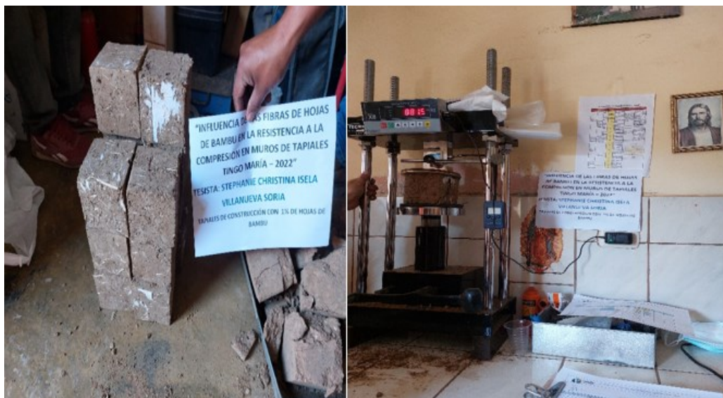
Figura 10 Ensayos de resistencia a la compresión de los bloques de tapial con 1 %, 3 % y 5 % de hoja de bambú
