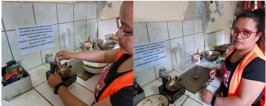
Figura 7 Ensayos de límite plástico y límite líquido
