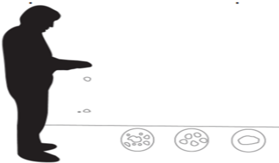
Figura 3 Prueba de contenido de humedad de la mezcla
